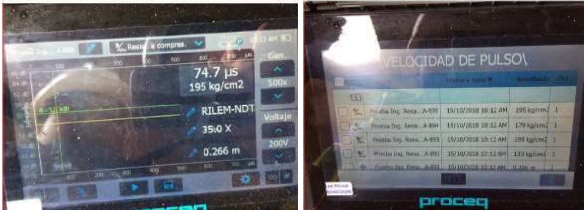
Figura 56 - Ensayo de ultra sonido y resistencia a la compresión PUNDIT y almacenamiento de datos
