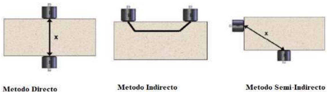
Figura 18 - Método de mediciones del equipo Pundit Ultra Sonido
