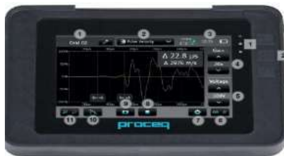
Figura 17 - Equipo para el cálculo de la velocidad de pulso y la resistencia a la compresión
