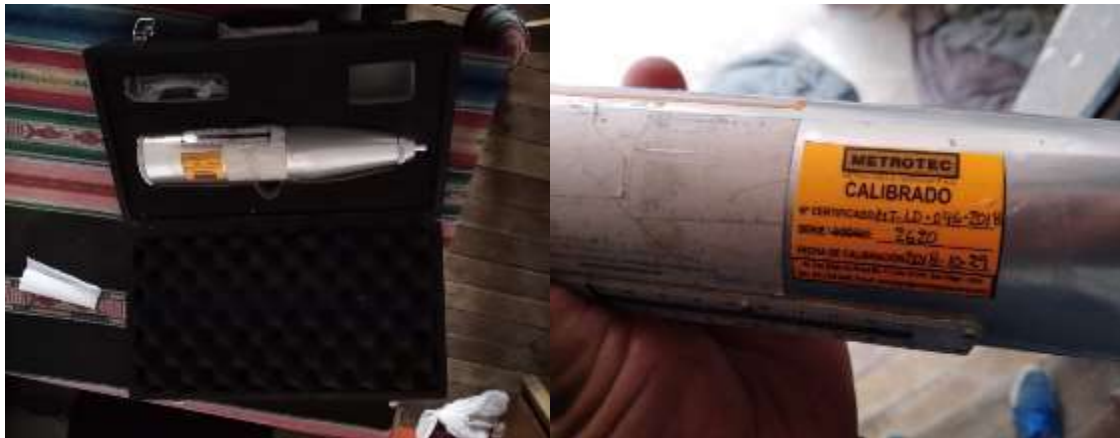
Figura 21 - Esclerómetro a usar en los ensayos calibrado
