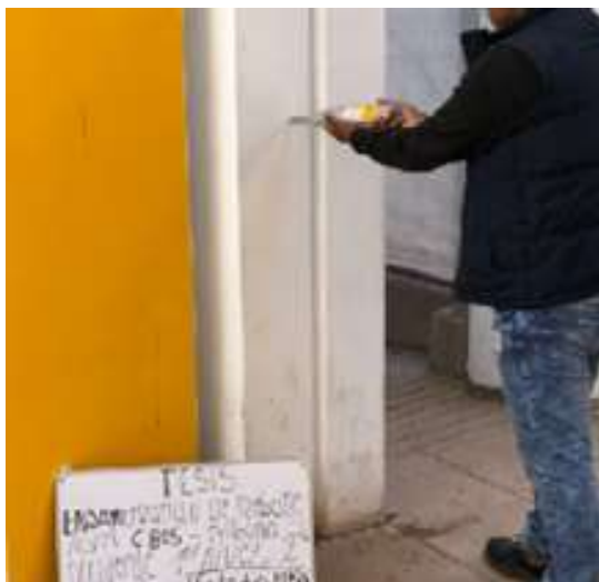
Figura 26 - Ensayo esclerómetro interior-exterior en columnas primer nivel de la tribuna occidente de los anillos del estadio Inca Garcilaso de la Vega
