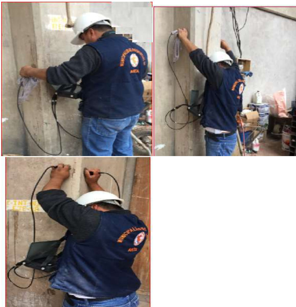
Figura 42 - Ensayo Ultra sonido- resistencia a la compresión Pundit PL interior-exterior en vigas del Primer nivel de la tribuna Occidente de los anillos del estadio Inca Garcilaso de la Vega
