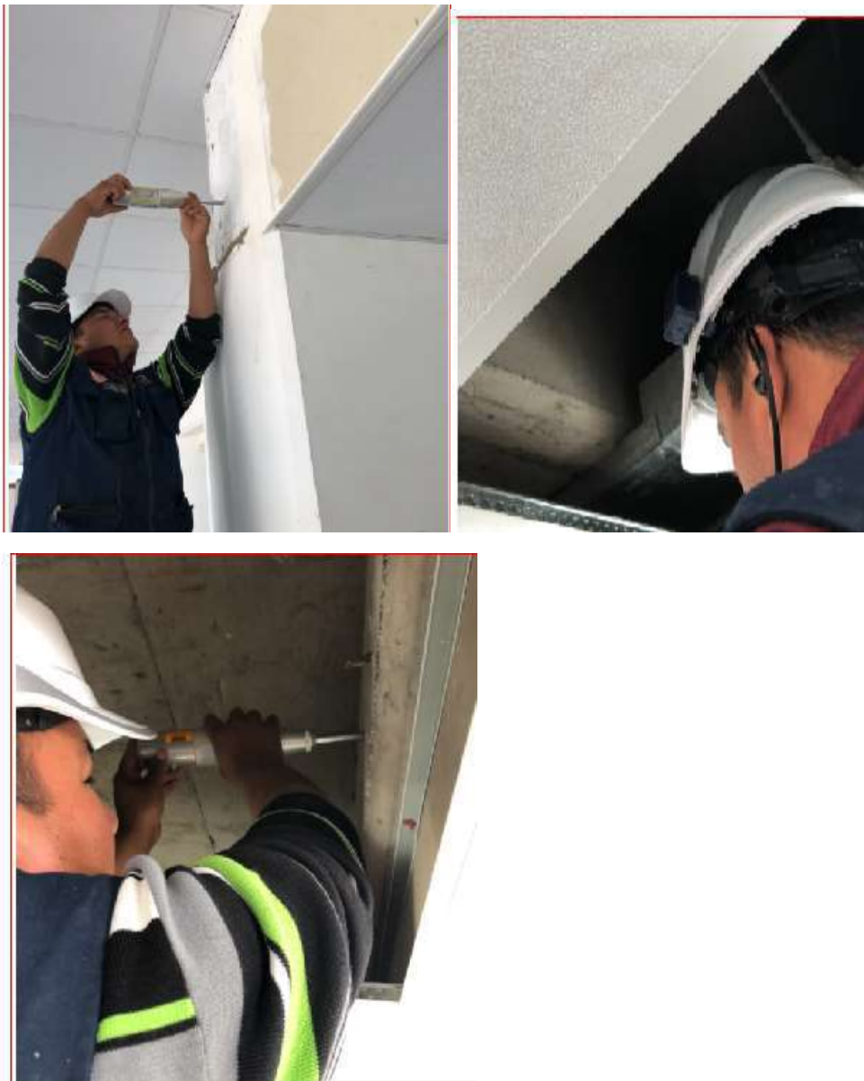
Figura 36 - Ensayo esclerómetro interior-externo en vigas del segundo nivel de la tribuna Occidente de los anillos del estadio Inca Garcilaso de la Vega
