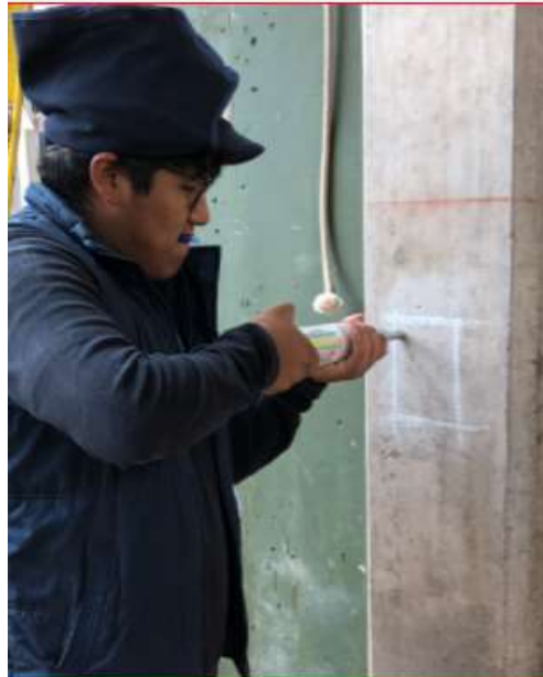
Figura 25 - Ensayo esclerómetro interior-exterior en columnas cuarto nivel de la tribuna oriente de los anillos del estadio Inca Garcilaso de la Vega
