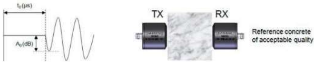
Figura 16 - Análisis de amplitud en la superficie de un concreto
