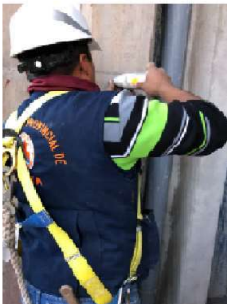
Figura 25 - Ensayo esclerómetro interior-exterior en columnas cuarto nivel de la tribuna oriente de los anillos del estadio Inca Garcilaso de la Vega
