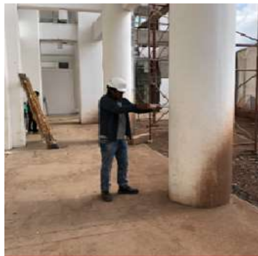
Figura 26 - Ensayo esclerómetro interior-exterior en columnas primer nivel de la tribuna occidente de los anillos del estadio Inca Garcilaso de la Vega
