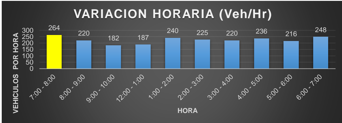
Figura 30: Variación horaria vía Evitamiento entrada (Agua Buena – calle Hilario Mendivil) Sentido Sur - Este
