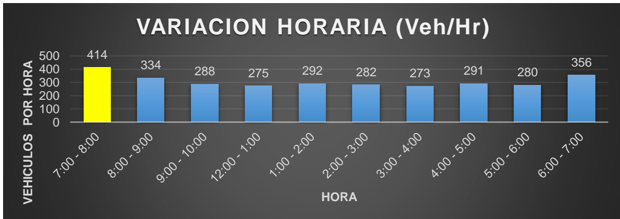
Figura 26: Variación horaria vía Evitamiento entrada (Agua Buena – calle Hilario Mendivil) Sentido Este - Sur
