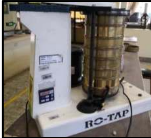
Figura N° 65: Colocación del agregado dentro del juego de tamices en la maquina tamizadora
