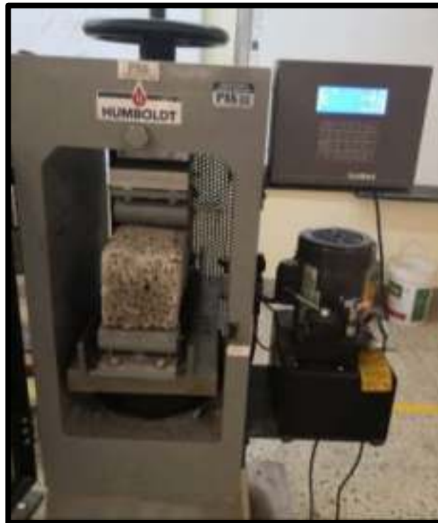
Figura N° 85: Colocación del espécimen de concreto permeable para ensayo de resistencia a flexión
