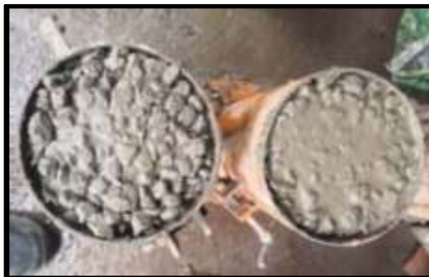
Figura N° 75: Vertido del concreto en moldes cilíndricos
