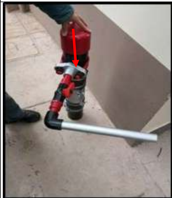
Figura N° 50: Permeámetro de carga variable
