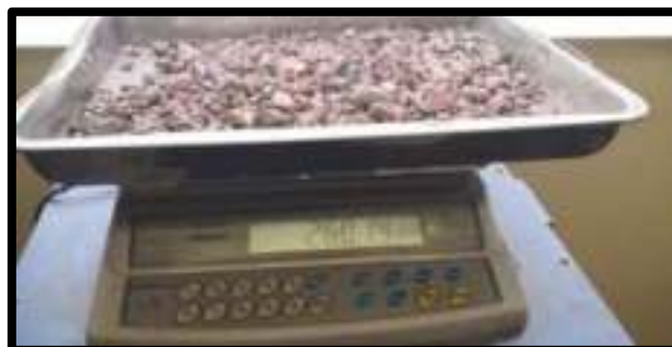
Figura N° 63: Determinación del peso del agregado posterior a su lavado
