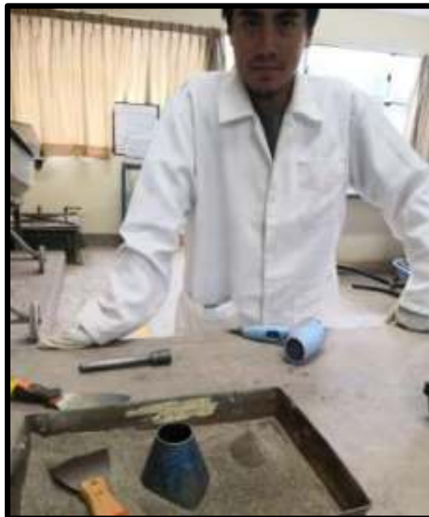
Figura N° 70: Proceso de obtención del estado Saturado Superficialmente Seco del agregado fino
