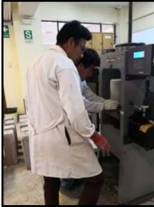
Figura N° 81: Colocación de especímenes para ensayo de resistencia a compresión
