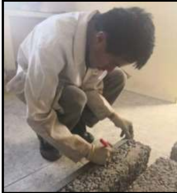
Figura N° 83: Medición y marcado de los puntos de apoyo de las vigas para ensayo de resistencia a flexión
