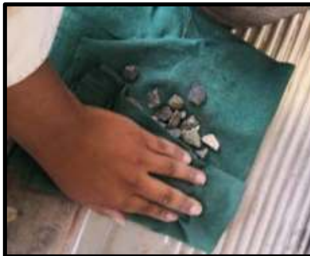
Figura N° 68: Secado del agregado saturado con franela hasta llegar a su estado Saturado Superficialmente Seco
