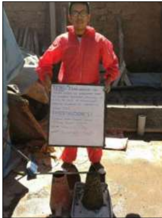
Figura N° 88: Ensayo de Revenimiento del Concreto Permeable
