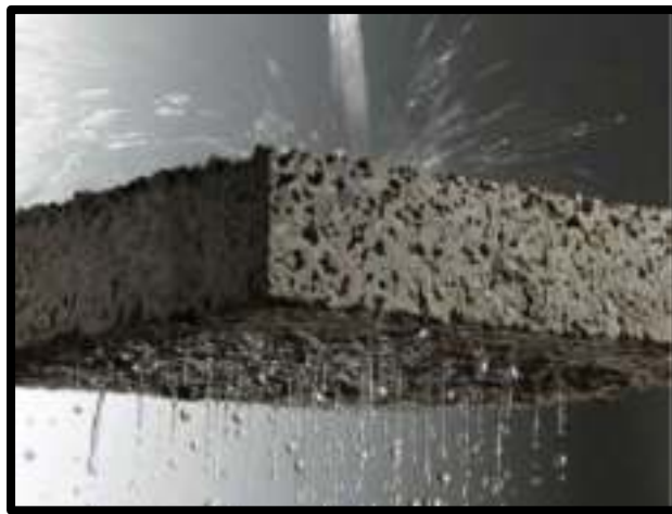
Figura N° 8: Paso de agua a través de concreto permeable
