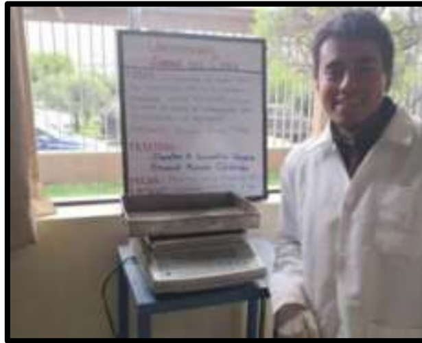
Figura N° 69: Proceso de ensayo de peso específico del agregado grueso
