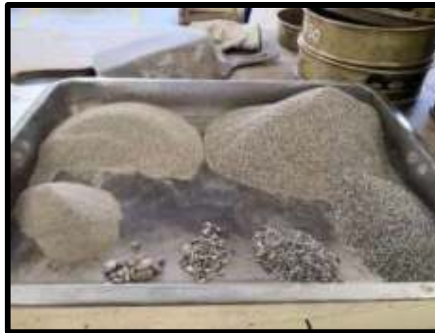
Figura N° 66: Muestras separadas de acuerdo a la malla de retención del juego de tamices
