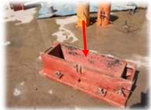
Figura N° 48: Molde prismático de 15 cm x 15 cm de sección y 50 cm de largo
