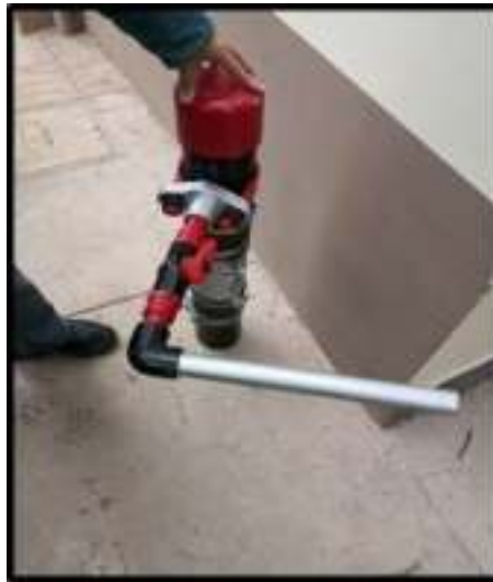
Figura N° 86: Permeámetro y muestras de concreto permeable ensayadas para obtención del coeficiente de permeabilidad
