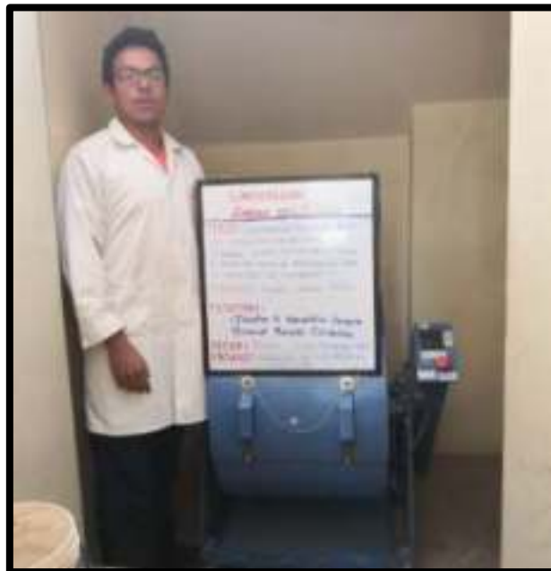
Figura N° 67: Ensayo de resistencia a la abrasión mediante la máquina de los Ángeles
