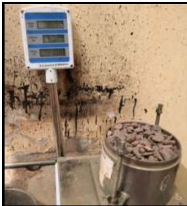
Figura N° 72: Obtención del peso volumétrico del agregado grueso
