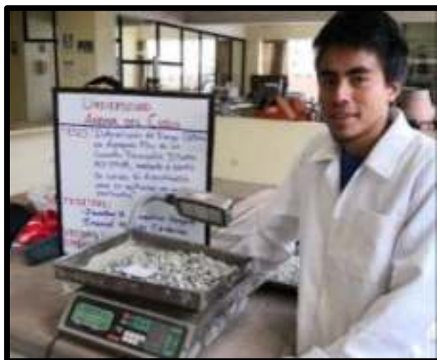
Figura N° 61: Determinación del contenido de humedad evaporable por secado de los agregados
