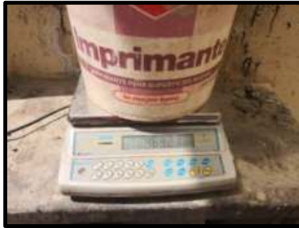
Figura N° 79: Peso del agua desplazada por la muestra de concreto permeable para determinación de vacíos
