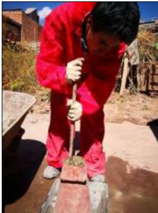
Figura N° 87: Proceso de ensayo de revenimiento del concreto permeable
