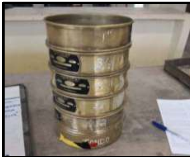
Figura N° 64: Juego de tamices para ensayo de granulometría
