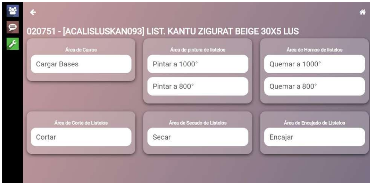
Ilustración 38. Interfaz que muestra las ordenes de trabajo agrupadas por centro de producción, mostradas al escanear una ficha de producción
