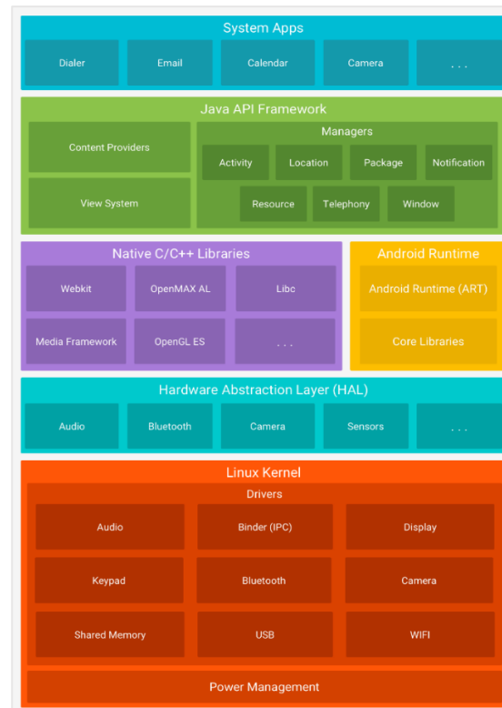
Figura 1. Pila de software de Android.
