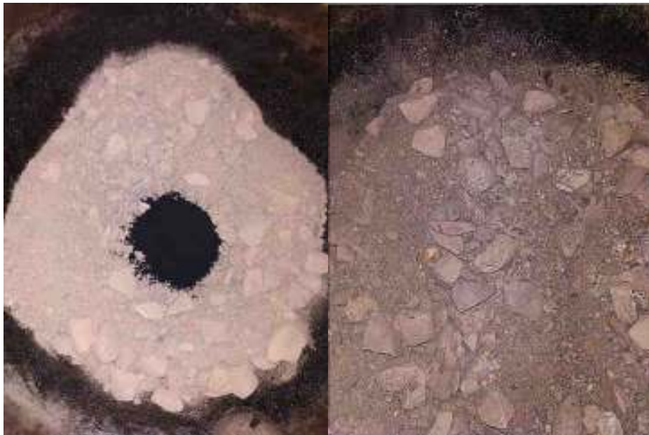
Figura 112. Dispersión homogénea de los Nanotubos de Carbono con los agregados.
