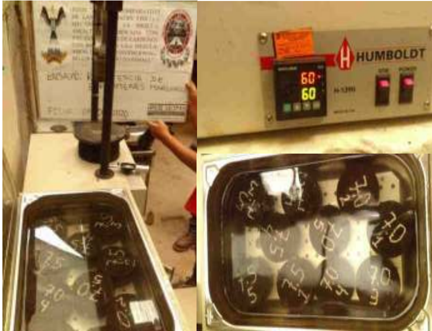
Figura 102. Sumersión de todos los especímenes asfálticos en baño María a una temperatura de 60°C. Fuente: Elaboración propia
