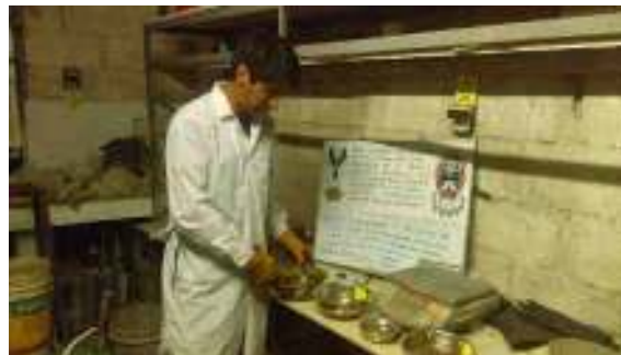
Figura 28. Repetir el proceso de inmersión y secado hasta que se obtenga el número de ciclos requeridos. Fuente: Elaboración propia
