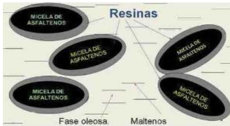
Figura 4. Estructura coloidal del asfalto.
