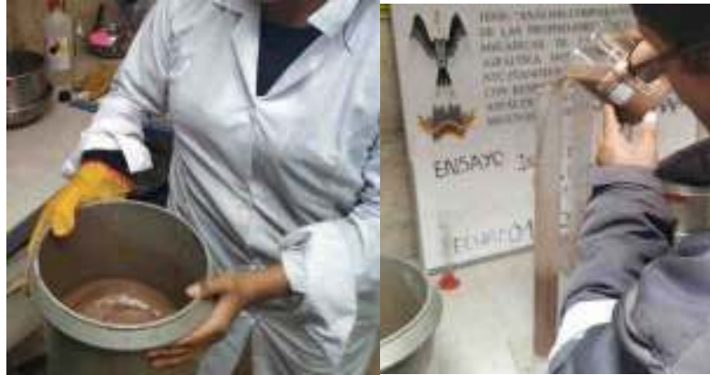
Figura 41. Agitación y vertido en la probeta del agua de lavado.
