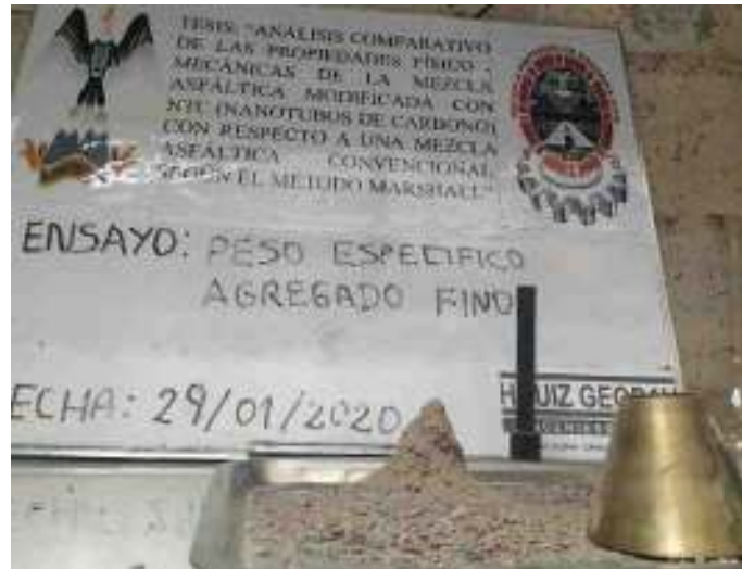
Figura 65. El cono de agregado se derrumba al retirar el molde lo que indica que está en estado de Superficie Seca. Fuente: Elaboración propia
