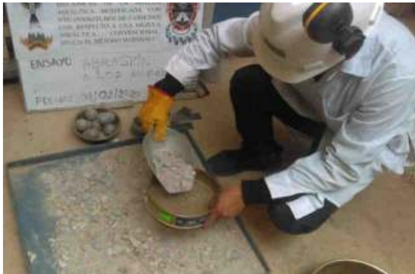
Figura 35. Tamizaje del agregado ensayado por la malla N° 12 para posterior pesaje.
