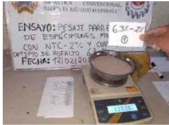
Figura 106. Pesaje de los agregados con contenido óptimo de Asfalto y 2% de Nanotubos de Carbono. Fuente: Elaboración propia
