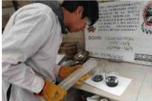
Figura 37. El agregado revestido de asfalto es cubierto con agua destilada.
