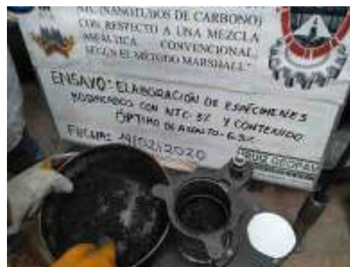
Figura 114. Colocación de la mezcla en la briqueta Marshall
