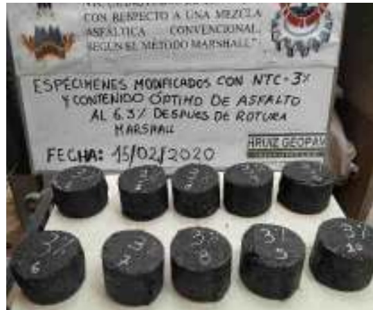
Figura 123. Evaluación de especímenes modificados con NTC - 3% y contenido de Asfalto 6.3% tras rotura Marshall. Fuente: Elaboración propia
