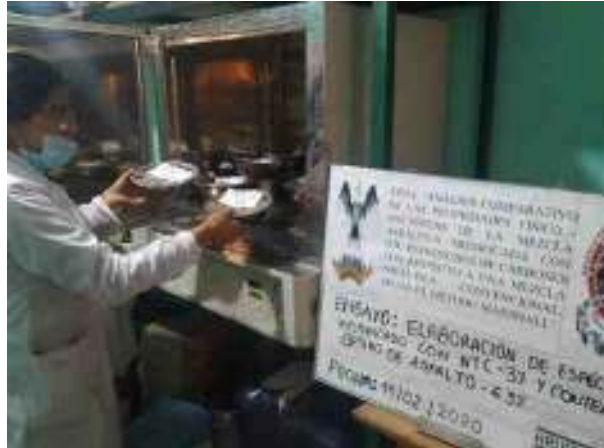
Figura 109. El agregado como el cemento asfáltico previamente pesado son calentados en el horno. Fuente: Elaboración propia
