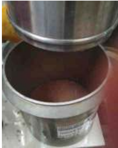
Figura 44. Agregado fino después de ser agitado por 2 minutos.
