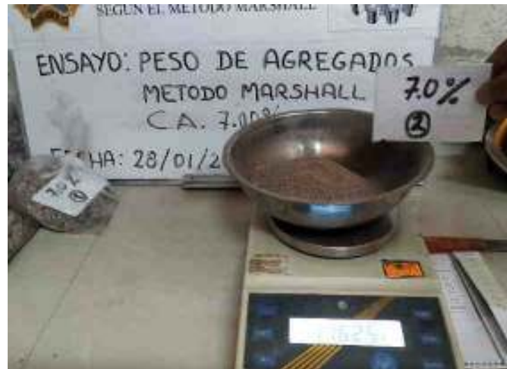
Figura 94. Pesaje de la combinación de agregados con 7.0% de contenido de asfalto.
