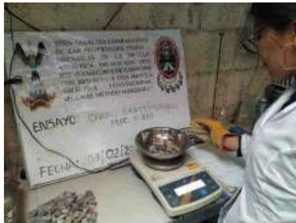
Figura 53. Peso de los grupos clasificados según el tipo de caras fracturadas
