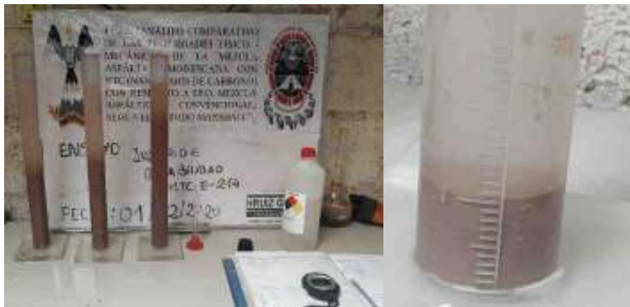
Figura 43. Reposo de las probetas tras agitación y posterior lectura de la altura de sedimentación. Fuente: Elaboración propia
