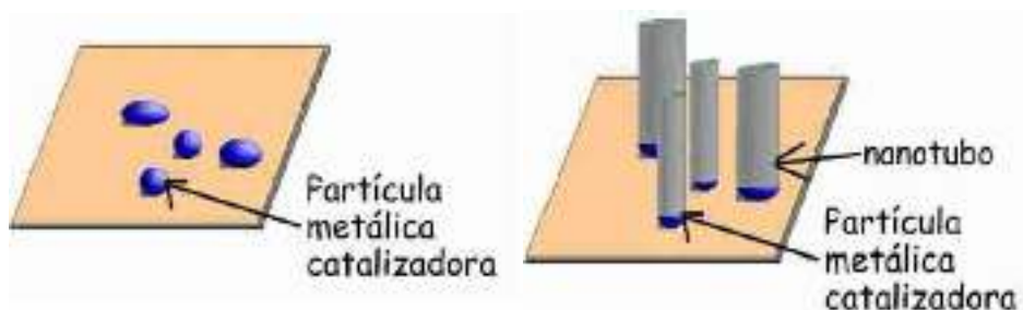
Figura 14. Partícula metálica catalizadora que forma nanotubo
