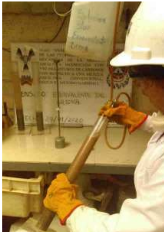
Figura 71. Vertimos la Solución Stock de Cloruro de Calcio a las probetas con el sifón.
