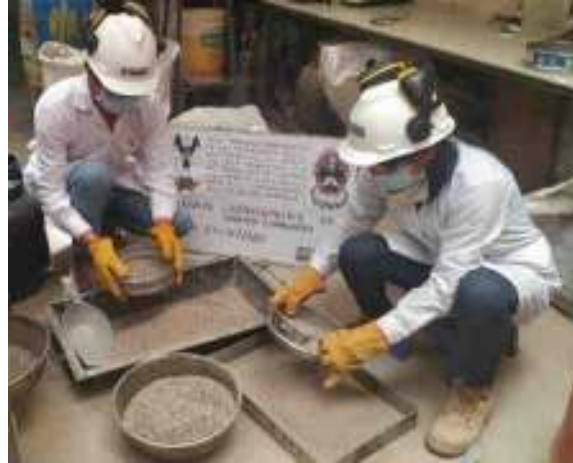
Figura 24. Continuar el tamizado sosteniendo el tamiz ligeramente inclinado.
