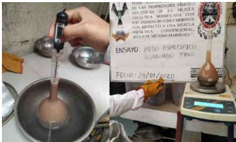
Figura 68. Ajustamos la temperatura de la fiola a 23°C para registrar el peso
