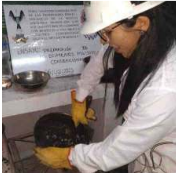
Figura 98. Mezcla de los agregados y el cemento asfáltico en estufa para mantener temperatura caliente. Fuente: Elaboración propia
