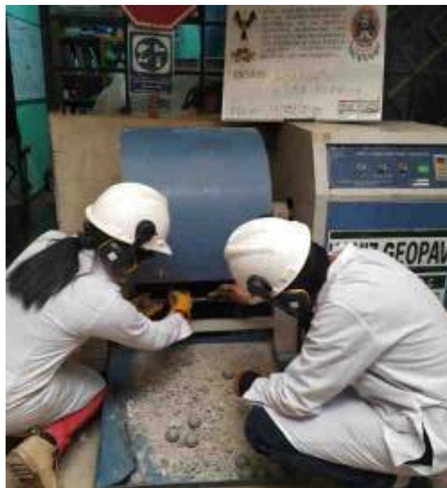
Figura 34. Procedimiento del retiro del agregado de la Máquina de los Ángeles.
