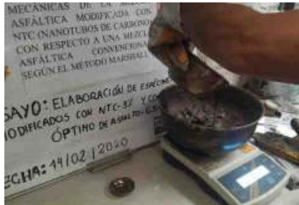
Figura 113. Se agrega el cemento asfáltico para su posterior mezclado en caliente.
