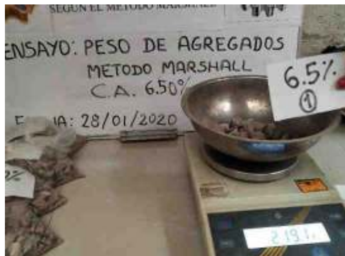
Figura 93. Pesaje de la combinación de agregados con 6.5% de contenido de asfalto.
