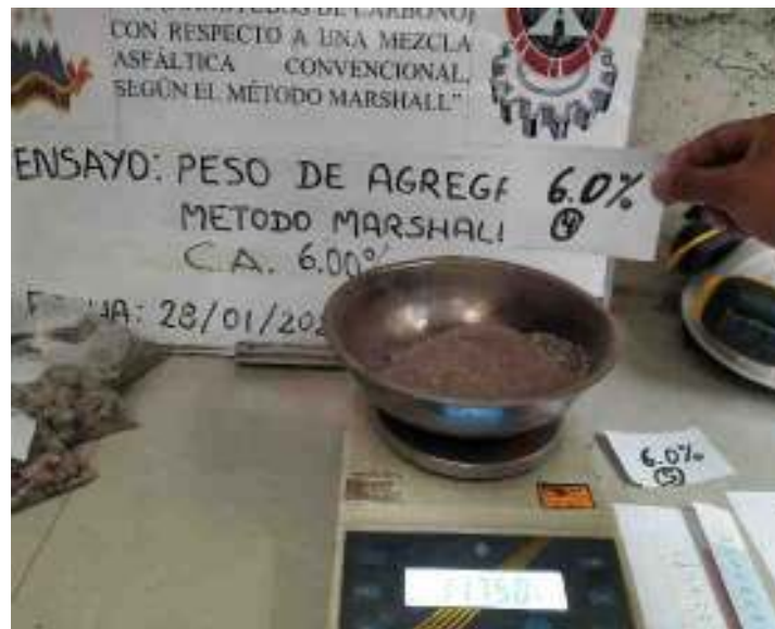
Figura 92. Pesaje de la combinación de agregados con 6.0% de contenido de asfalto.
