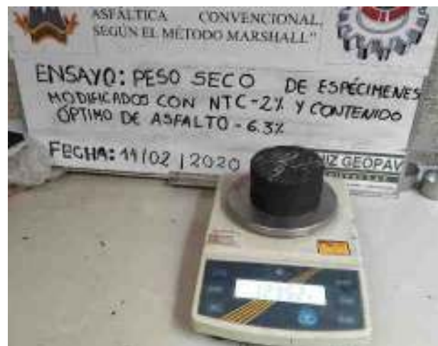
Figura 117. Pesaje en seco de Especímenes Marshall convencionales y modificados.
