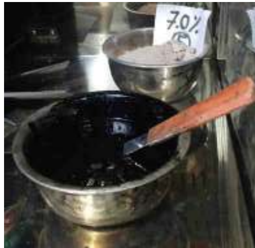
Figura 96. El agregado así como el cemento asfáltico es calentado en el horno.
