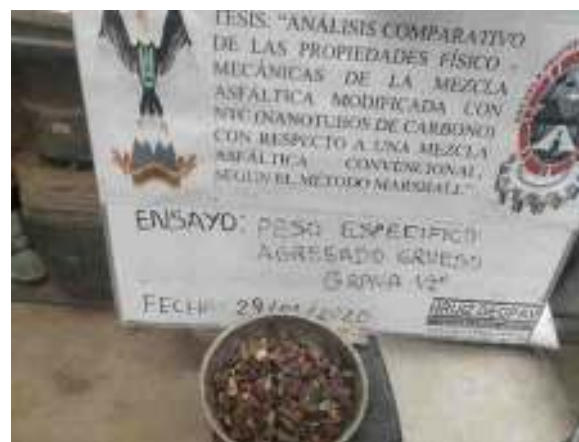
Figura 59. Muestra de agregado grueso después de estar sumergida por 24 horas.
