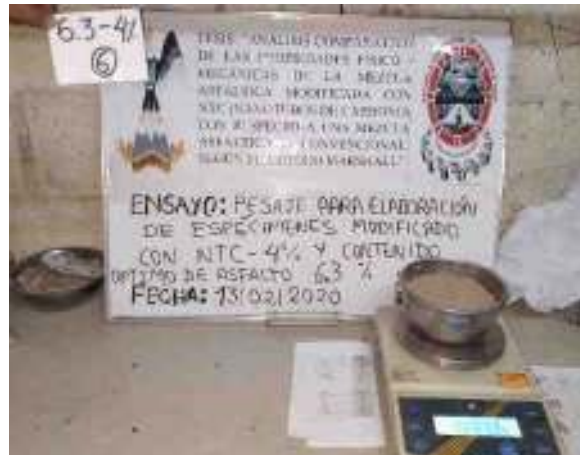
Figura 108. Pesaje de los agregados con contenido óptimo de Asfalto y 4% de Nanotubos de Carbono. Fuente: Elaboración propia
