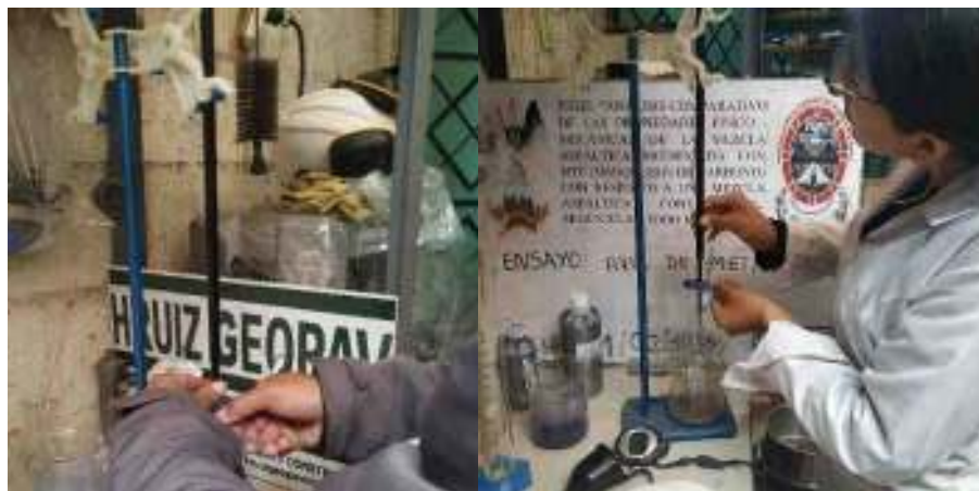
Figura 78. La bureta llena de solución de Azul de Metileno tintura los finos en suspensión
