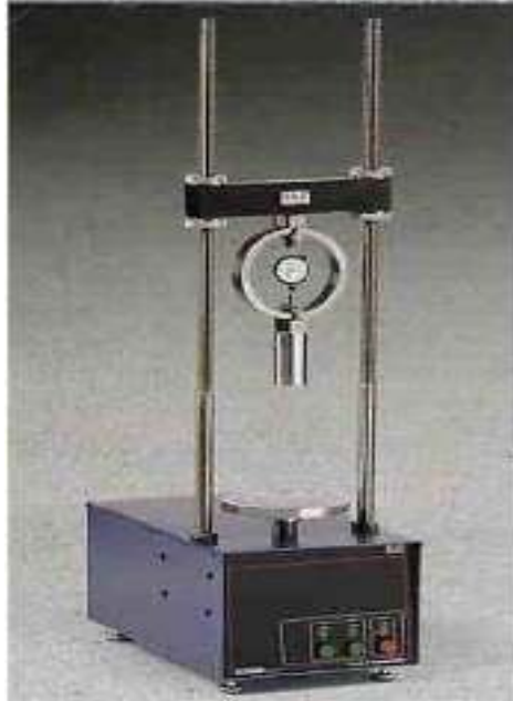
Figura 11. Máquina de Estabilidad Marshall con anillo de carga.
