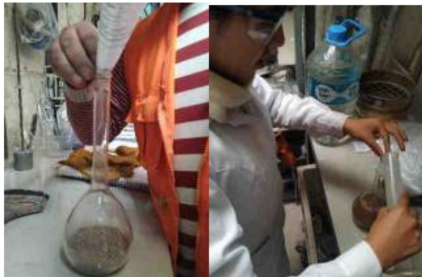
Figura 66. Introducimos la muestra a la fiola y llenamos con agua hasta los 500 cm 3
