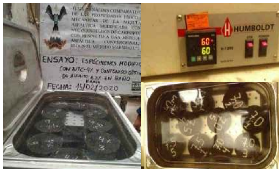
Figura 120. Sumersión de todos los especímenes asfálticos modificados en Baño María a una temperatura de 60°C. Fuente: Elaboración propia.
