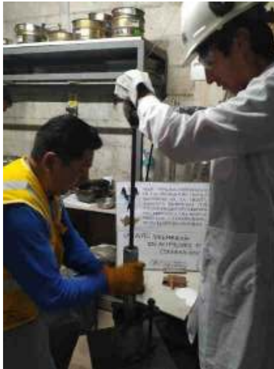
Figura 100. Compactación de los especímenes de mezcla asfáltica con un compactador manual. Fuente: Elaboración propia
