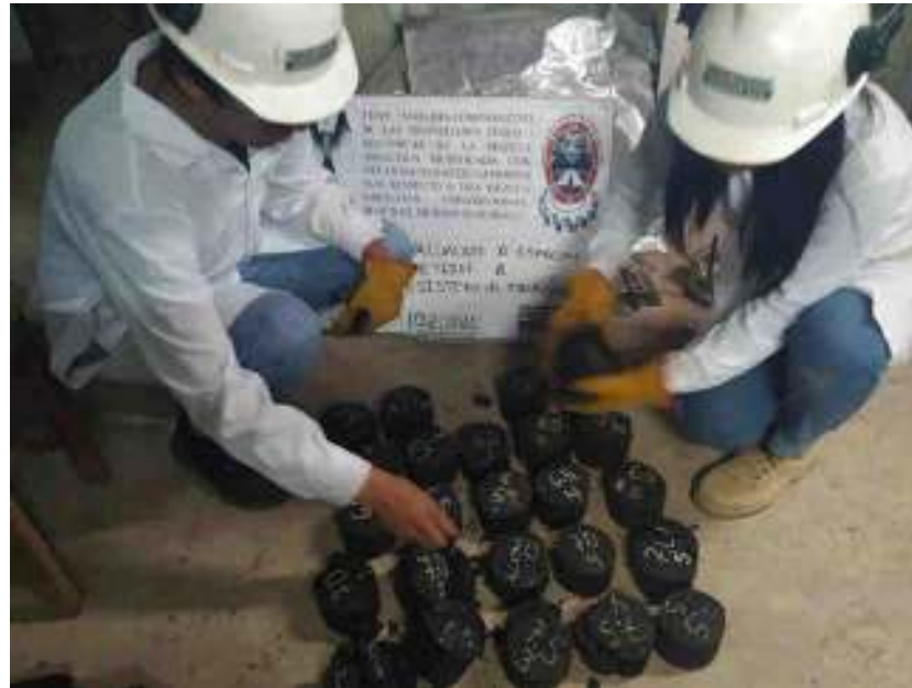
Figura 104. Evaluación de los especímenes asfálticos, tras rotura Marshall.
