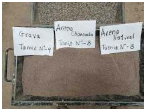
Figura 85. Combinación de agregados pasantes las mallas N°4 y N°8.
