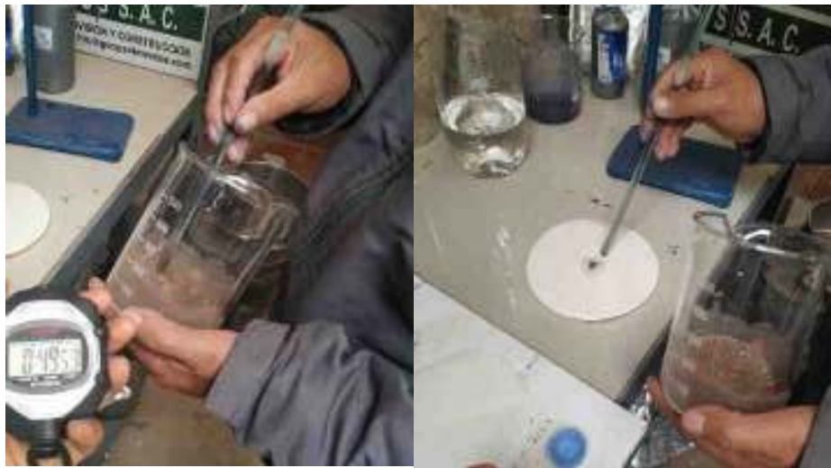
Figura 79. Agitamos la suspensión y la vertimos en papel filtro
