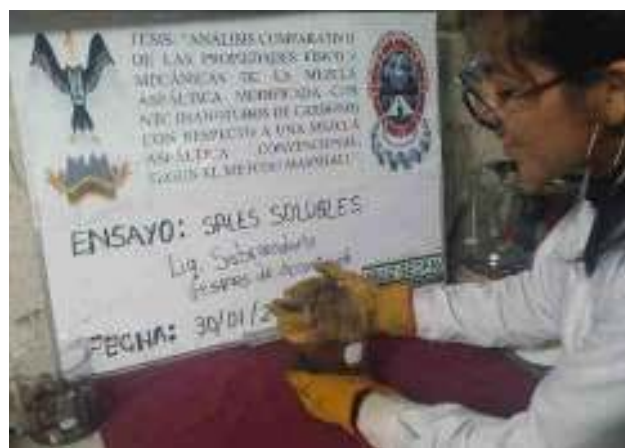
Figura 55. Decantación del líquido sobrenadante del agregado.
