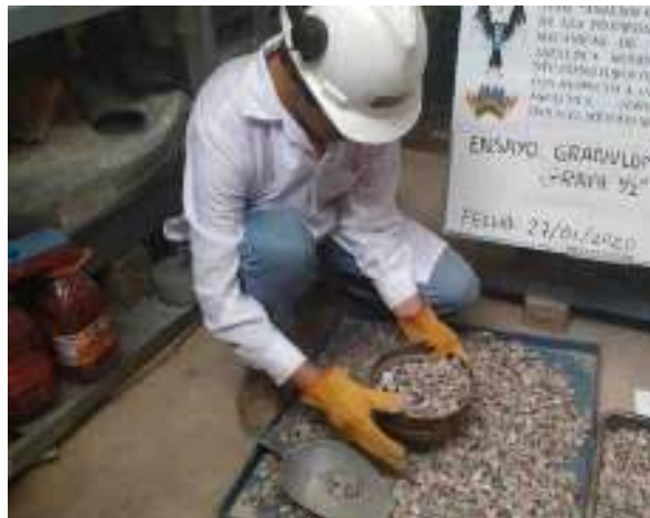
Figura 20. Tamizado de agregado grueso de forma manual.
