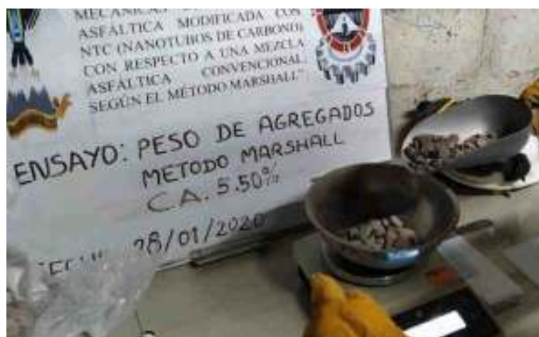
Figura 91. Pesaje de la combinación de agregados con 5.5% de contenido de asfalto.
