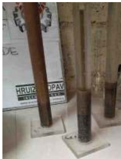
Figura 46. Probetas con agregado Fino después de ensayo de Equivalente de Arena para complementar el ensayo de Índice de Durabilidad. Fuente: Elaboración propia
