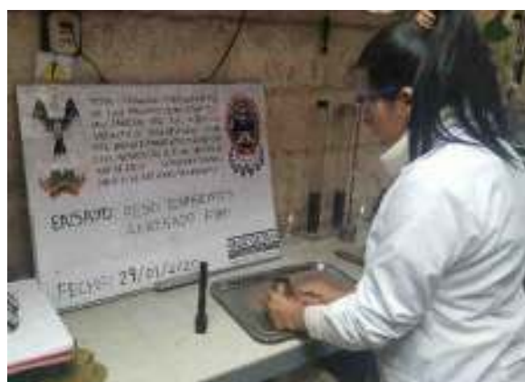
Figura 64. La muestra de agregado fino se coloca en el molde cónico para apisonar 25 veces
