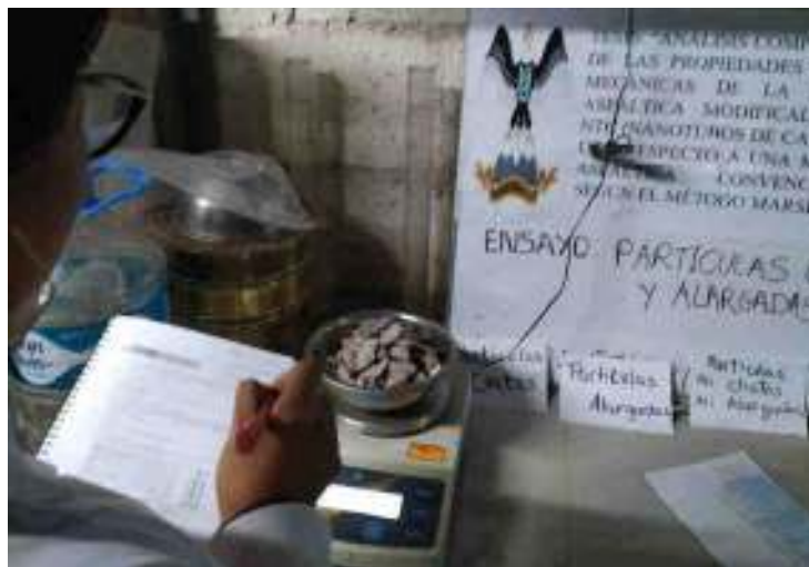
Figura 50. Registro del peso de cada clase de agregado según el tipo de partícula.
