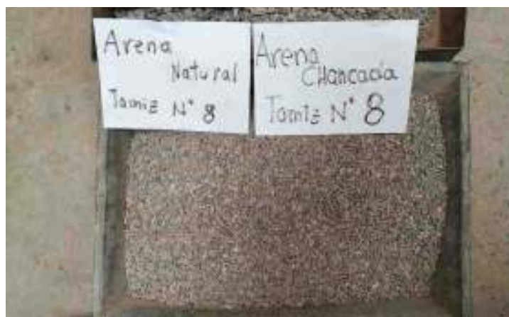
Figura 86. Combinación de agregados retenidos en la malla N°8.
