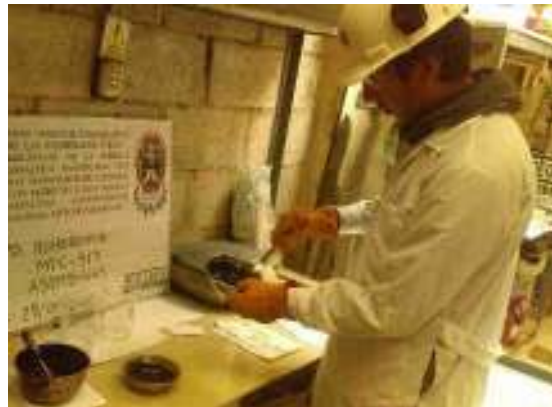
Figura 36. Mezcla del agregado con el Asfalto precalentado.
