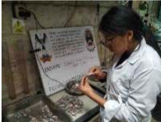
Figura 51. Se observa detenidamente y directamente cada partícula para determinar sus caras fracturadas. Fuente: Elaboración propia
