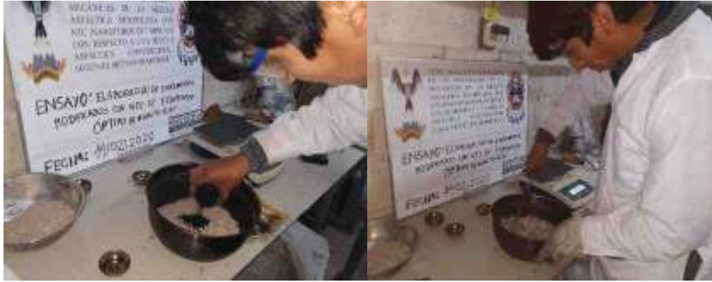
Figura 111. Se agregan los Nanotubos de Carbono al pesaje de agregados y se mezclan.
