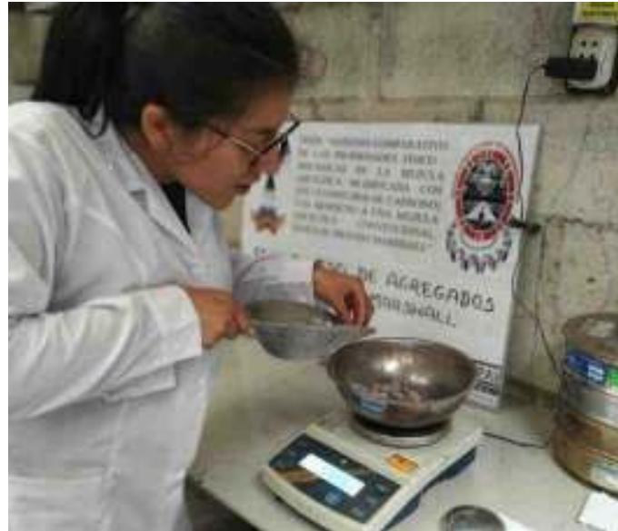
Figura 90. Pesaje de la combinación de agregados según el Diseño MAC -02.
