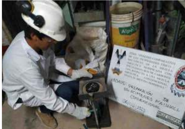
Figura 101. Extracción de las briquetas con el eyector de muestras
