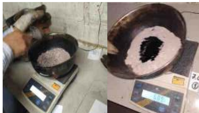
Figura 97. Pesaje y añadido de agregados y cemento asfáltico.
