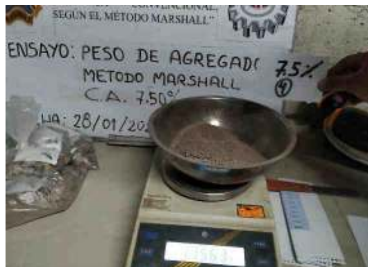
Figura 95. Pesaje de la combinación de agregados con 7.5% de contenido de asfalto.
