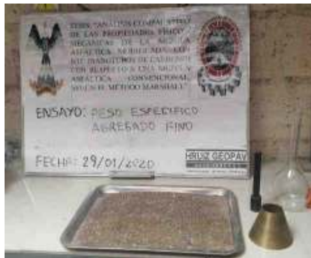
Figura 63. Agregado fino extendido en superficie plana después de remojo.
