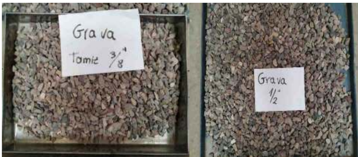
Figura 88. Gradación de grava de \frac{1}{2} " retenida en los tamices N° \frac{3}{8} " y N° \frac{1}{2} "
