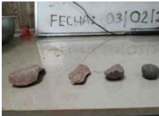
Figura 52. Muestra de partículas desde la partícula con más caras fracturadas hasta la más redondeada. Fuente: Elaboración propia
