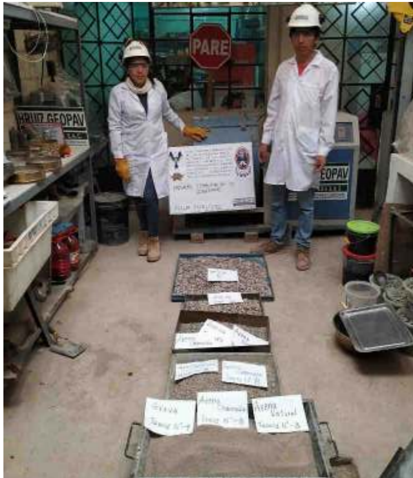
Figura 89. Combinación de agregados final para preparación de mezcla asfáltica según diseño. Fuente: Elaboración propia
