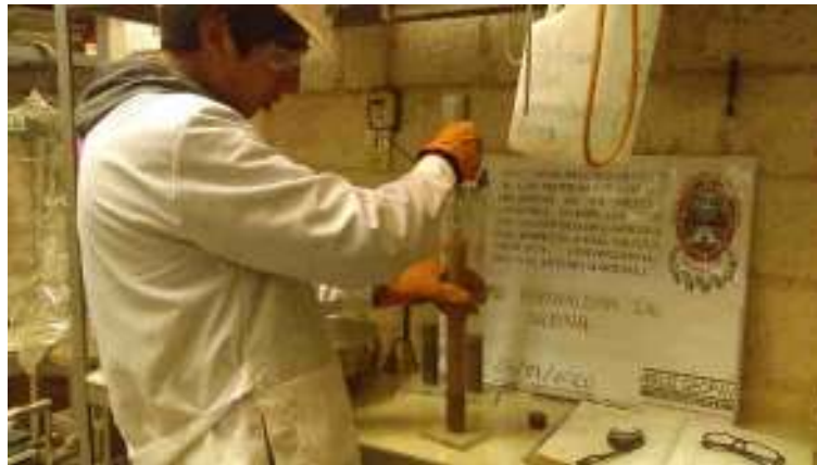
Figura 74. Colocamos el pisón sobre la probeta con las muestras.
