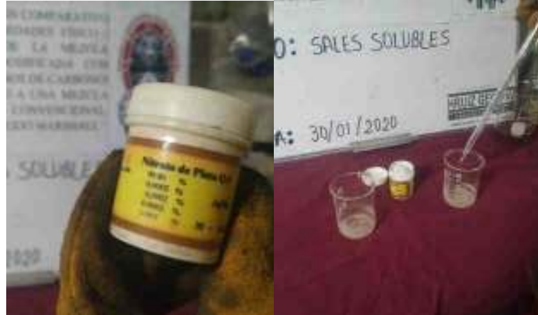
Figura 56. Se agrega las gotas del reactivo: Nitrato de Plata.
