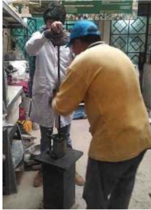
Figura 115. Compactación de los especímenes de mezcla asfáltica modificada con un compactador manual. Fuente: Elaboración propia
