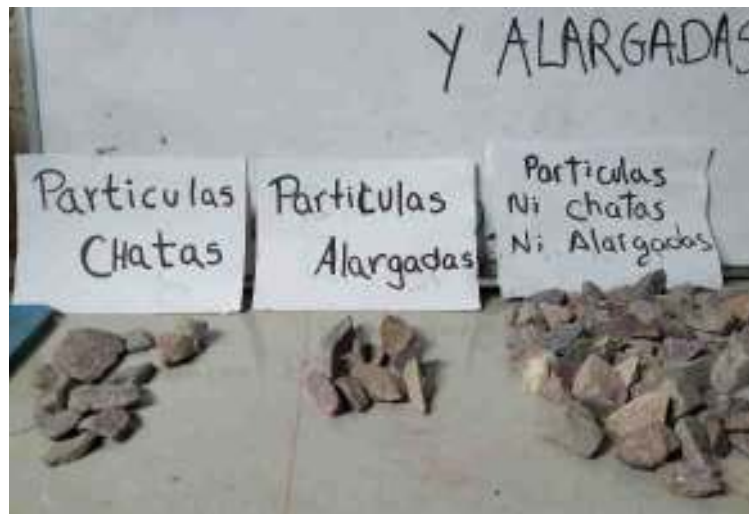
Figura 49. Clasificación de las partículas según su forma: Chatas, Alargadas y Ni chatas ni alargadas. Fuente: Elaboración propia
