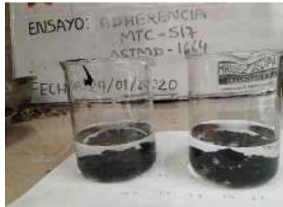
Figura 125. Análisis visual del revestimiento de asfalto PEN 85/100 al agregado grueso. Fuente: Elaboración propia
