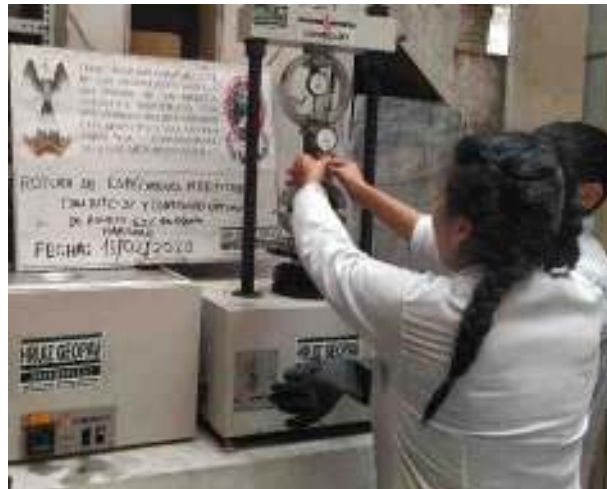
Figura 121. Ensayo de Estabilidad y Flujo Marshall en muestras Modificadas
