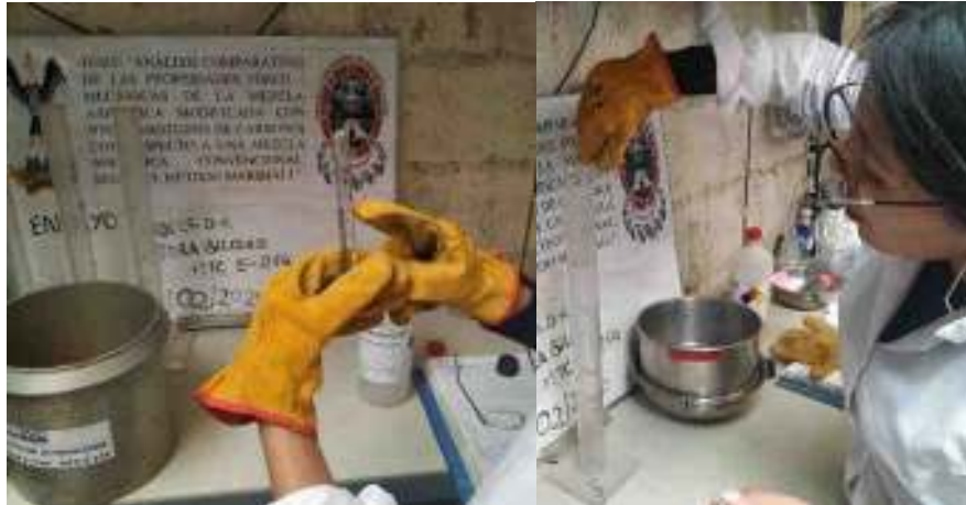
Figura 39. Se vierte la solución de Cloruro de Calcio a la probeta.
