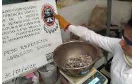
Figura 60. Peso del agregado en estado Saturado Superficialmente Seco.
