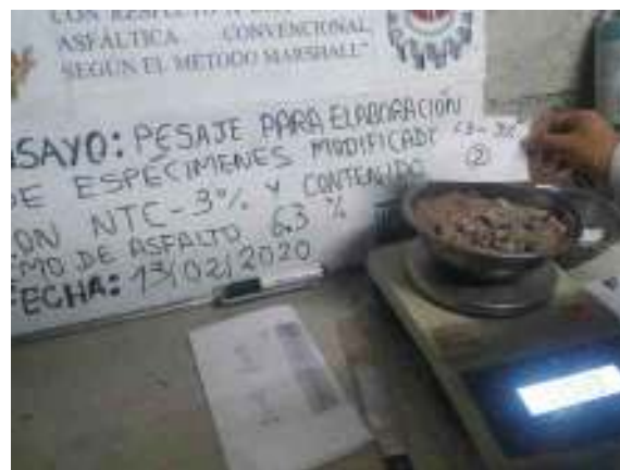
Figura 107. Pesaje de los agregados con contenido óptimo de Asfalto y 3% de Nanotubos de Carbono. Fuente: Elaboración propia
