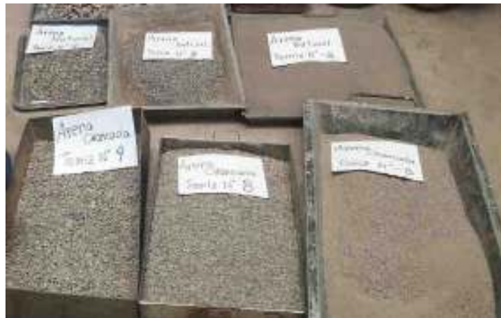
Figura 25. Análisis Granulométrico de agregado Fino.
