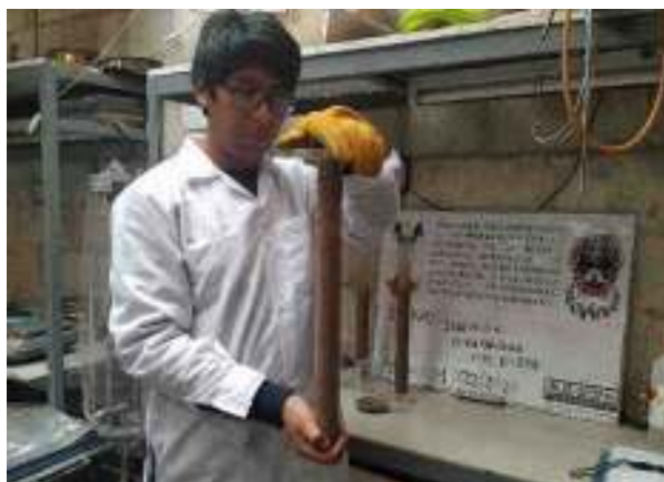
Figura 42. Agitación del agua de lavado con solución en probeta
