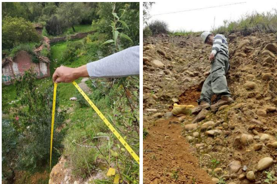
Figura 16: Talud izquierdo – Trinchera para obtención de muestras Fuente: Propia
