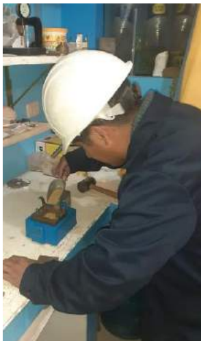
Figura 24: Colocación de la muestra en la caja de corte
