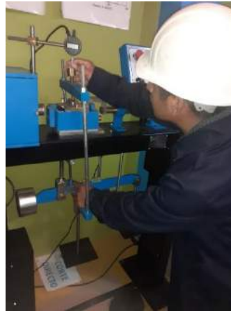
Figura 26: Nivelando la aplicación de la carga axial.
