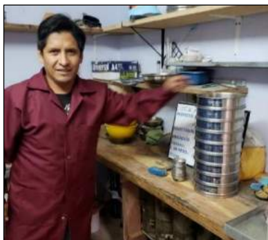
Figura 19: Agregados ordenados luego del tamizado de derecha a izquierda de las mallas #4 a #200
