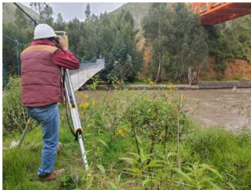
Figura 28: Levantamiento topográfico del talud Fuente: Propia
