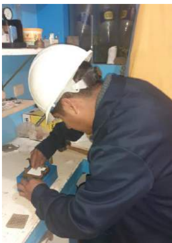
Figura 25: Ensamblando la caja de corte.
