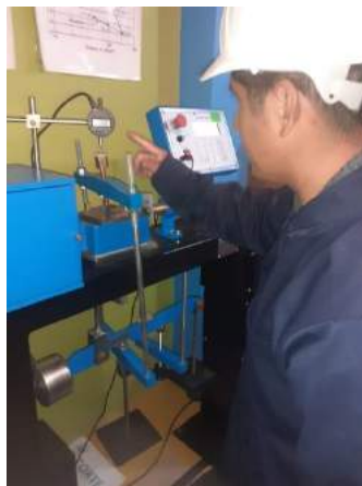
Figura 27: Nivelando la aplicación de la carga axial.
