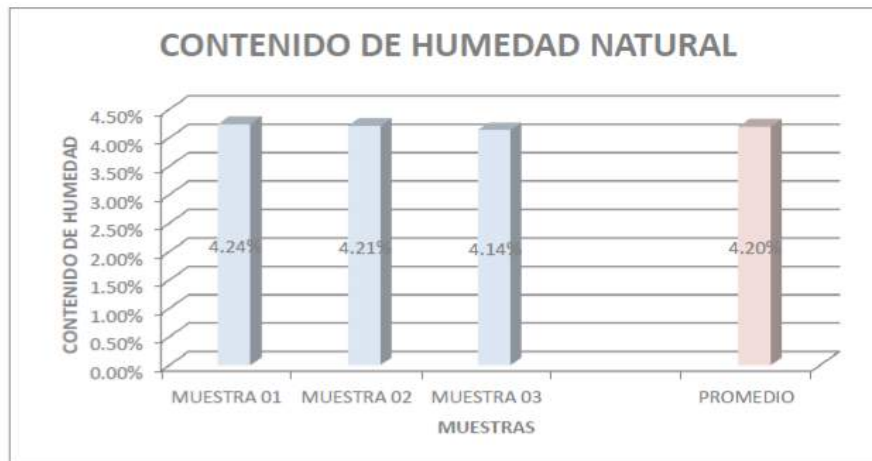
Figura 31: Contenido de Humedad Natural - Trinchera (0.60x0.60x0.50 Mts) Fuente: Propia
