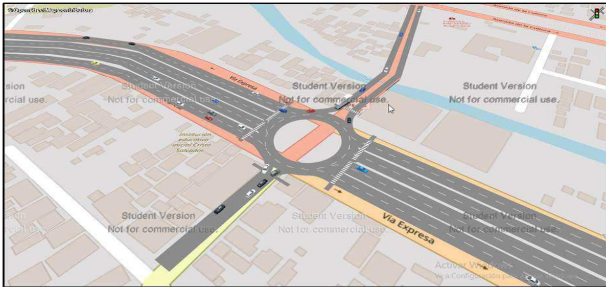
Figura 59: Micromodelación con VISSIM – Óvalo Moderno de Av. Tomas Katari– Vía Expresa.
