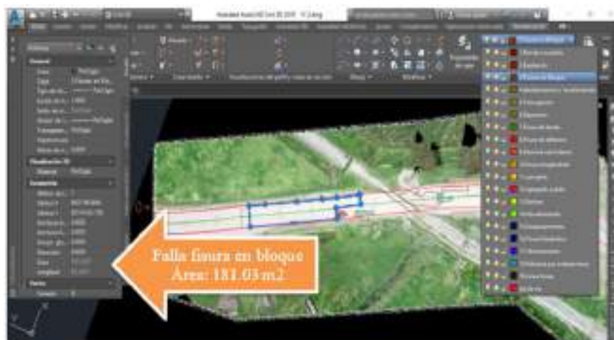
Figura 41 Determinación del área de fallas
