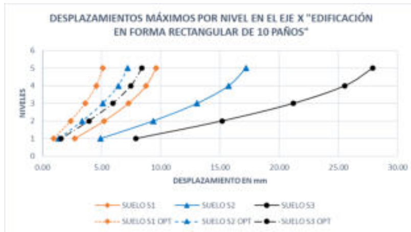
Figura 43. Desplazamientos máximos por nivel en el eje "X" edificación propuesta en forma rectangular de 10 paños
