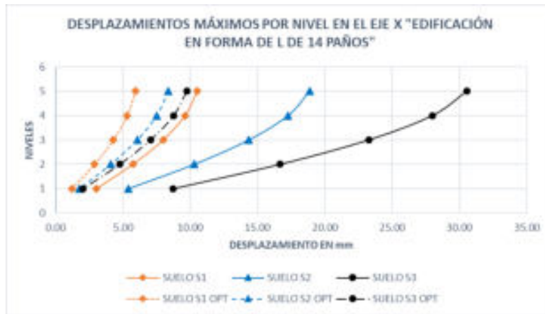
Figura 55. Desplazamientos máximos por nivel en el eje "X" edificación propuesta en forma de L de 14 paños
