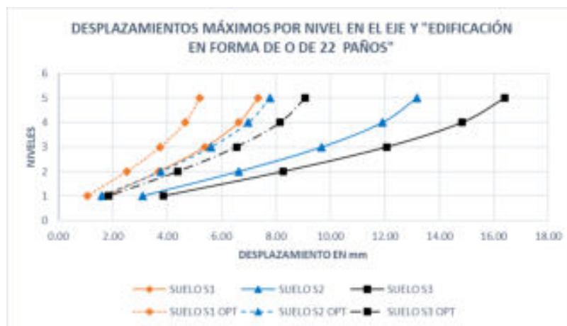
Figura 64. Desplazamientos máximos por nivel en el eje "Y" edificación propuesta en forma de O de 22 paños
