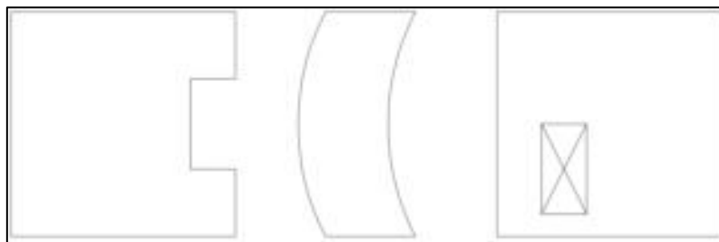
Figura 12. Formas asimétricas en planta que son indeseables
