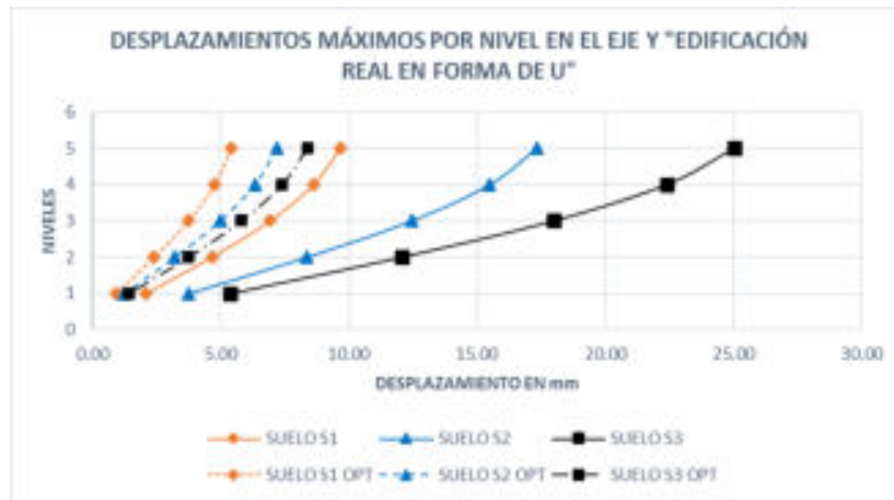
Figura 40. Desplazamientos máximos por nivel en el eje "Y" edificación existente en forma de U
