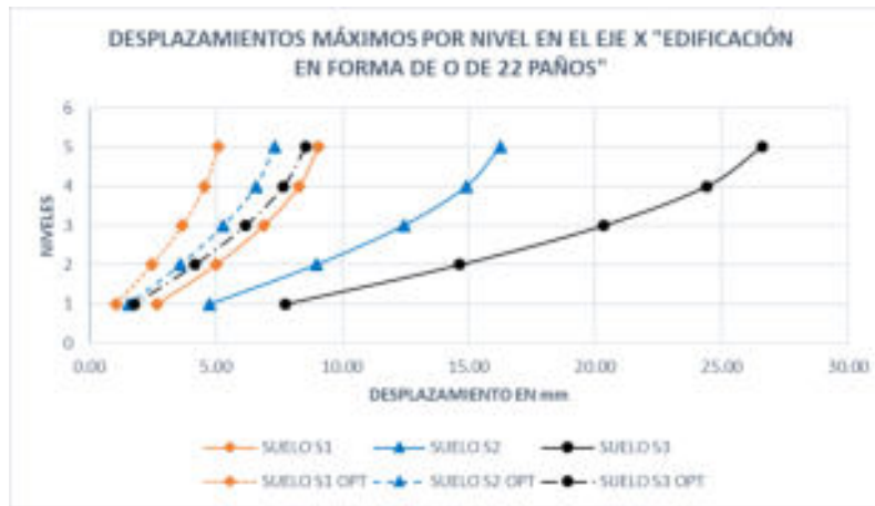
Figura 63. Desplazamientos máximos por nivel en el eje "X" edificación propuesta en forma de O de 22 paños
