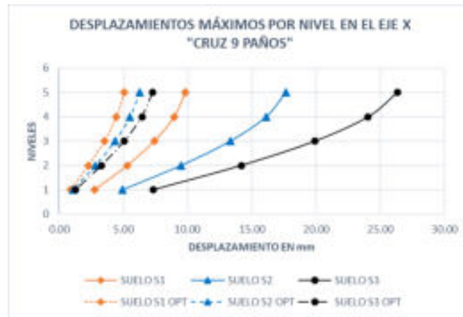
Figura 45. Desplazamientos máximos por nivel en el eje "X" edificación propuesta en forma de cruz de 9 paños
