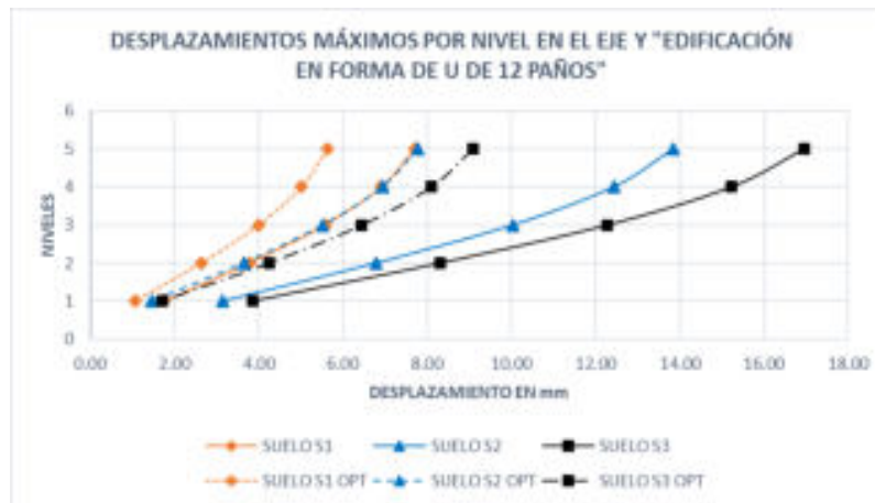
Figura 52. Desplazamientos máximos por nivel en el eje "Y" edificación propuesta en forma de U de 12 paños
