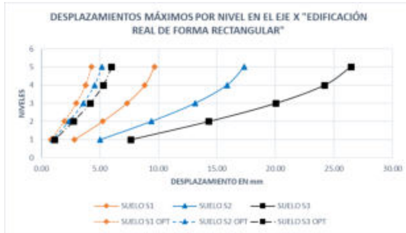
Figura 35. Desplazamientos máximos por nivel en el eje "X" edificación existente en forma rectangular
