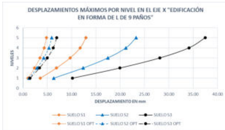
Figura 53. Desplazamientos máximos por nivel en el eje "X" edificación propuesta en forma de L de 9 paños
