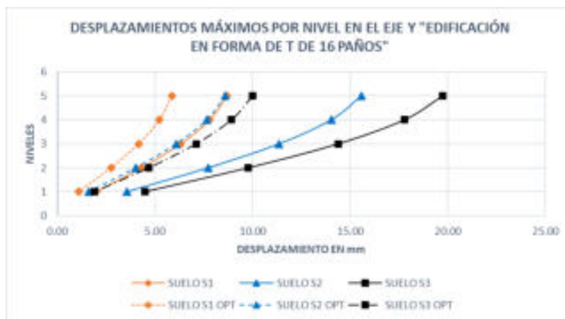
Figura 60. Desplazamientos máximos por nivel en el eje "Y" edificación propuesta en forma de T de 16 paños
