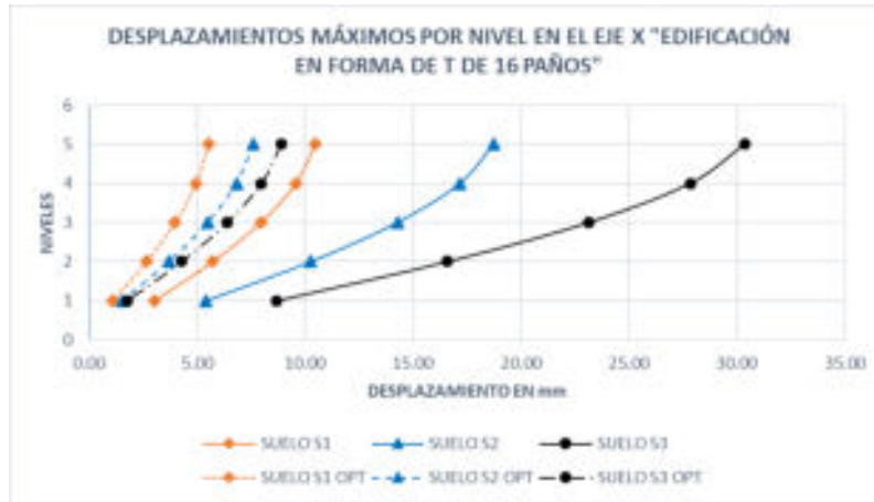
Figura 59. Desplazamientos máximos por nivel en el eje "X" edificación propuesta en forma de T de 16 paños
