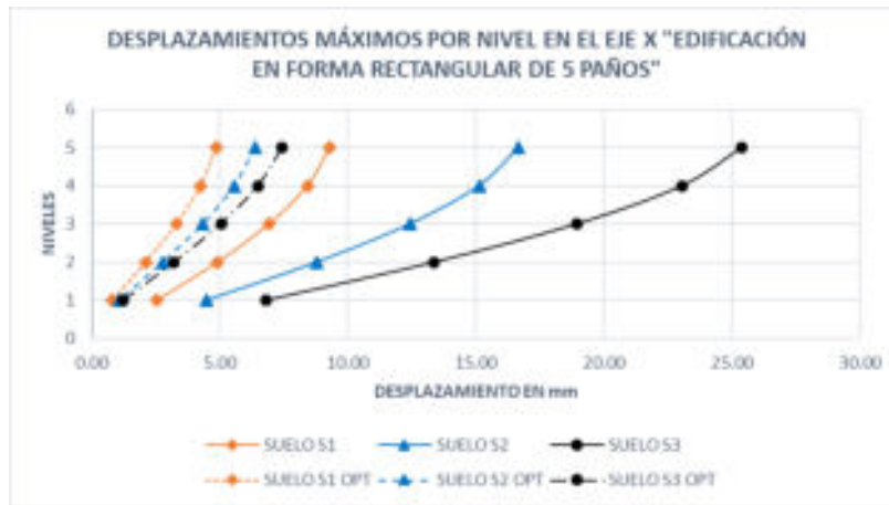
Figura 41. Desplazamientos máximos por nivel en el eje "X" edificación propuesta en forma rectangular de 5 paños
