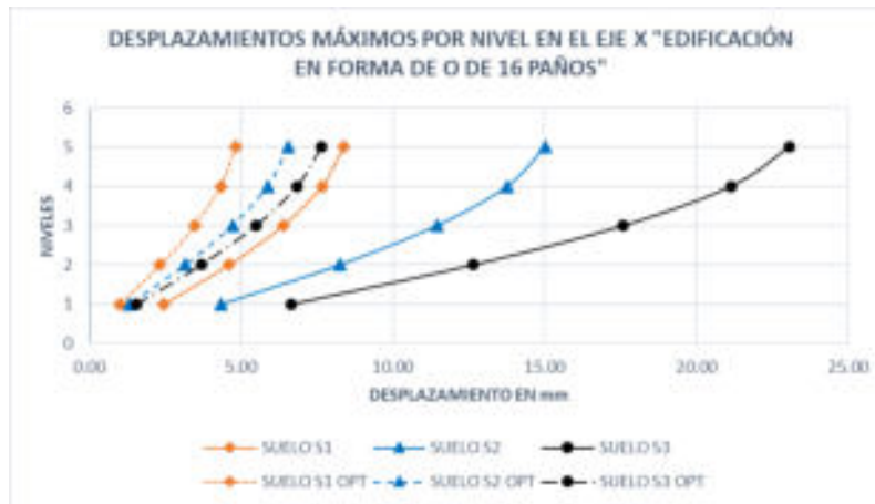
Figura 61. Desplazamientos máximos por nivel en el eje "X" edificación propuesta en forma de O de 16 paños
