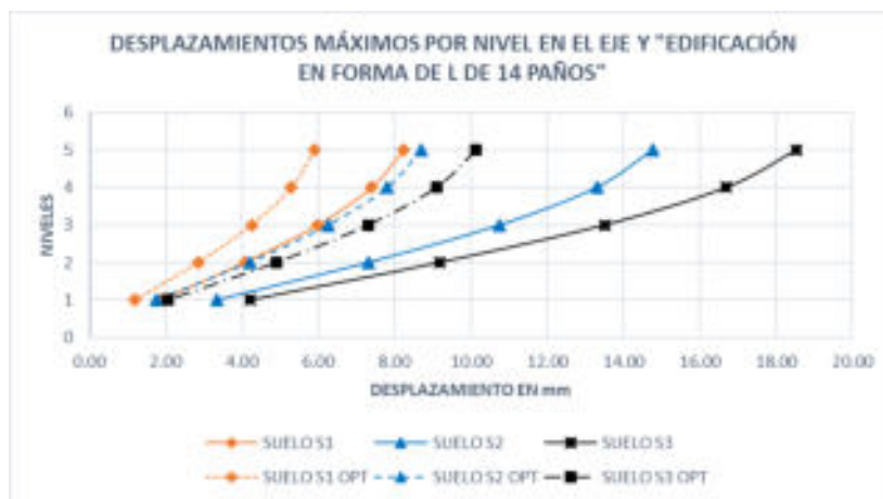
Figura 56. Desplazamientos máximos por nivel en el eje "Y" edificación propuesta en forma de L de 14 paños
