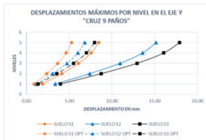
Figura 46. Desplazamientos máximos por nivel en el eje "Y" edificación propuesta en forma de cruz de 9 paños
