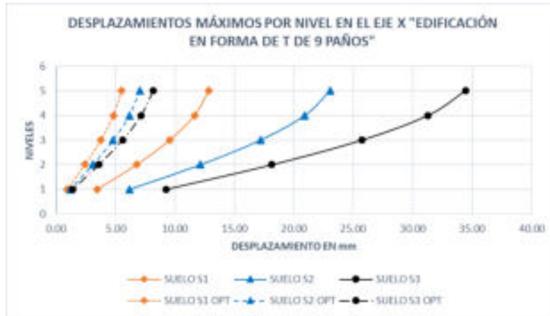
Figura 57. Desplazamientos máximos por nivel en el eje "X" edificación propuesta en forma de T de 9 paños
