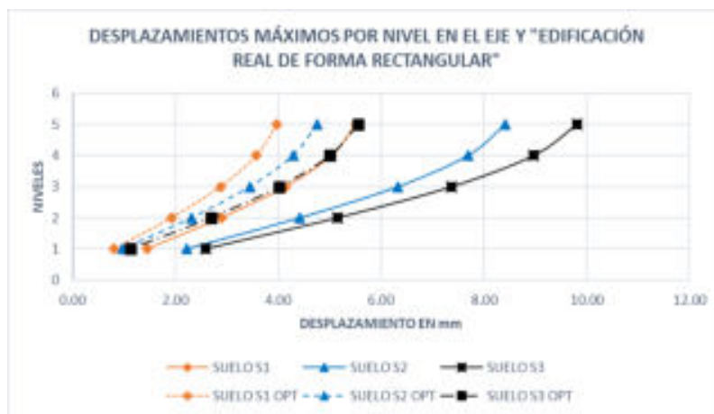
Figura 36. Desplazamientos máximos por nivel en el eje "Y" edificación existente en forma rectangular
