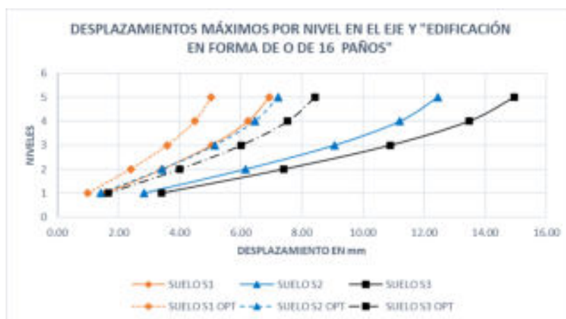
Figura 62. Desplazamientos máximos por nivel en el eje "Y" edificación propuesta en forma de O de 16 paños
