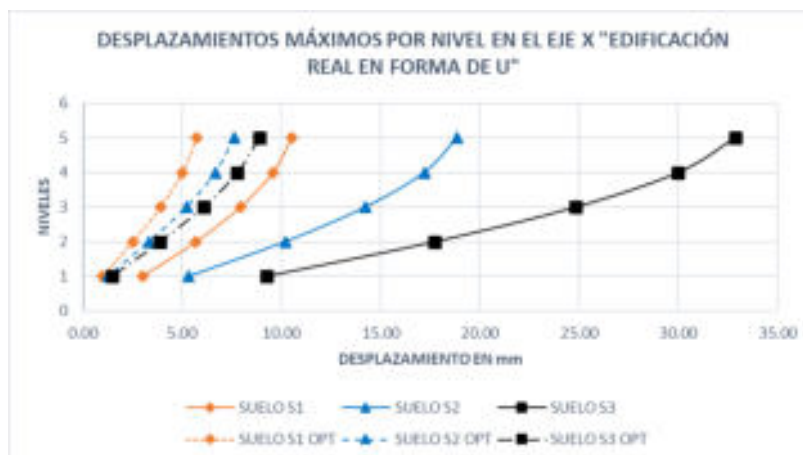
Figura 39. Desplazamientos máximos por nivel en el eje "X" edificación existente en forma de U
