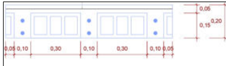
Figura 32. Losa típica para estimación de peso
