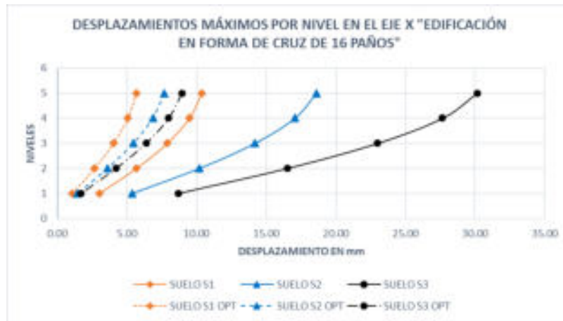
Figura 47. Desplazamientos máximos por nivel en el eje "X" edificación propuesta en forma de cruz de 16 paños
