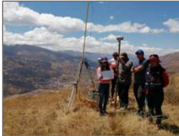
Figura 70 Equipo GPS Diferencial instalado
