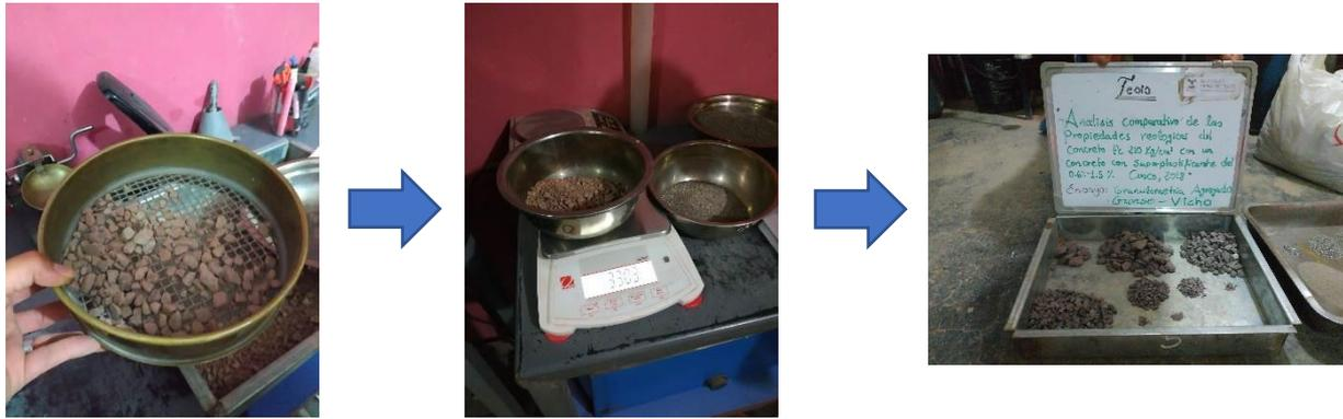
Figura 45: Proceso de obtención de cada peso retenido por tamiz
