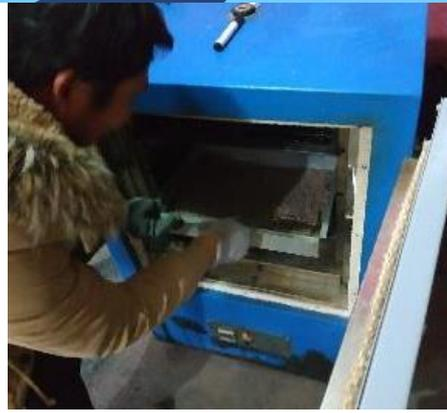
Figura 57: Secado de la muestra en el horno del agregado de la cantera de Cunyac y Huambutio
