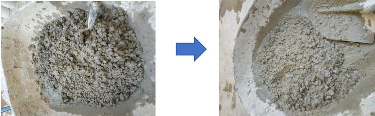
Figura 62: Recolección de la mezcla de concreto del molde tipo columna tanto de la parte superior e inferior
