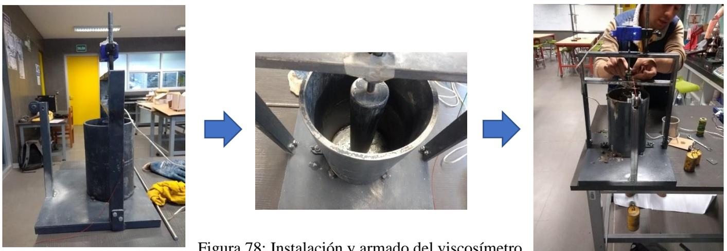
Figura 78: Instalación y armado del viscosímetro
