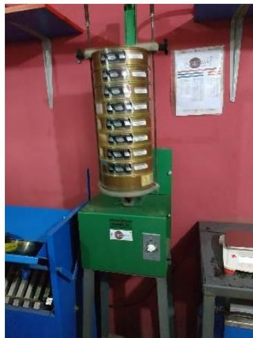
Figura 44: Tamizador eléctrico
