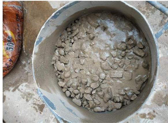
**Fotografía 09:** Proceso de caída por gravedad en el ensayo de factor de compactación del concreto.
