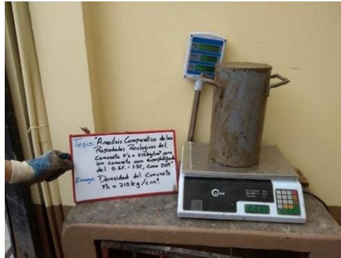
Figura 90: Registro del peso del concreto de densidad
