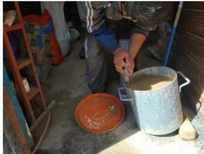
Figura 70: Extracción del agua exudada en cada intervalo de tiempo
