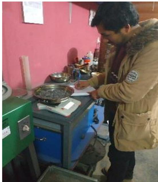
Figura 56: Registro del peso de la muestra en estado natural del agregado fino de la cantera de Cunyac y Huambutio
