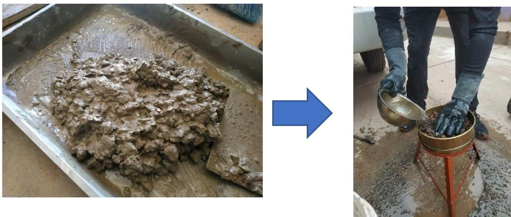
Figura 63: Proceso del lavado del concreto de la parte inferior y superior
