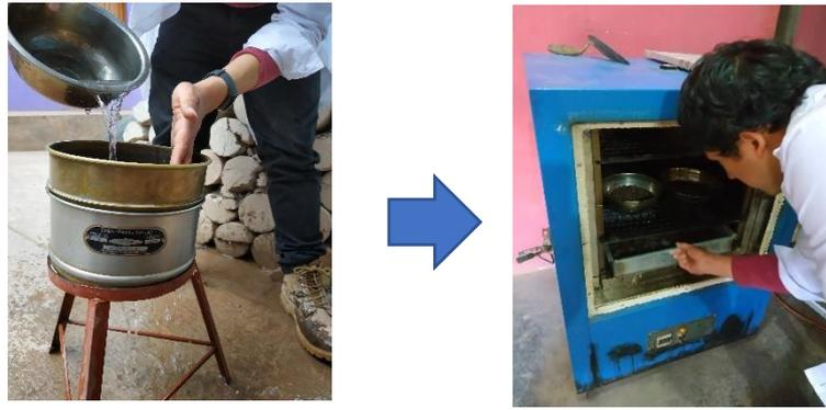
Figura 47: Lavado y puesta en horno del agregado grueso de Vicho
