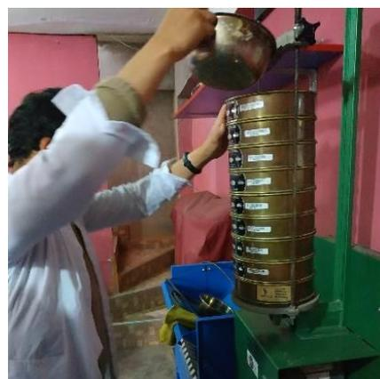
Figura 52: Proceso de tamizado de los agregados fino de la cantera de Cunyac y Huambutio
