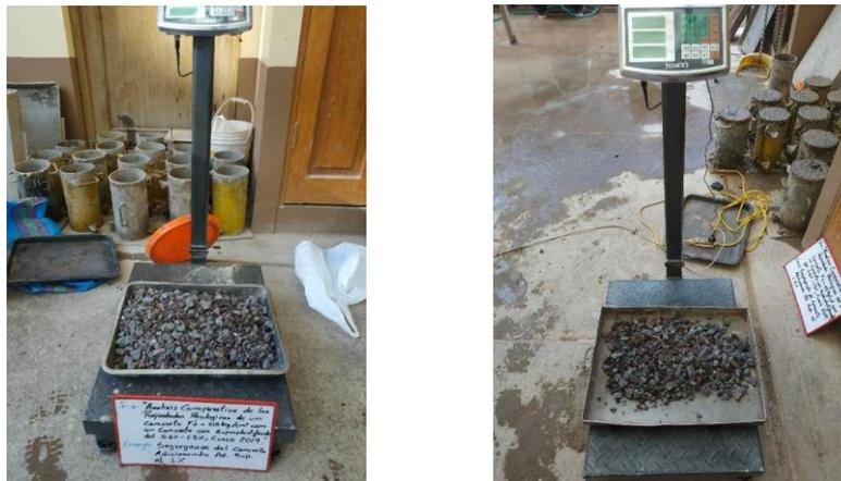
Figura 65: Registro del peso inferior y superior seco
