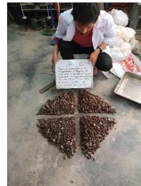
Figura 42: Cuarteo manual del agregado grueso de Vicho
