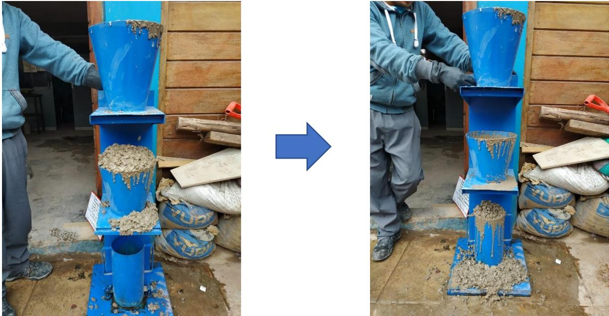
Figura 95: Procedimiento por gravedad del retirado de las trampas en el aparato de factor de compactación
