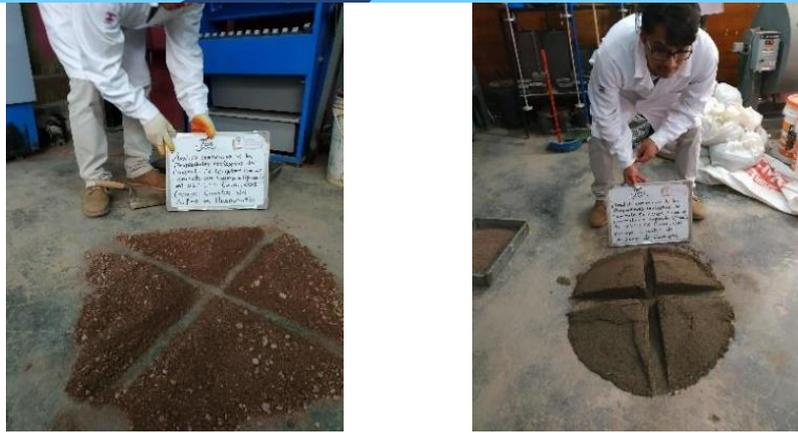
Figura 51: Cuarteo del agregado fino de la cantera de Cunyac y Huambutio
