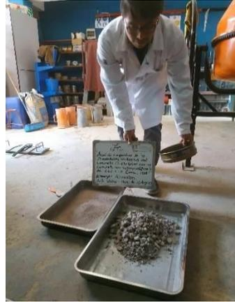
Figura 103: Ensayo resistencia a la abrasión del agregado grueso de la cantera Vicho
