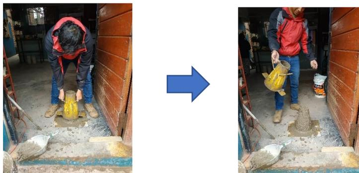
Figura 75: Retiro del cono de Abrams en forma perpendicular
