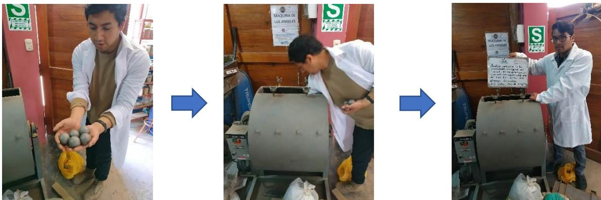
Figura 48: Proceso de preparación de la máquina de los Ángeles previo al ensayo
