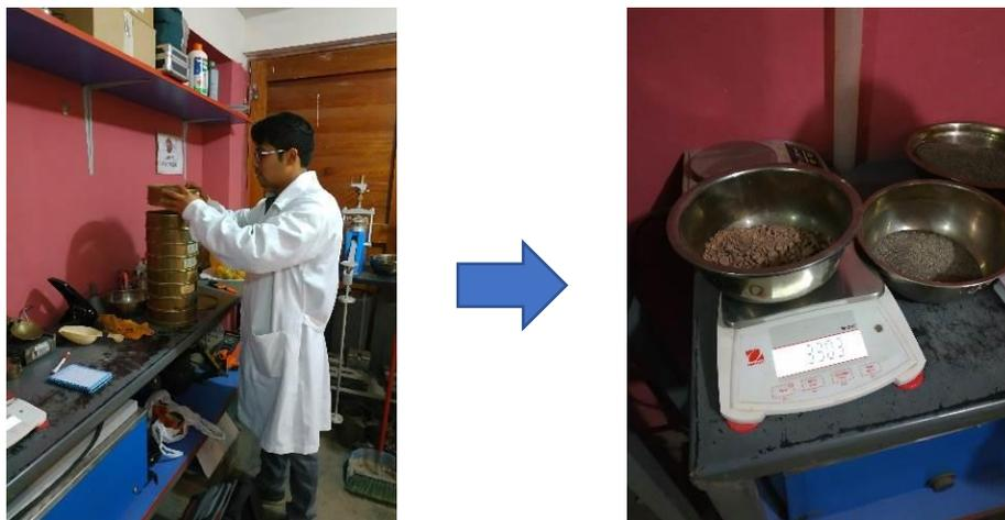
Figura 54: Proceso de tamizado y registro de pesos de material retenido en cada tamiz del agregado fino de la cantera Huambutio
