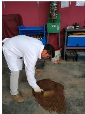
Figura 50: Mezcla uniforme del agregado fino de la cantera de Cunyac y Huambutio
