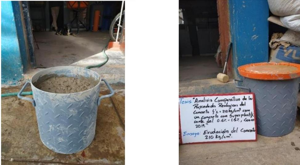
Figura 69: Colocación y almacenamiento del recipiente de exudación
