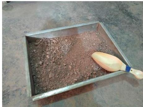
Figura 58: Muestra totalmente seca del agregado fino
