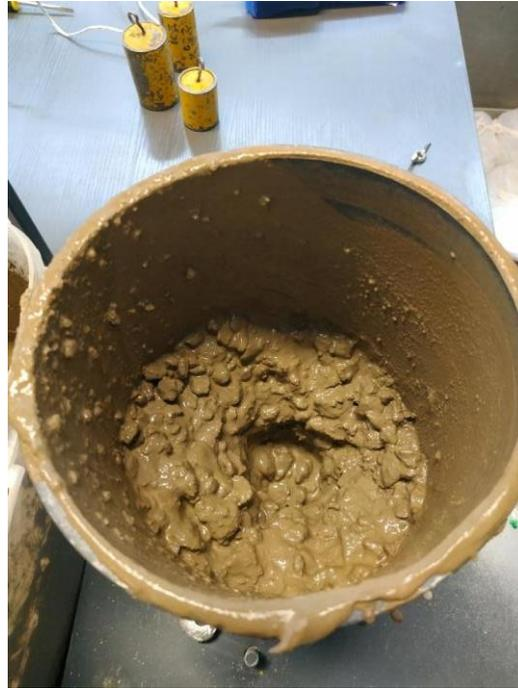
**Fotografía 06:** Recolección de datos con ayuda del equipo Xplorer GLX de las muestras de concreto en estado fresco para el análisis de datos de la viscosidad.
