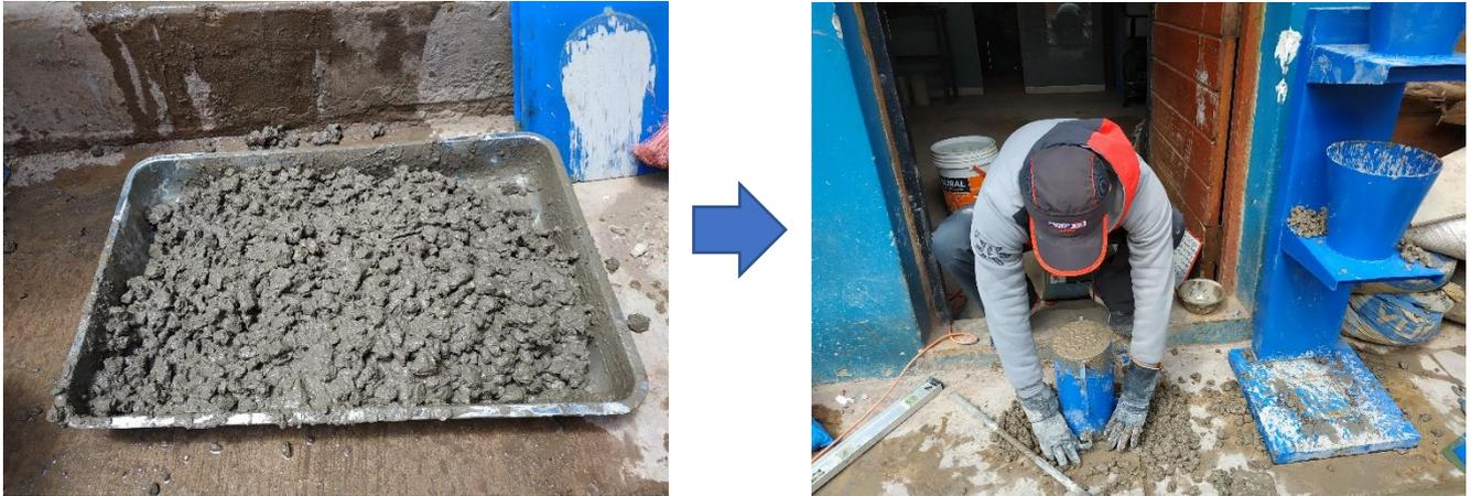
Figura 99: Proceso de vaciado y varillado de la mezcla de concreto
