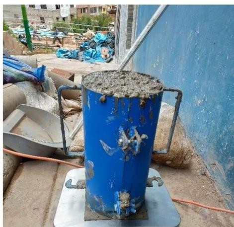
Figura 96: Retirado del sistema de fijación de la briqueta inferior del aparato de factor de compactación
