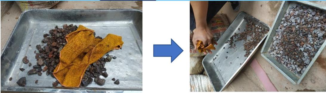
Figura 64: Proceso del secado del concreto utilizando de un paño absorbente
