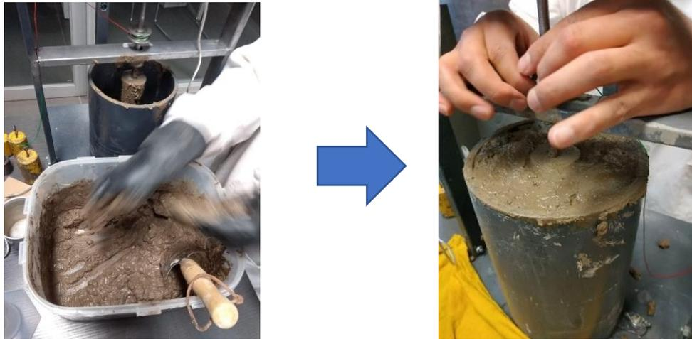
Figura 79: Vertido del concreto en el viscosímetro
