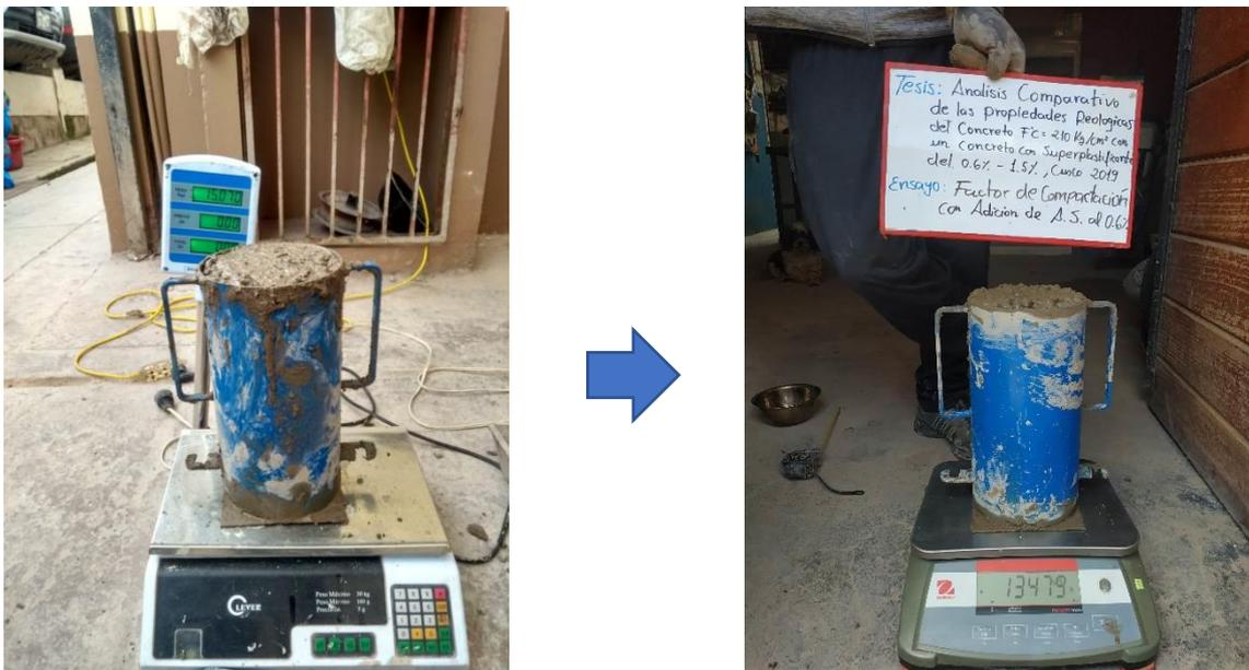
Figura 100: Registro del peso totalmente compactado
