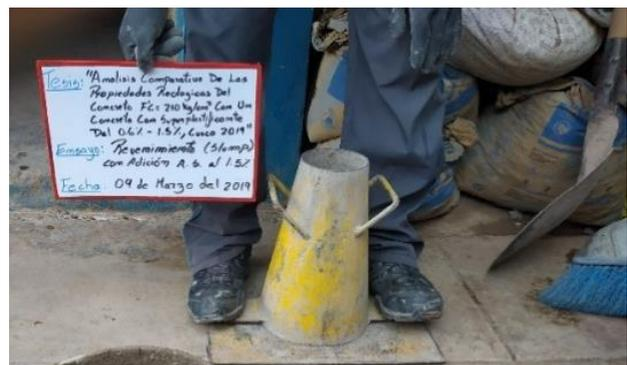
Figura 73: Nivelado e instalación del Cono de Abrams
