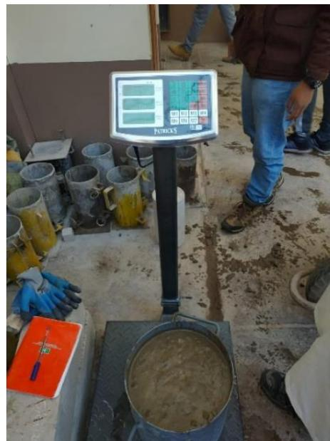
Figura 68: Registro del peso del recipiente lleno con la mezcla de concreto
