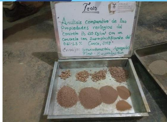
Figura 55: Muestras del peso retenido por tamiz
