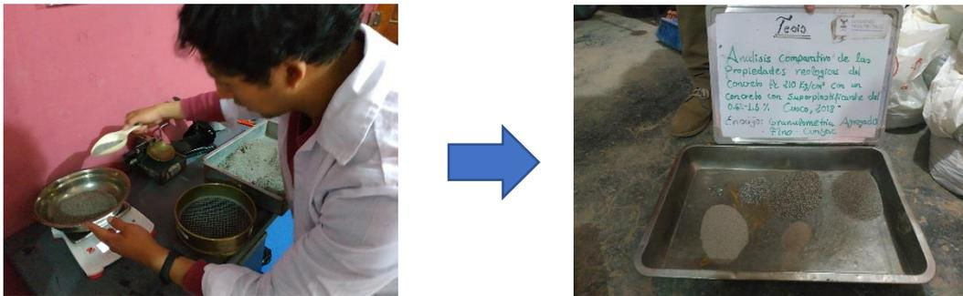
Figura 53: Registro de pesos retenido por cada tamiz del agregado fino de Cunyac
