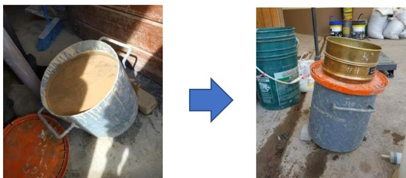
Figura 71: Inclinación del recipiente antes de la extracción del agua
