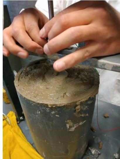
**Fotografía 04:** Ensayo de viscosidad del concreto aditivado con superplastificante del 0.6% - 1.5% con ayuda del viscosímetro de cilindros concéntricos adaptado al concreto en Laboratorio de física.
