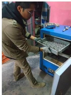
Figura 46: Ingreso del agregado grueso de Vicho al horno eléctrico
