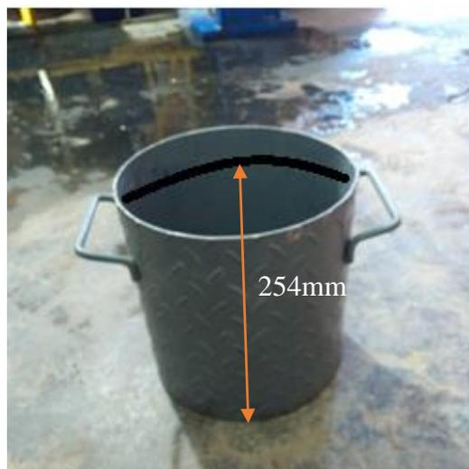
Figura 66: Registrado de la altura límite del recipiente de exudación
