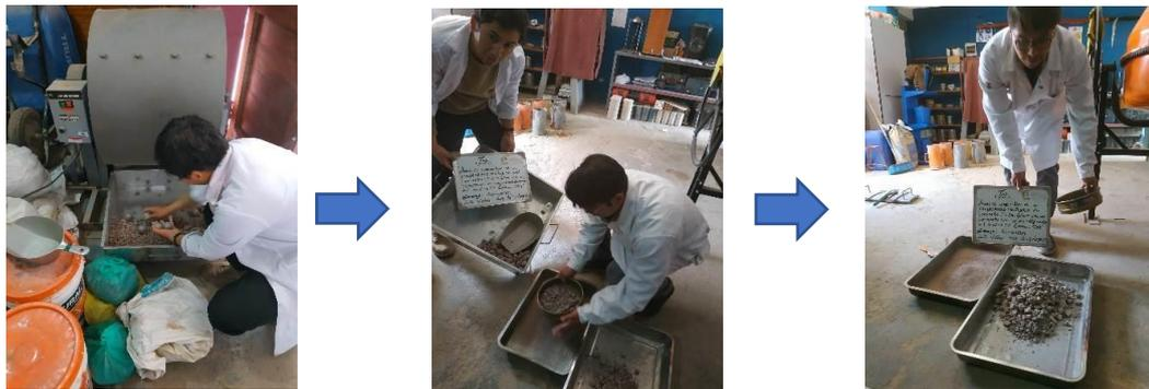
Figura 49: Tamizado y registro del peso del agregado grueso molido en la máquina de los Ángeles.
