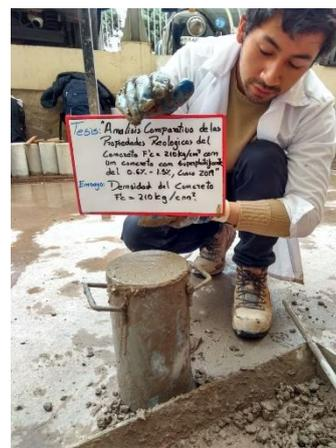
Figura 87: Proceso de varillado por cada capa
