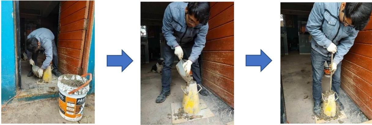
Figura 74: Proceso de vertido del concreto en tres capas en el cono de Abrams
