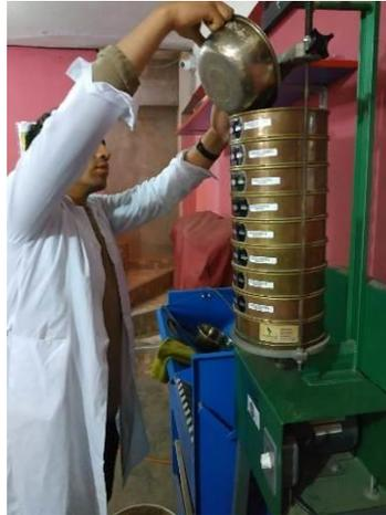
Figura 43: Proceso de tamizado con ayuda de un tamizador eléctrico
