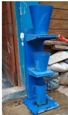
Figura 91: Instalación y reajustes del equipo de factor de compactación
