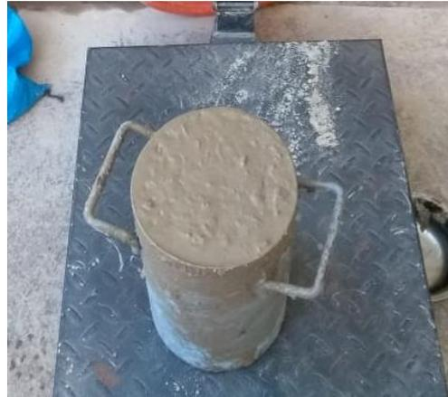
Figura 86: Vertido de la mezcla de concreto hacia el recipiente de densidad
