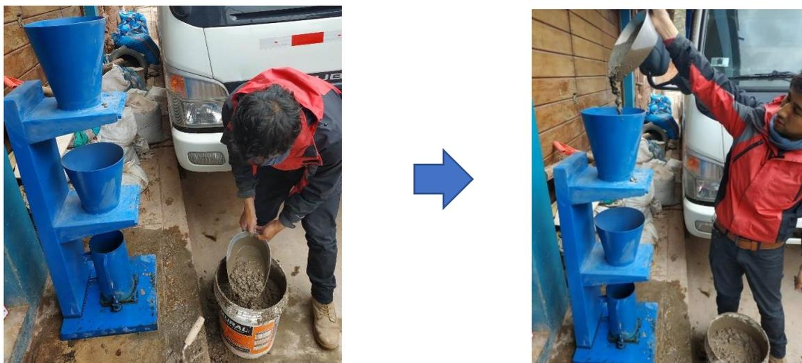
Figura 94: Vertido de la mezcla de concreto hacia el aparato de factor de compactación
