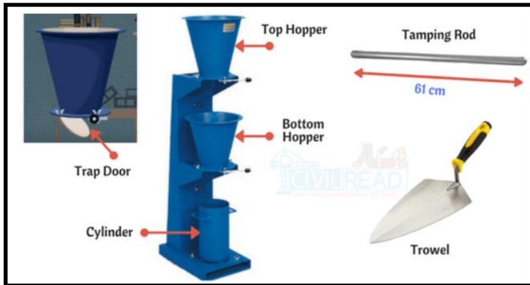
Figura 30: Aparatos e instrumentos para la elaboración del factor de compactación
