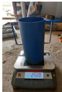
Figura 92: Registro del peso de la briqueta vacía
