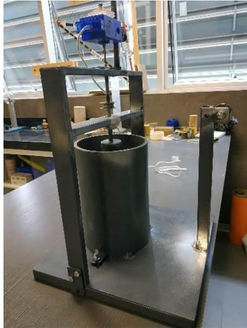
Figura 40: Viscosímetro de cilindros concéntricos
