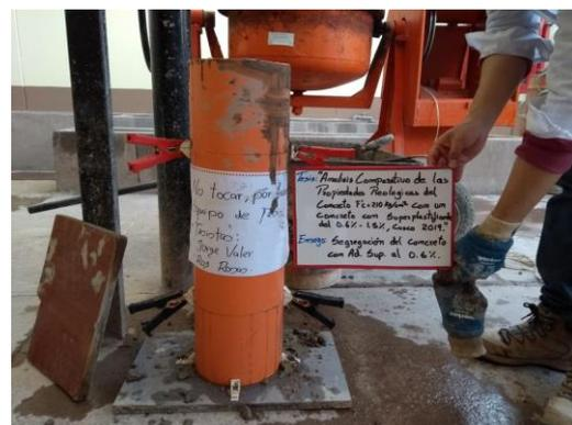
Figura 61: Enrasado y periodo de reposo de la mezcla de concreto en el molde tipo columna
