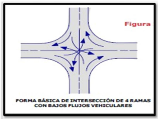
FIGURA 16. Intersección de 4 ramales con bajos flujos vehiculare
