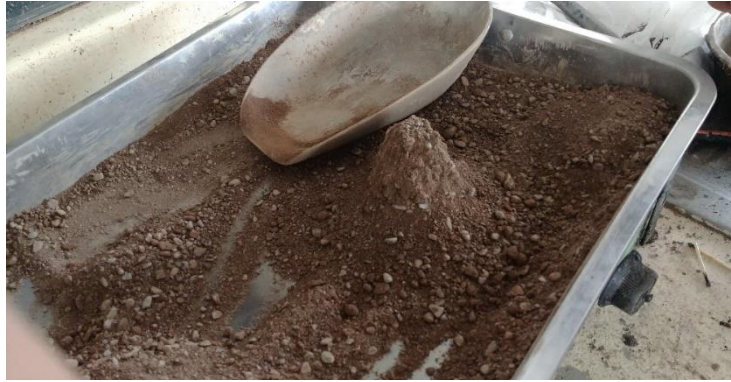
Figura 80: Arena superficialmente seca
