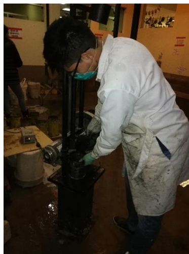
Figura 153: Vaciado de la mezcla al molde
