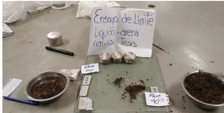
Figura 101: Muestras de la arena natural pasante el tamiz N°40
