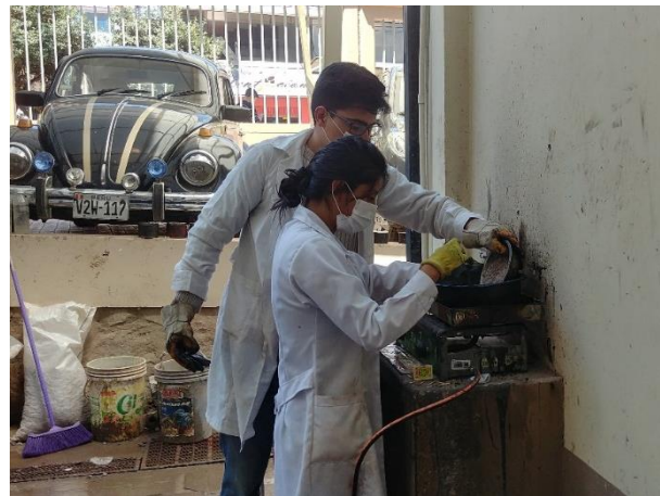
Figura 129: Vaciado de agregados en el asfalto
