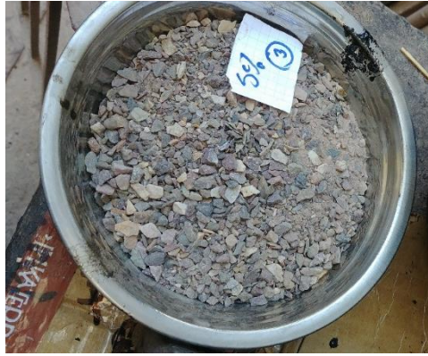
Figura 125: Mezcla de arena triturada y natural
