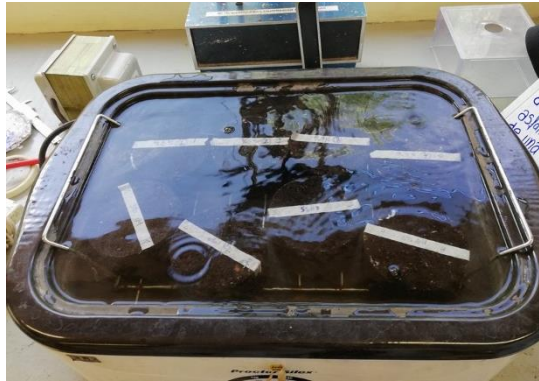
Figura 139: Especímenes sumergidos en el baño maría
