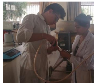
Figura 85: Extracción de vacíos con la bomba de vacíos
