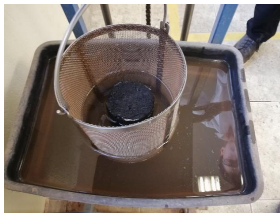
Figura 158: Especímen sumergido en agua
