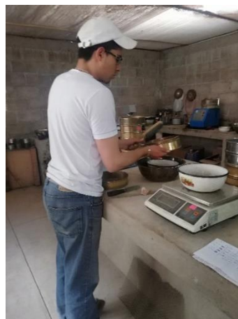
Figura 113: Tamizado y peso final
