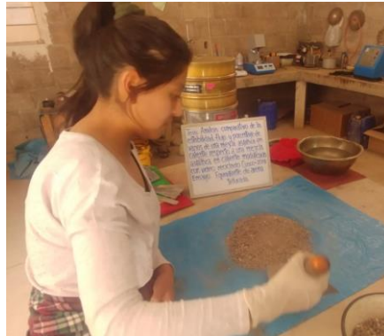
Figura 114: Cuarteo de material
