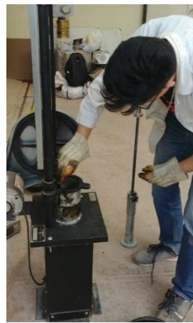
Figura 134: Chuseado de la mezcla asfáltica
