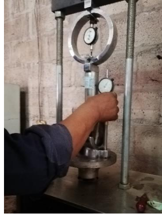
Figura 165: Colocación del dial de deformaciones
