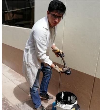
Figura 128: Extracción del asfalto para ser calentado
