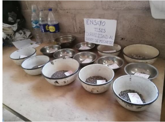
Figura 106: Muestras ya tamizadas
