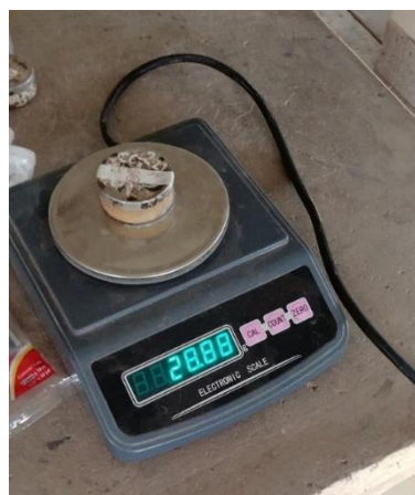
Figura 96: Peso antes de llevar la muestra al horno
