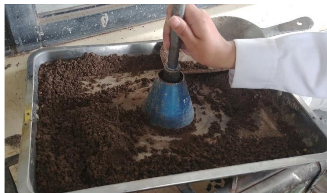
Figura 79: Prueba con el molde metálico para saber si la arena esta superficialmente seca
