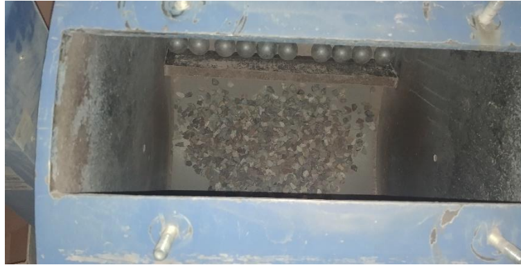
Figura 48: Colocación del agregado y las billas en la máquina de los Ángeles
