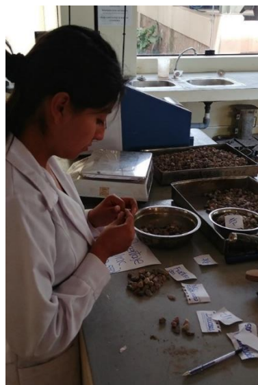
Figura 51: Inspección de caras fracturadas
