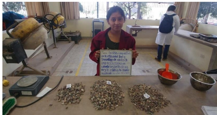
Figura 37: Granulometría del agregado grueso
