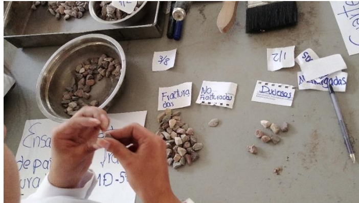
Figura 52: Clasificación de las partículas
