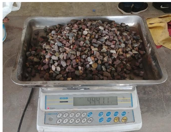
Figura 41: Peso superficialmente seco
