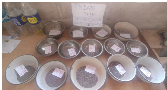
Figura 70: Muestras luego de los 5 ciclos
