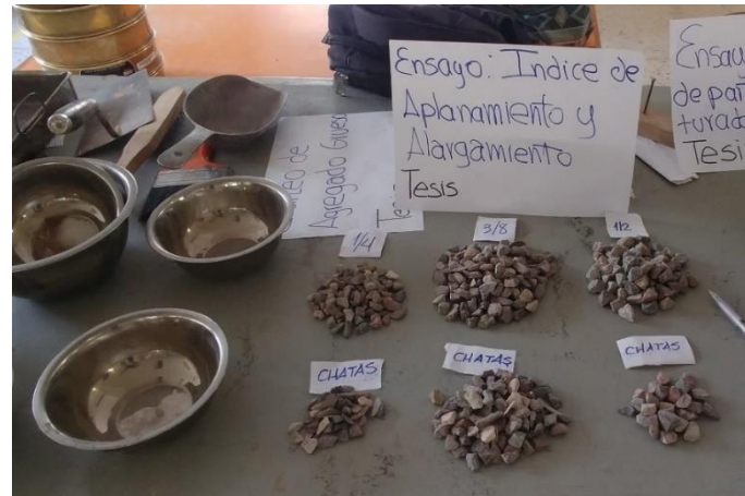
Figura 58: Clasificación de las partículas de cada tamiz
