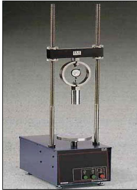
Figura 25: Máquina de estabilidad Marshall con anillo de carga
