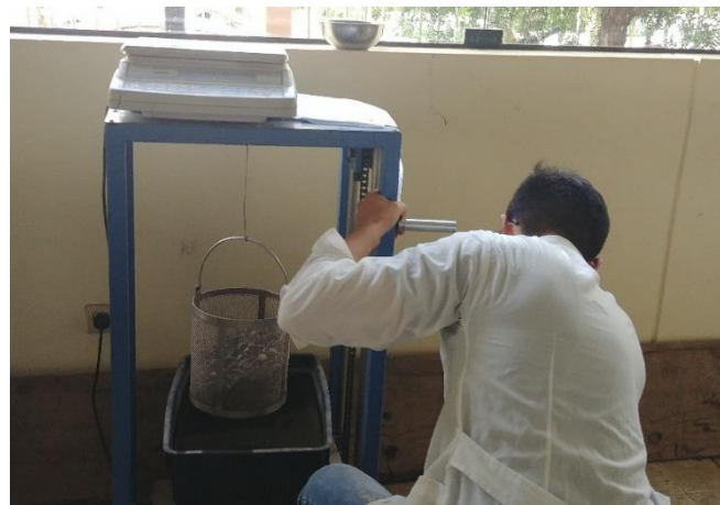
Figura 43: Canastilla metálica con agregado grueso
