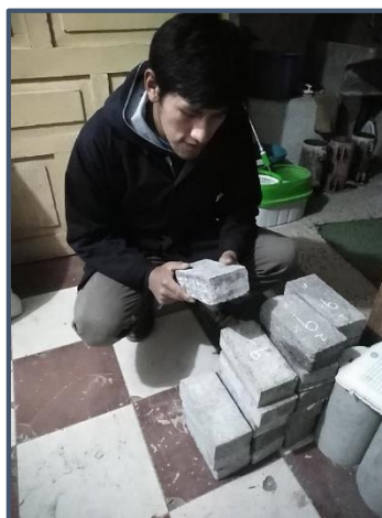
Figura 83: Habilitado de adoquines para ensayo a flexión
