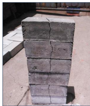
Figura 87: Adoquines después de haberse ensayado a flexión
