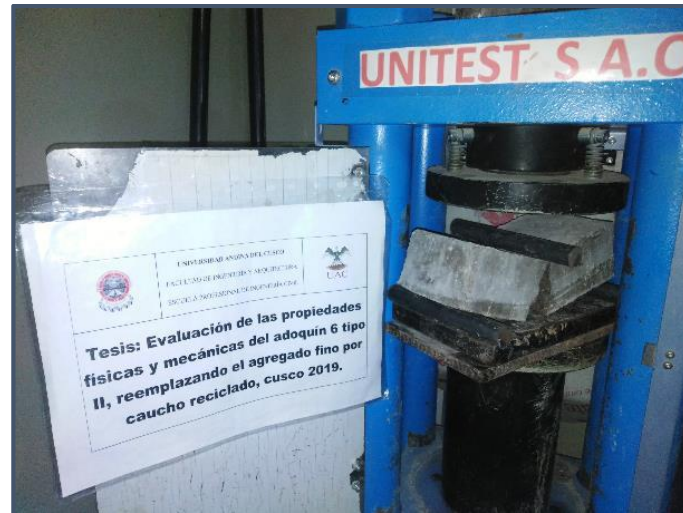
Figura 86: Adoquín luego de ensayo a flexión
