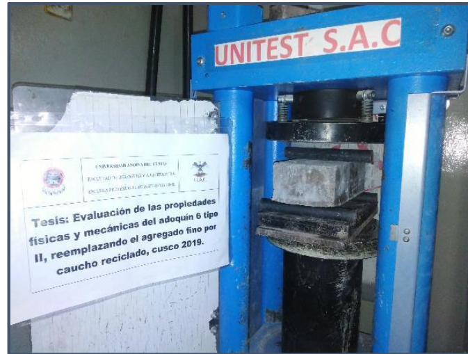
Figura 84: Adoquín en maquina para ensayo a flexión
