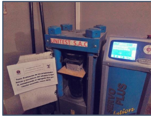
Figura 81: Máquina de resistencia a compresión en ensayo de adoquines
