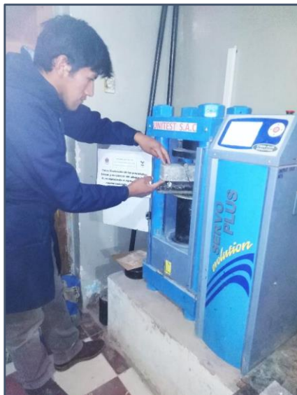
Figura 85: Tesista en ensayo de flexión de adoquín
