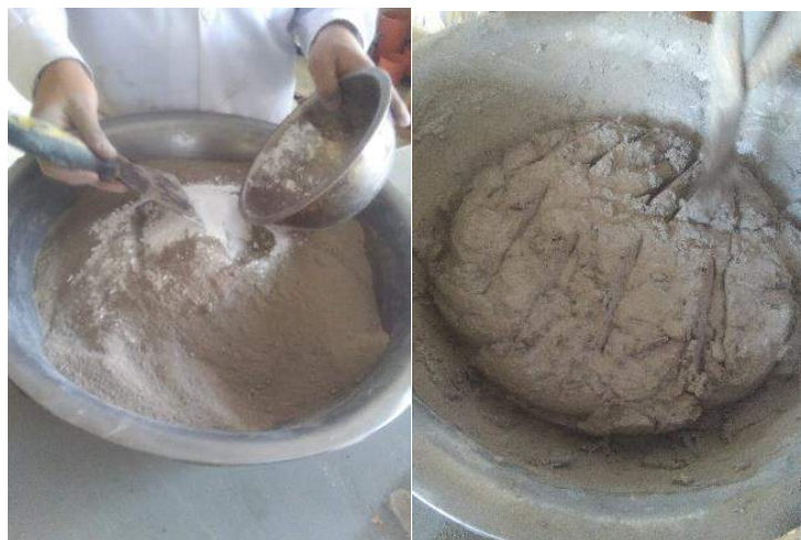
Figura 33: Mezclado de mortero según diseño
