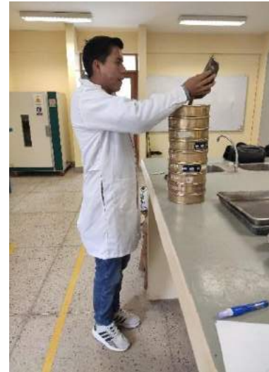
Figura 8: Tamizado mecánico del agregado fino
