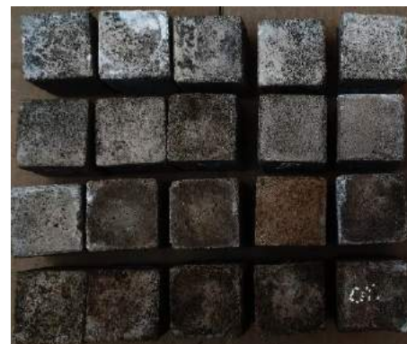
Figura 45: Imagen inicial y contrastada de probetas con dióxido de nitrógeno ( \text{NO}_2 )
