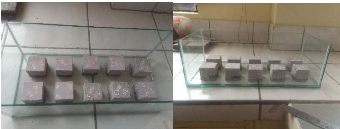
Figura 31: Colocado de probetas dentro del contenedor de absorción
