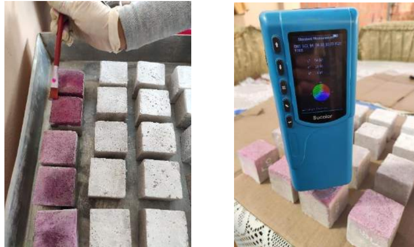
Figura 38: Aplicación de rodamina B a probetas de morteros: patrón y modificado al 3%, 5% y 7% de TiO 2
