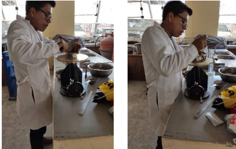
Figura 23: Colocado y apisonado del mortero dentro del anillo cónico
