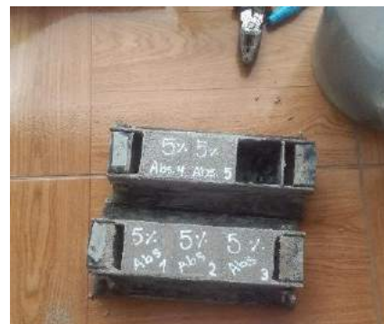
Figura 27: Colocado y elaboración de probetas de mortero
