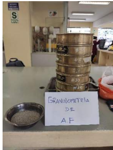
Figura 8: Tamizado mecánico del agregado fino
