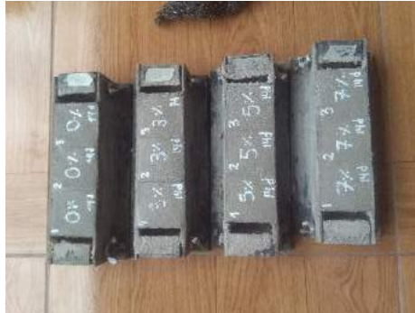
Figura 28: Elaboración de probetas de mortero en porcentajes de 3%,5% y 7%
