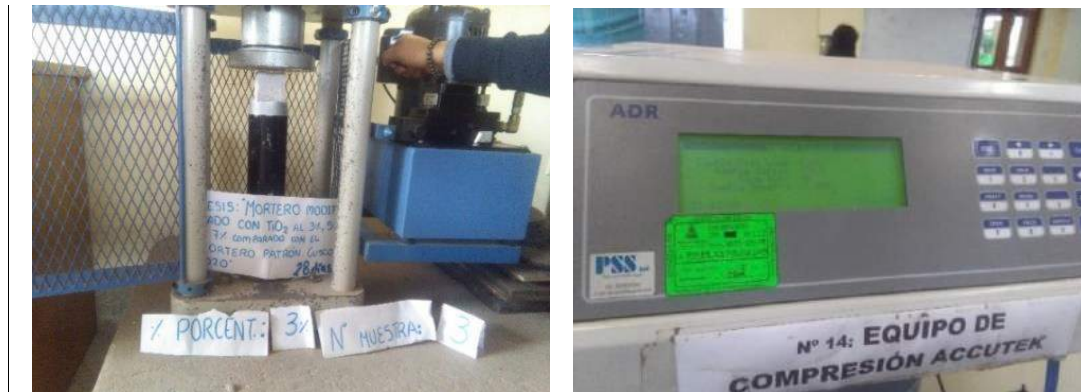
Figura 30: Rotura de probeta adicionada con 3% de TiO 2 curado durante 28 días
