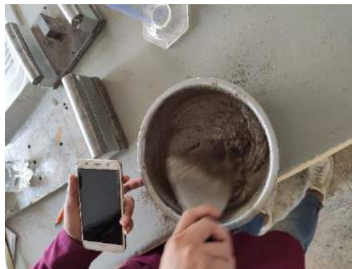
Figura 22: Preparado del mortero para la verificación de fluidez
