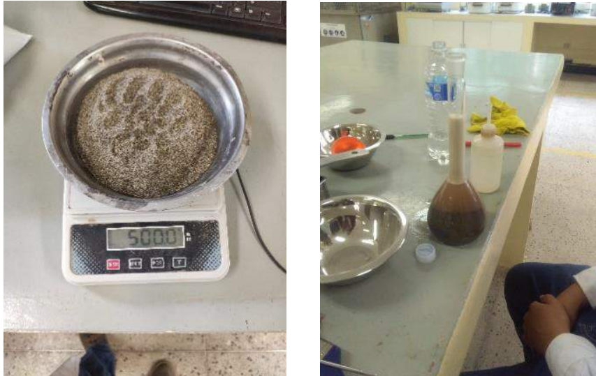
Figura 17: Pesado y colocado del agregado al interior del picnómetro
