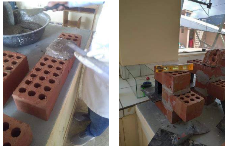
Figura 34: Colocado de mortero para la formación de probetas de ladrillo
