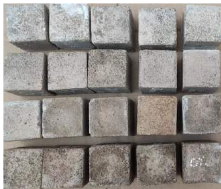
Figura 45: Imagen inicial y contrastada de probetas con dióxido de nitrógeno ( \text{NO}_2 )
