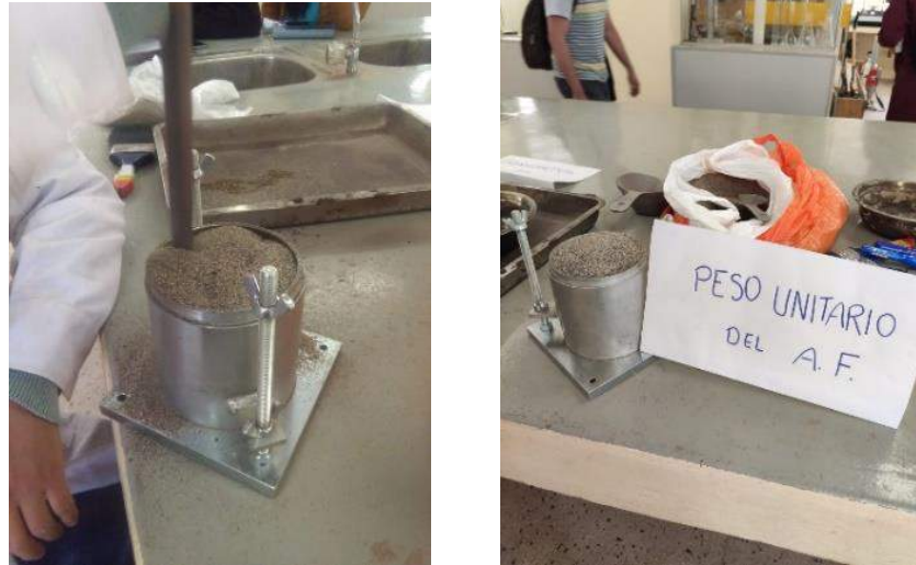
Figura 13: Apisonado del agregado fino con 25 golpes
