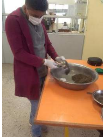
Figura 26: Preparación de mezcla de mortero
