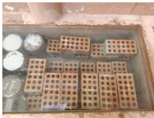
Figura 35: Curado de probetas de ladrillos
