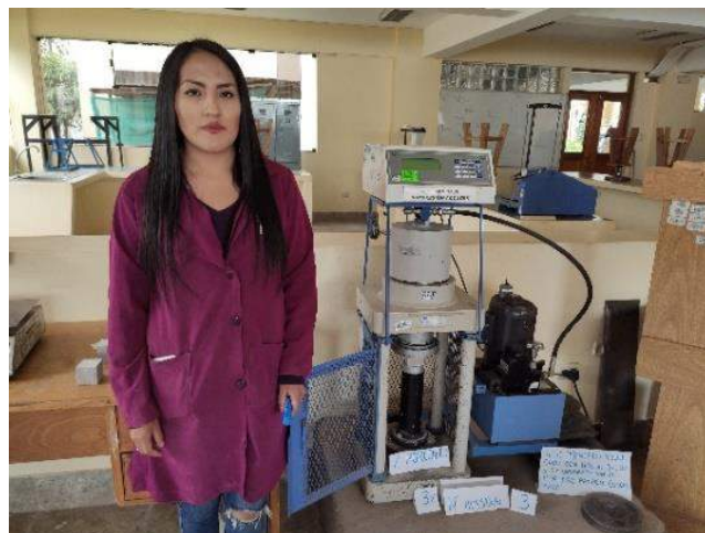
Figura 29: Tesista realizando el ensayo "resistencia a compresión"
