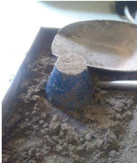
Figura 16: Apisonado de agregado fino superficialmente seco
