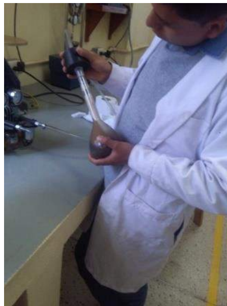
Figura 18: Extracción de vacíos, mediante la bomba
