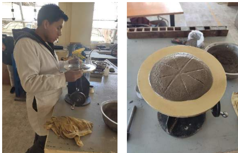
Figura 24: Toma de mediciones del mortero sobre la mesa de fluidez
