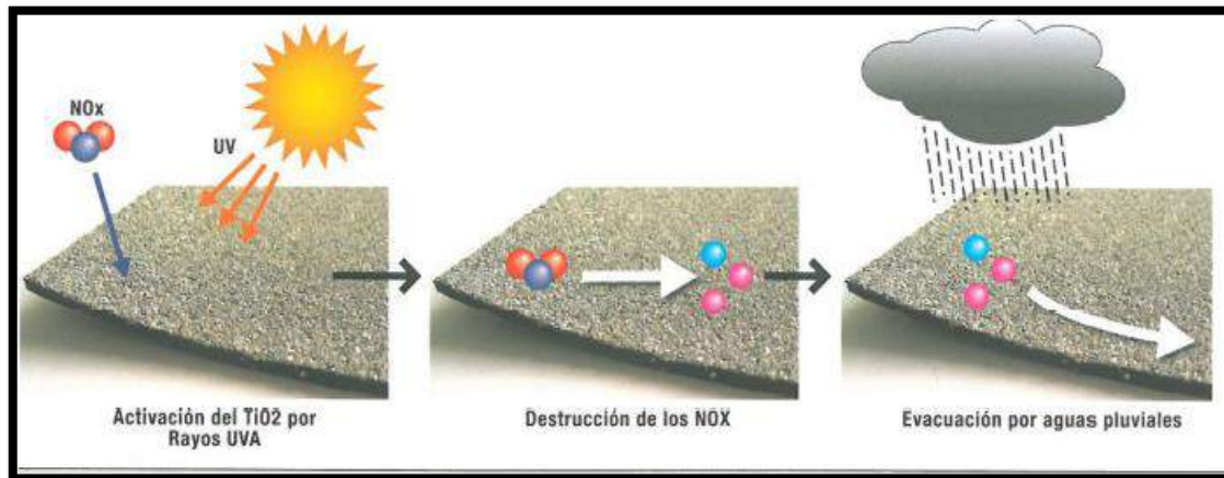
Figura 1: Fotocatálisis -Degradación de agentes contaminantes atmosféricos
