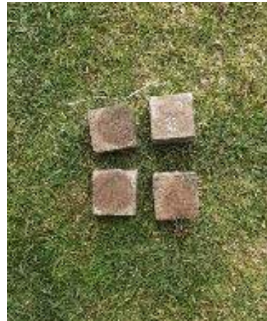
Figura 44: Exposición de probetas con dióxido de nitrógeno ( \text{NO}_2 )
