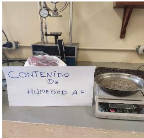
Figura 19: Pesado de agregado fino a humedad natural
