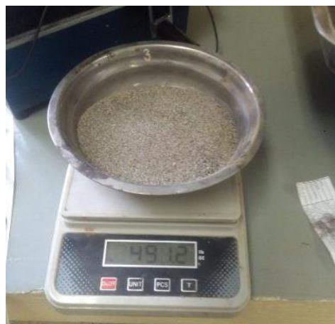
Figura 20: Pesado de agregado fino después de secado al horno
