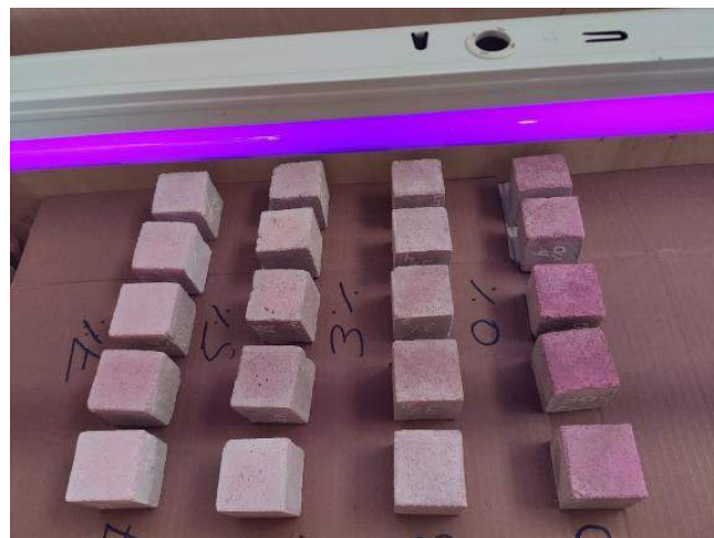
Figura 39: Exposición de probetas a rayos UV
