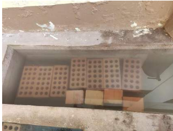
Figura 32: Saturado de ladrillos durante 30 minutos
