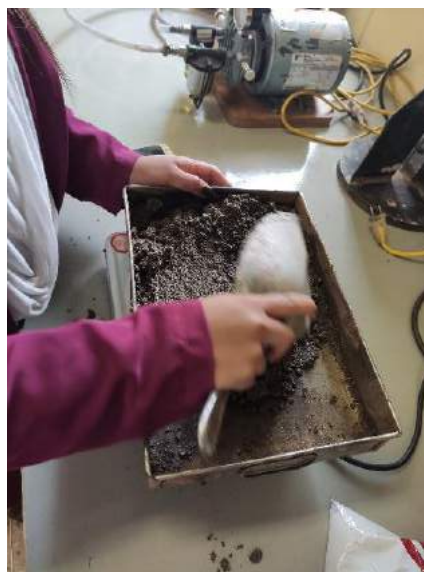
Figura 15: Secado superficialmente seca de agregado fino
