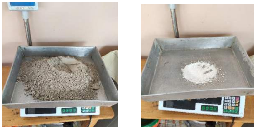
Figura 25: Pesado de cemento y dióxido de titanio según diseño de mezcla
