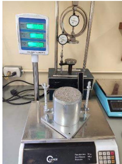
Figura 12: Pesado de molde con el agregado fino
