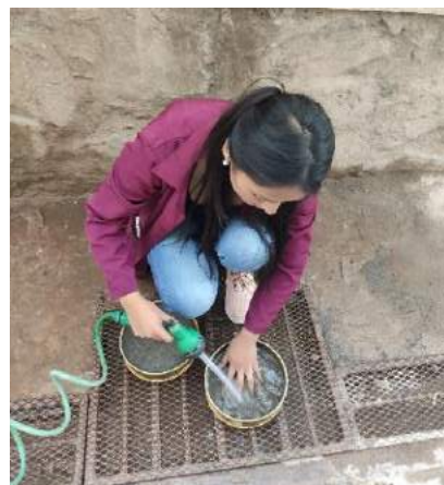
Figura 10: Lavado de arena fina mediante el tamiz N° 200
