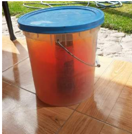
Figura 44: Exposición de probetas con dióxido de nitrógeno ( \text{NO}_2 )
