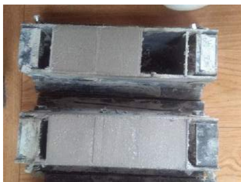
Figura 27: Colocado y elaboración de probetas de mortero
