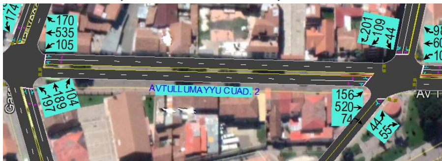
Figura 190 Modelamiento en Synchro 8 de la Av. Tullumayu cuadra 2
