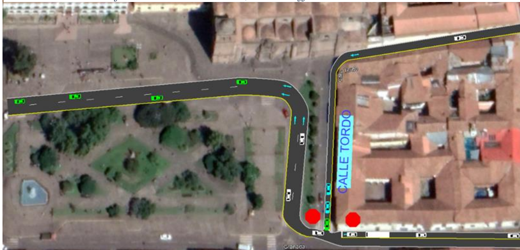
Figura 157 Simulación del Tráfico de la Calle Tordo, Sim Traffic 8
