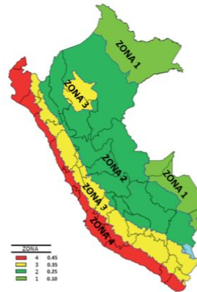
Figura 14: Zonas Sísmicas (Norma E.030 Diseño Sismorresistente, 2018)
