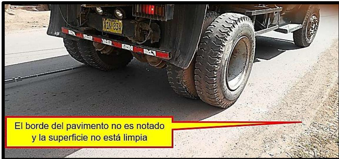
Figura 104. Toma de datos en la huella interna del camión por motivos de seguridad o limpieza en el punto de ensayo. Fuente: Elaboración propia 2019
