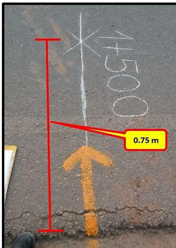
Figura 105. Ubicación del punto de ensayo a 0.75 m del borde del pavimento, en la progresiva relativa 0+500 Km. Fuente: Elaboración Propia 2019
