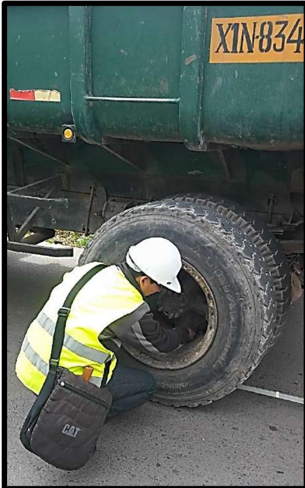
*Figura 102.* Verificación de la presión de inflado cada hora, cuyo valor debe estar entre 75-85 PSI. Fuente: Elaboración propia 2019
