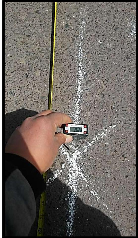
*Figura 103.* Medición de la temperatura en la superficie del pavimento con el termómetro digital de contacto directo. Fuente: Elaboración propia 2019
