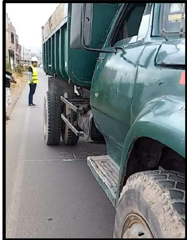
*Figura 107.* Ubicación del camión en el punto de ensayo de la progresiva relativa 2+000 km del carril de descendente. Fuente: Elaboración propia 2019
