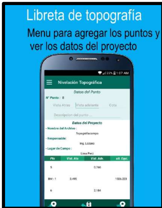
Figura 83. Libreta de campo digital, especialmente para toma de datos de una nivelación. Fuente: Google Play Store
