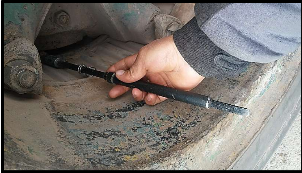
Figura 95. Inflado de llantas duales, tanto interna como externa; previo a la etapa de campo, a una presión de 80 PSI. Fuente: Elaboración propia 2019
