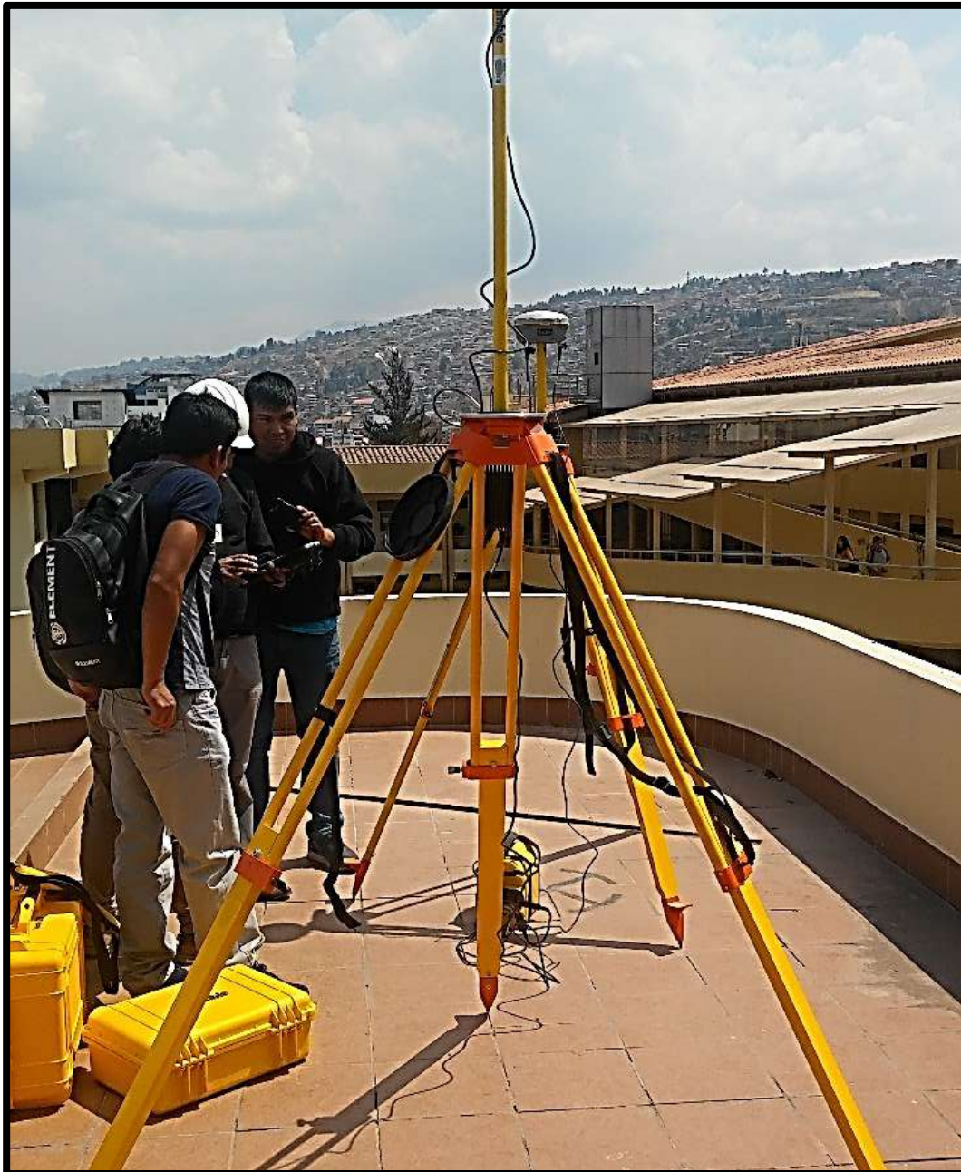
Figura 51. Armado de la Radio UHF en la Universidad Andina del Cusco. Fuente: Elaboración propia 2019
