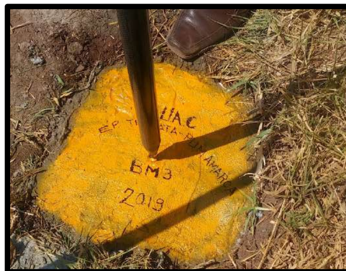
Figura 56. Posicionamiento del ROVER en la varilla en el monumentado del punto de control geodésico. Fuente: Elaboración propia 2019
