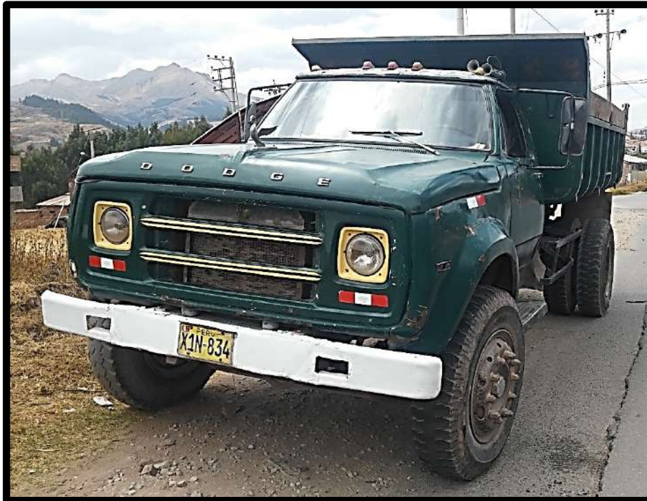
Figura 85. Camión de prueba para evaluación estructural del pavimento flexible, placa X1N – 834, con un cubicaje de 6 m 3 . Fuente: Elaboración propia 2019
