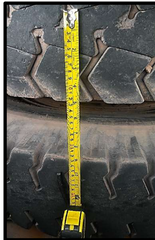
Figura 86. Espaciamiento de 32 cm, entre los ejes de las ruedas duales en el eje posterior. Fuente Elaboración propia 2019
