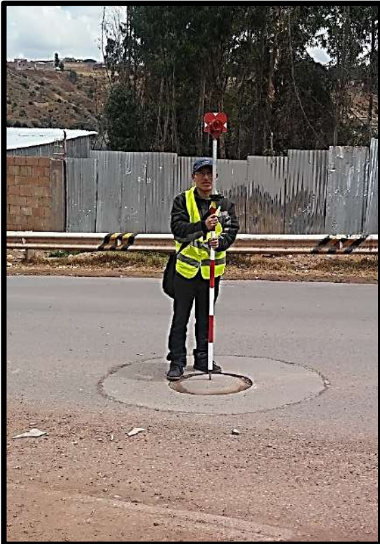
Figura 59. Disparó con láser de la Estación Total al prisma ubicado en buzones, alcantarillas y otros detalles. Fuente: Elaboración propia 2019
