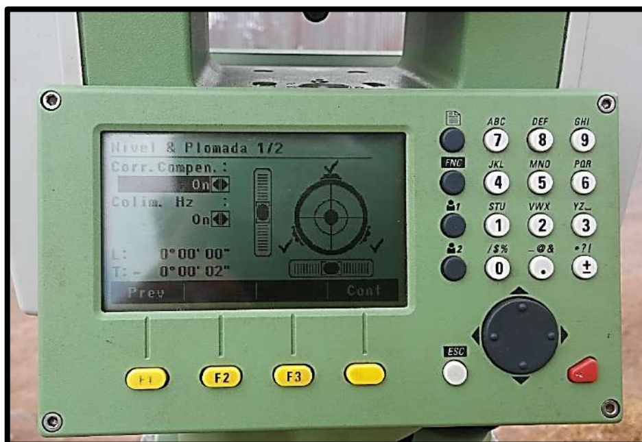
Figura 58. Colocando en posición horizontal con el Nivel & Promada de la Estación Total Leica TS06 PLUS. Fuente: Elaboración propia 2019
