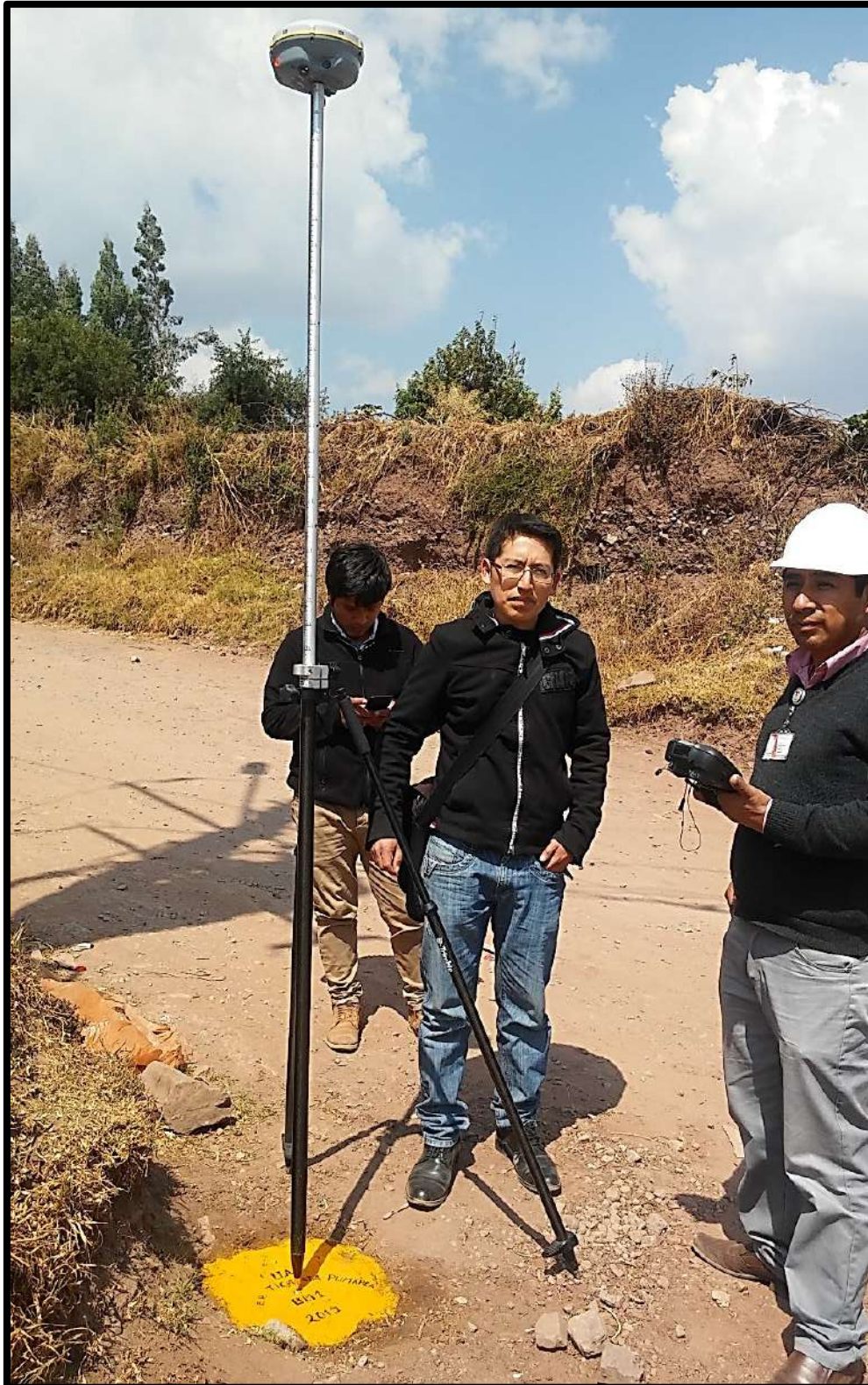
Figura 53. Toma de datos GNSS estático del punto de control geodésico P.C.1 Sector de T'icapata en la progresiva 1+833 km de la Carretera ENACO – Abra Ccorao. Fuente: Elaboración propia 2019
