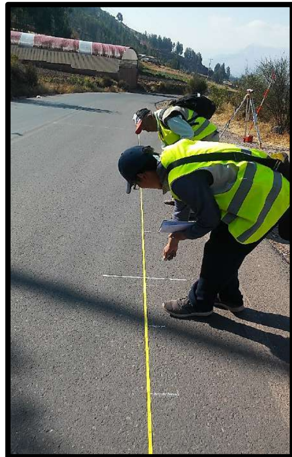
Figura 78. Marcado con tiza a un intervalo de 0.5 m en la unidad de muestreo de 15 m. Fuente: Elaboración propia 2019
