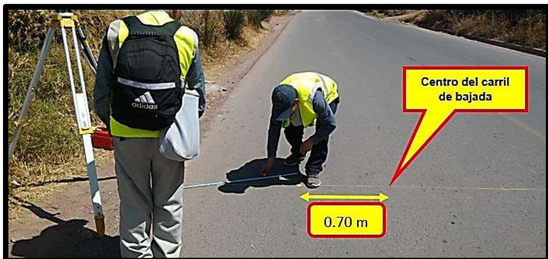
Figura 71. Ubicación del punto de inicio a 0.70 m del centro del carril de descendente en la carretera ENACO – Abra Ccorao. Fuente: Elaboración propia 2019
