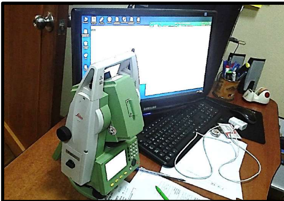
Figura 64. Cargado de las coordenadas obtenidas en el Civil 3D 2018 a la base de datos de la Estación Total Leica TS06 PLUS, para los replanteos en el gabinete de topografía. Fuente: Elaboración propia 2019
