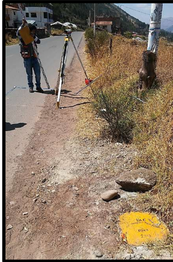
Figura 75. Inicio de la nivelación cerrada en el P.C.3 de la CC. De Pumamarca. Fuente: Elaboración propia 2019
