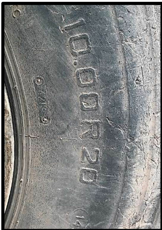
Figura 87. Llantas duales de 1000 x 20 o 10"x20" en el eje posterior. Fuente: Elaboración propia 2019
