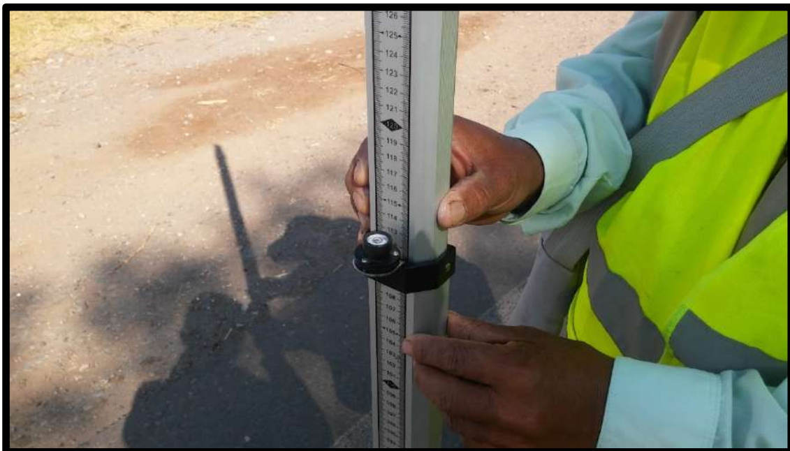
Figura 80. Burbuja nivelante acoplada a la mira, para evitar el error introducido en la desviación de la mira de la verdadera línea vertical. Fuente: Elaboración propia 2019.
