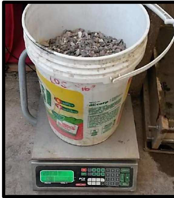
Figura 90. Prueba aproximativa in situ de la venta de materiales de construcción, del peso unitario suelto de la piedra chancada de 1/2 ". Fuente: Elaboración propia 2019
