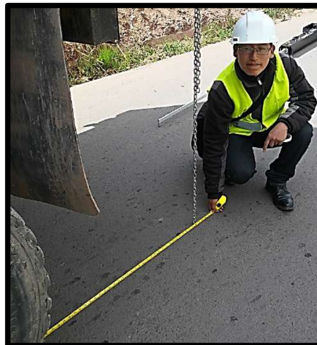
Figura 97. Medición de eje de llantas hasta el extremo de la cadena en el pavimento. Fuente: Elaboración Propia 2019
