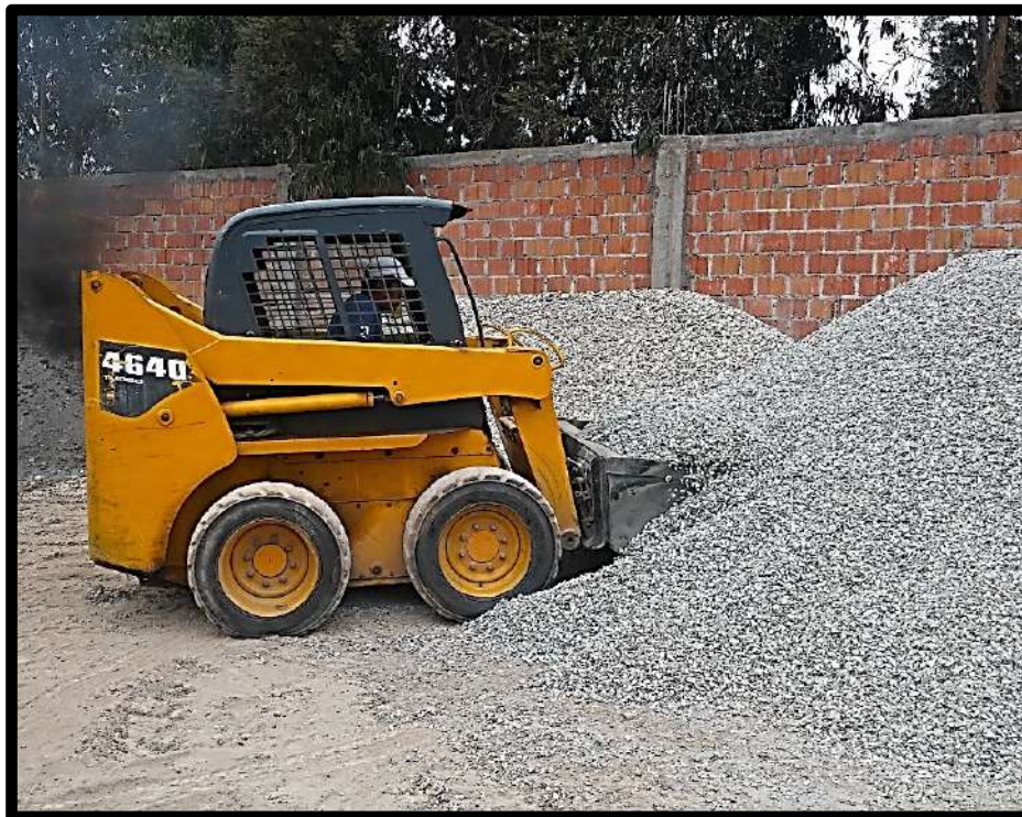
Figura 88. Piedra chancada de 1/2", con peso unitario suelto aproximado de 1450 – 1500 kg/m 3 . Fuente: Elaboración propia 2019.
