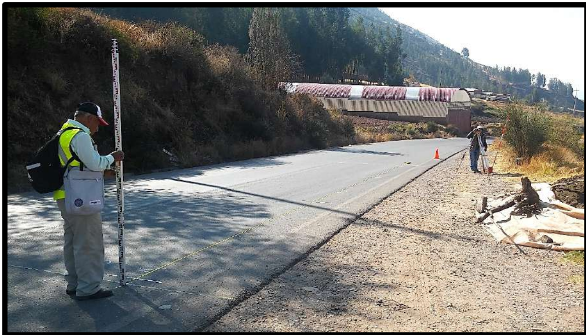
Figura 79. Toma de las vistas intermedias a 0.5 m de la línea de huella externa del neumático, con el lado milimetrodo de la mira. La distancia entre la mira y el nivel topográfico no debe de exceder de 40 metros. Fuente: Elaboración propia 2019.
