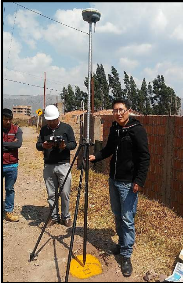
Figura 54. Toma de datos GNSS estático del punto de control geodésico P.C.2 Sector de T'icapata en la progresiva 1+943 km de la Carretera ENACO – Abra Ccorao. Fuente: Elaboración propia 2019
