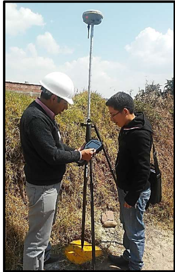
Figura 55. Toma de datos GNSS estático del punto de control geodésico P.C.2 la CC Pumamarca en la progresiva 3+834 km de la Carretera ENACO – Abra Ccorao. Fuente: Elaboración propia 2019
