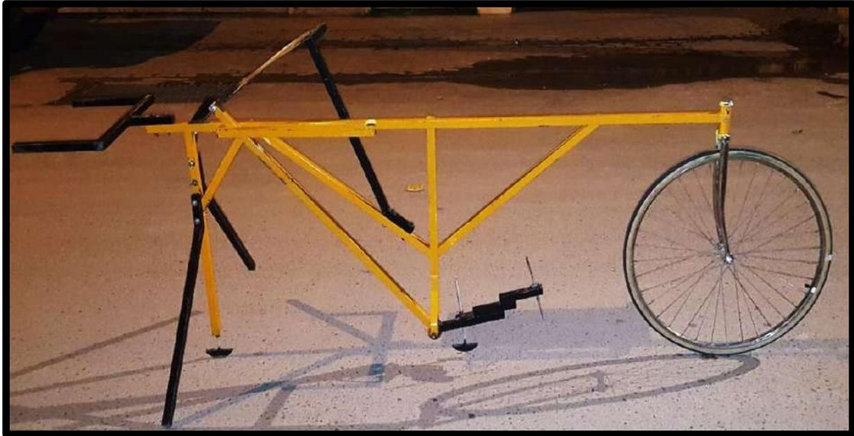
Figura 9. Rugosímetro de Merlin. Fuente: L. Hirpahuanca (Tesis de pregrado, 2016)
