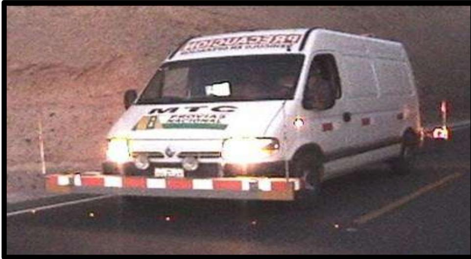
*Figura 14.* Mediciones de rugosidad con Perfilómetro Laser Dynatest Mark realizadas en una red vial nacional asfaltada. Fuente: Recuperado de M. Goicochea (Tesis de Maestría ,2013)
