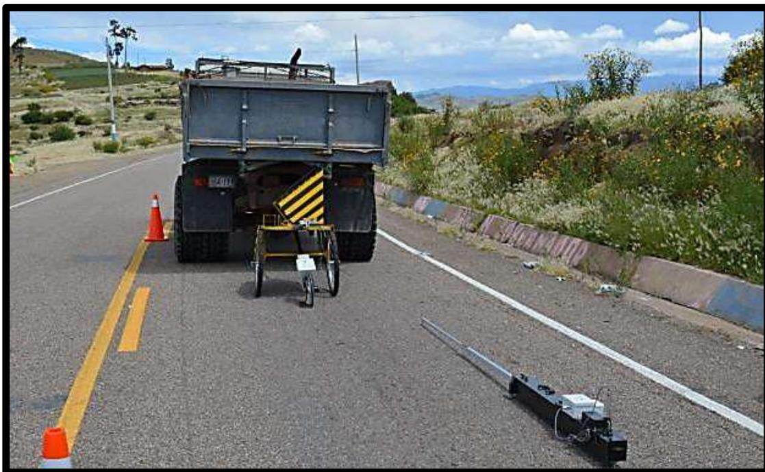
*Figura 28.* Deflectometría con la Viga Benkelman. Fuente: [www.mecanicista.com](http://www.mecanicista.com)
