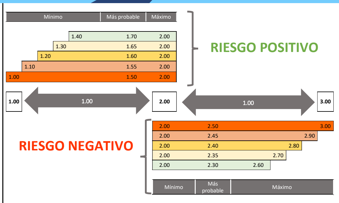
Figura 30: Diagrama ejemplo para el cálculo de C.U. mínimos, máximos y más probables de los riesgos individuales.
