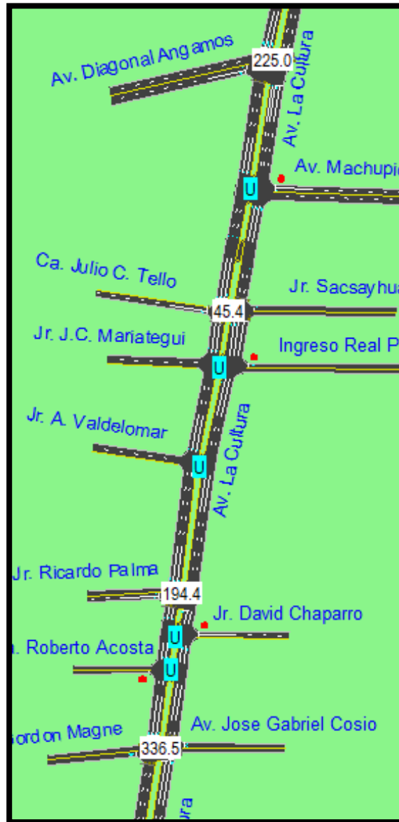
Figura 204: Demoras en las intersecciones del sistema con proyección al año 2024 sin proyecto de ampliación
