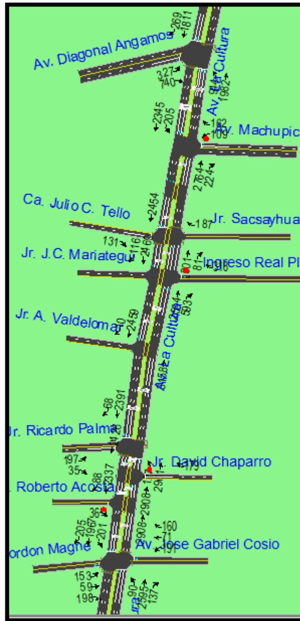
Figura 228: volúmenes vehiculares proyección año 2024 con proyecto de ampliación
