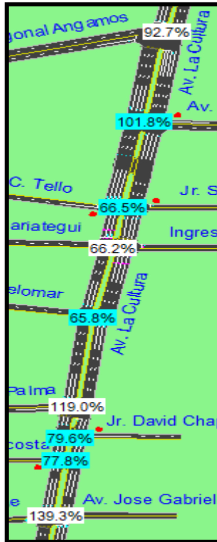
Figura 235: Tasa de utilización o saturación ICU (%) del sistema con proyección al año 2024 con proyecto de ampliación y mitigación
