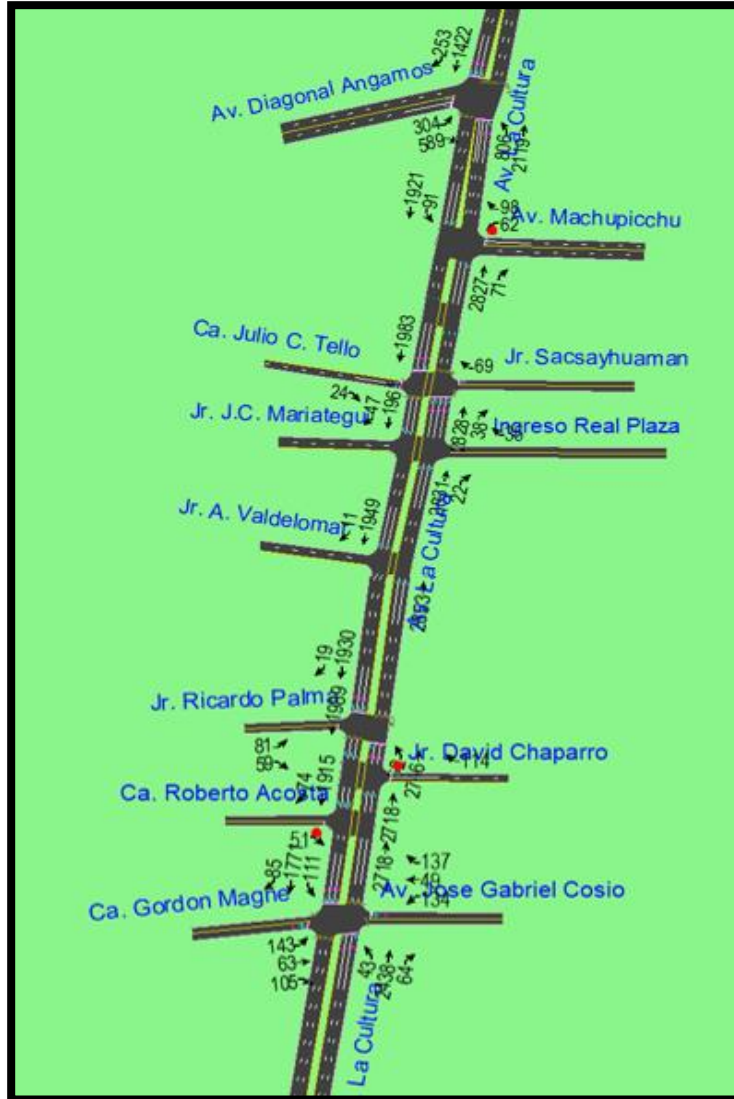
Figura 176: Volúmenes por sentido de circulación del Sistema Vial en estudio Tramo Av. La Cultura entre Av. Diagonal Angamos hasta la Av. José Gabriel y Ca. Gordon Magne (Magisterio), con sus respectivas intersecciones.
