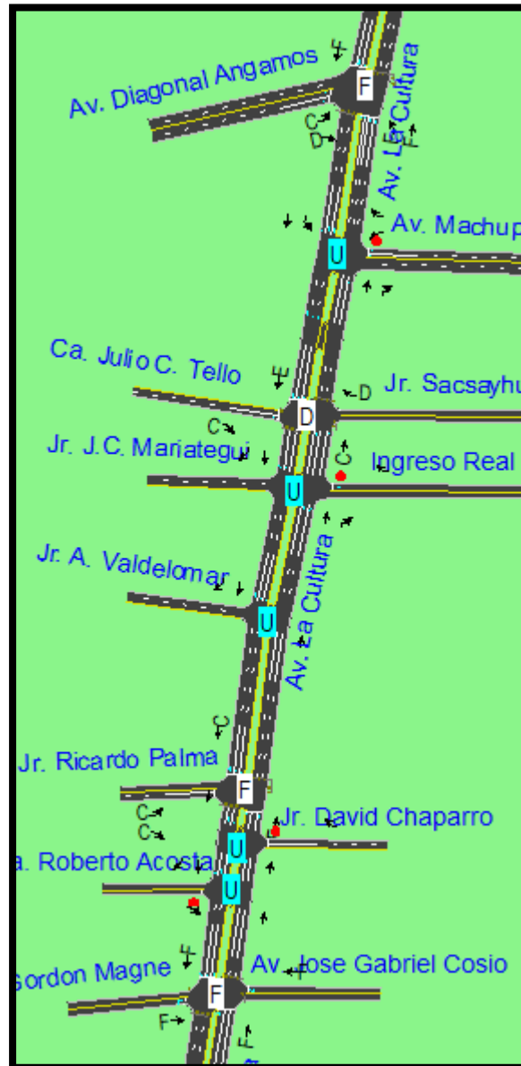
Figura 229: Niveles de Servicio en el Sistema con proyección al año 2024 con proyecto de ampliación
