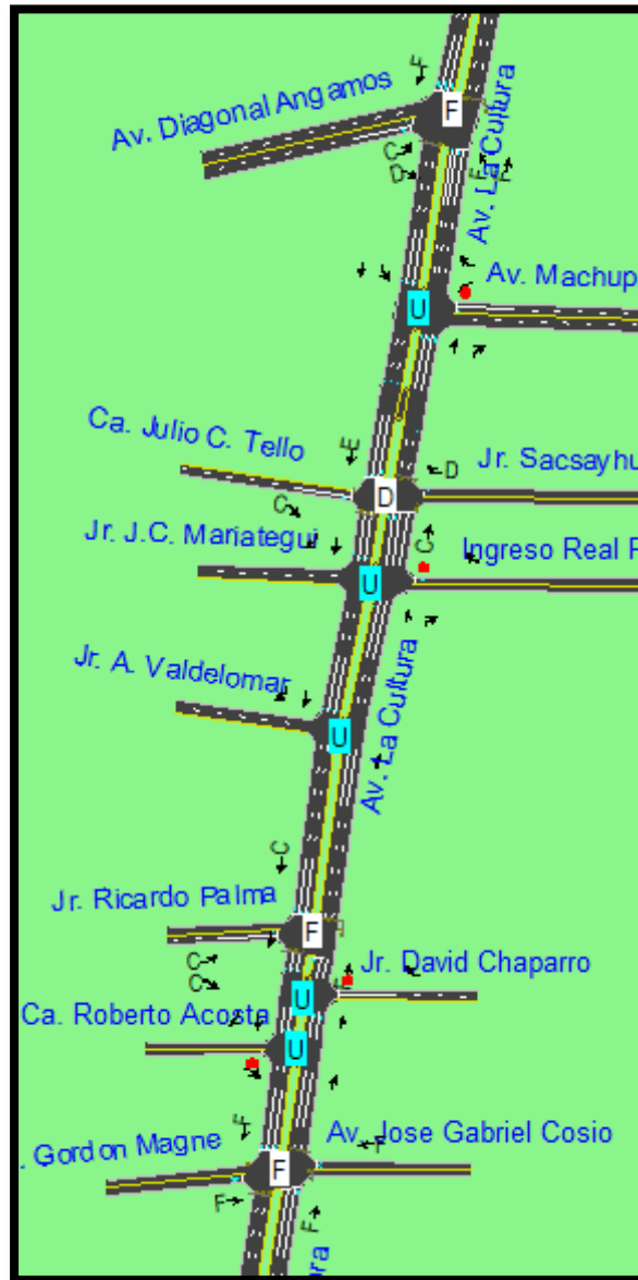
Figura 203: Niveles de Servicio en el Sistema con proyección al año 2024 sin proyecto de ampliación
