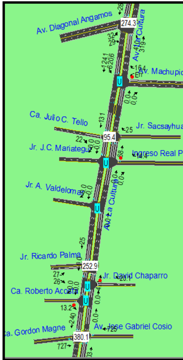
Figura 226: Demoras en las intersecciones del sistema con proyección al año 2024 con proyecto de ampliación
