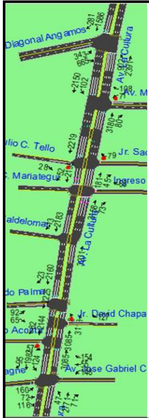
Figura 232: volúmenes vehiculares proyección año 2024 con proyecto de ampliación y mitigación
