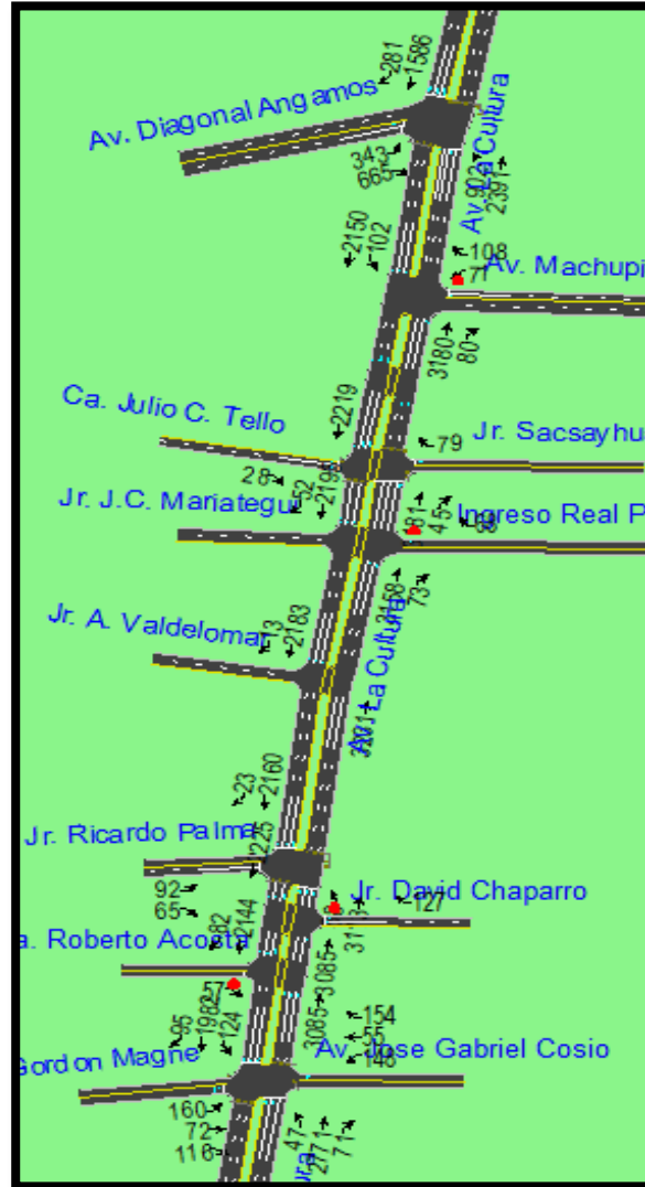
Figura 224: volúmenes vehiculares proyección año 2024 con proyecto de ampliación
