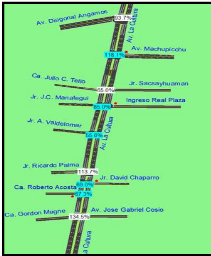
Figura 196: Tasa de utilización o saturación ICU (%) sin proyecto año 2019
