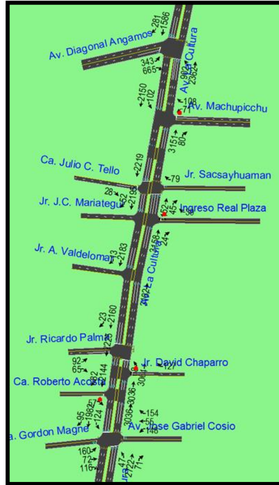
Figura 198: volúmenes vehiculares proyección año 2024 sin proyecto de ampliación
