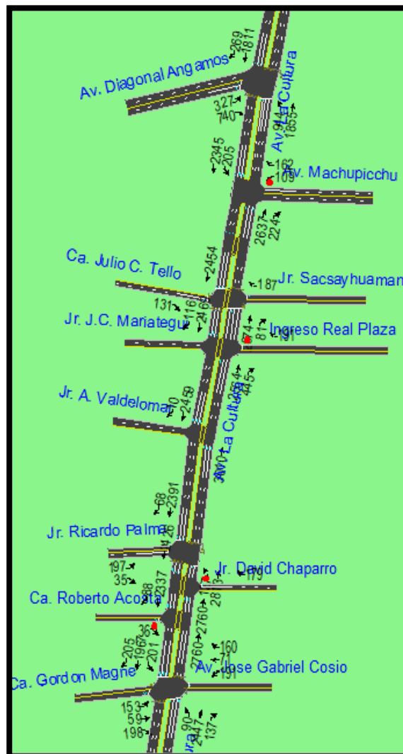
Figura 202: volúmenes vehiculares proyección año 2024 sin proyecto de ampliación
