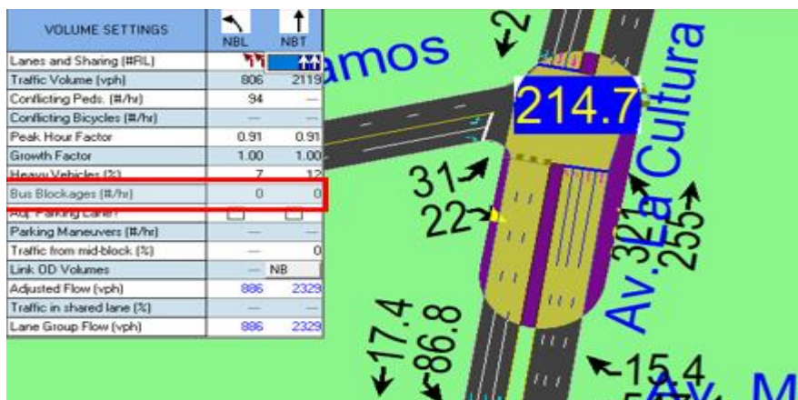
Figura 243: Demoras en intersección Av. Diagonal Angamos – Av. La Cultura sin presencia de paradero y estacionamientos
