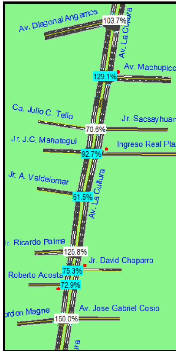
Figura 205: Tasa de utilización o saturación ICU (%) del sistema con proyección al año 2024 sin proyecto de ampliación
