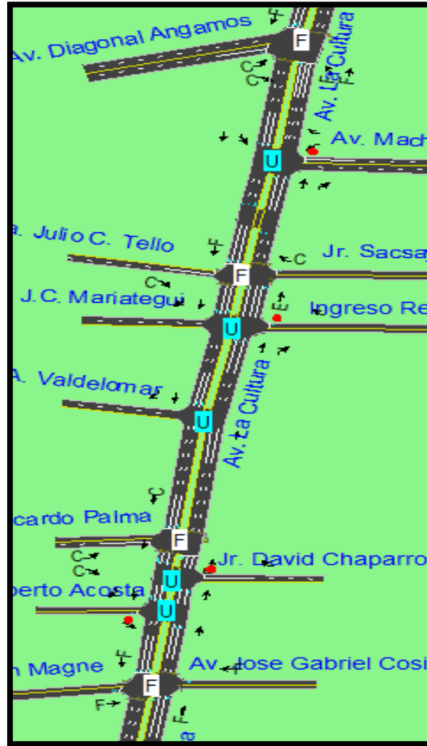
Figura 199: Niveles de Servicio en el Sistema con proyección al año 2024 sin proyecto de ampliación
