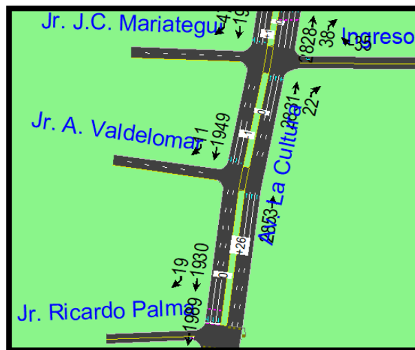
Figura 179: Desbalance de volúmenes vehiculares nodos del 6 al 8
