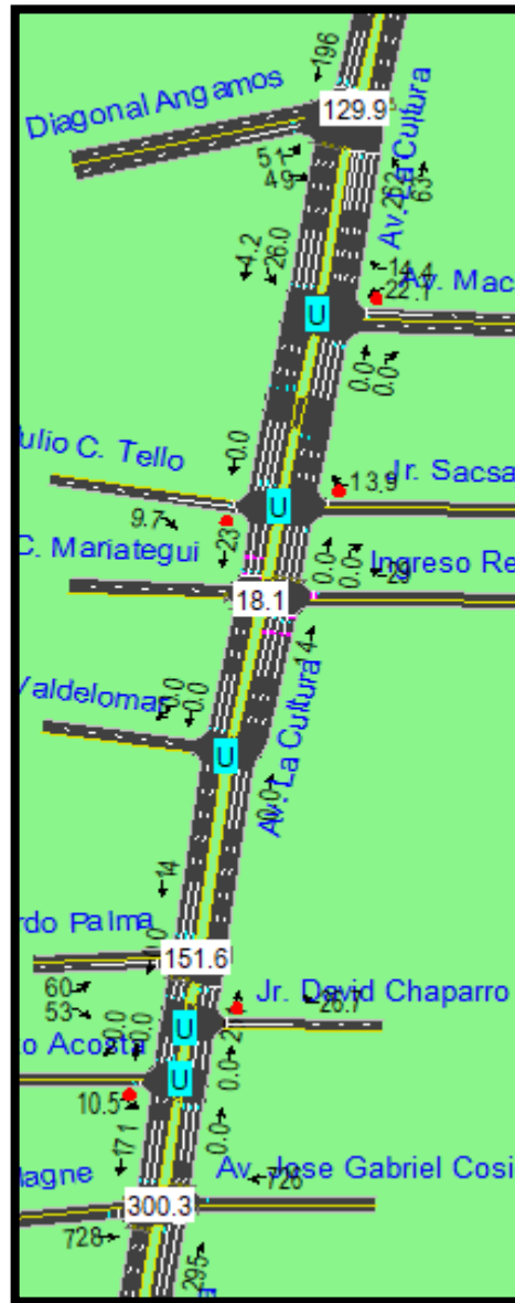
Figura 234: Demoras en las intersecciones del sistema con proyección al año 2024 con proyecto de ampliación y mitigación
