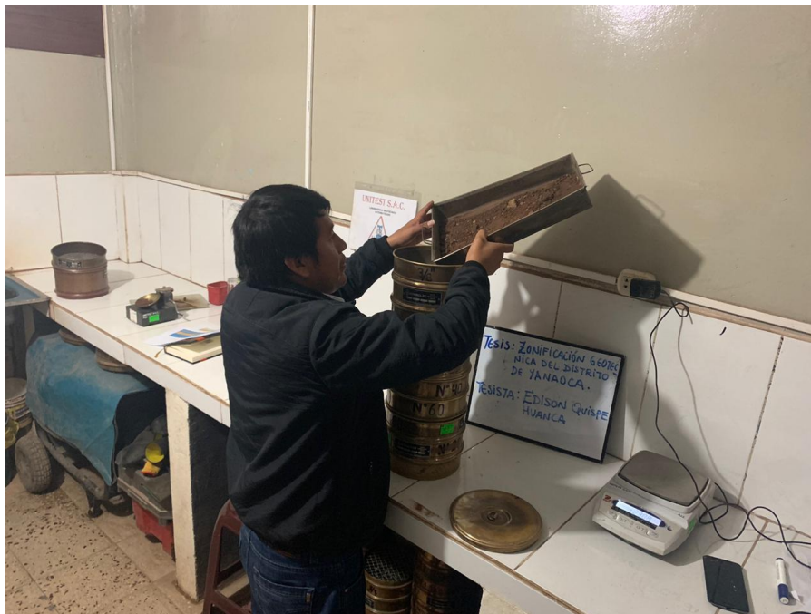
Figura 35.Tamizado para la obtención de la granulometría, realizada en el laboratorio Fuente: Elaboración Propia
