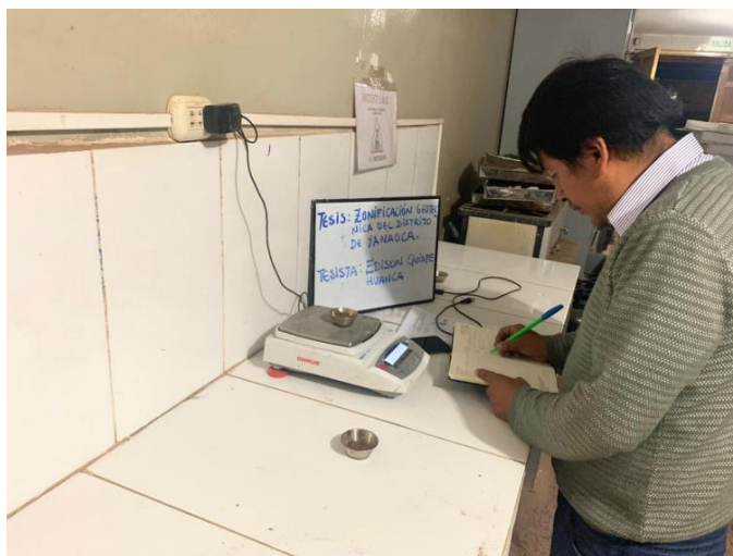
Figura 44. Toma de datos para el contenido de humedad Fuente: elaboración propia
