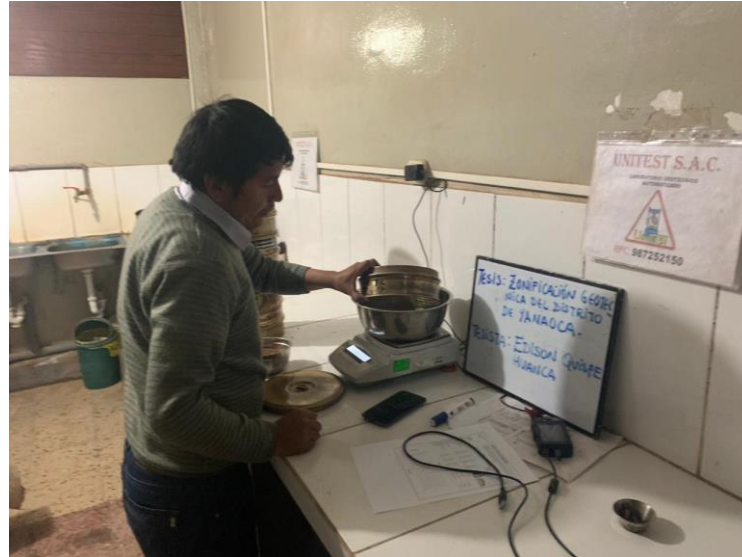
Figura 36. Pesaje de las proporciones obtenidas después del tamizado Fuente: elaboración propia
