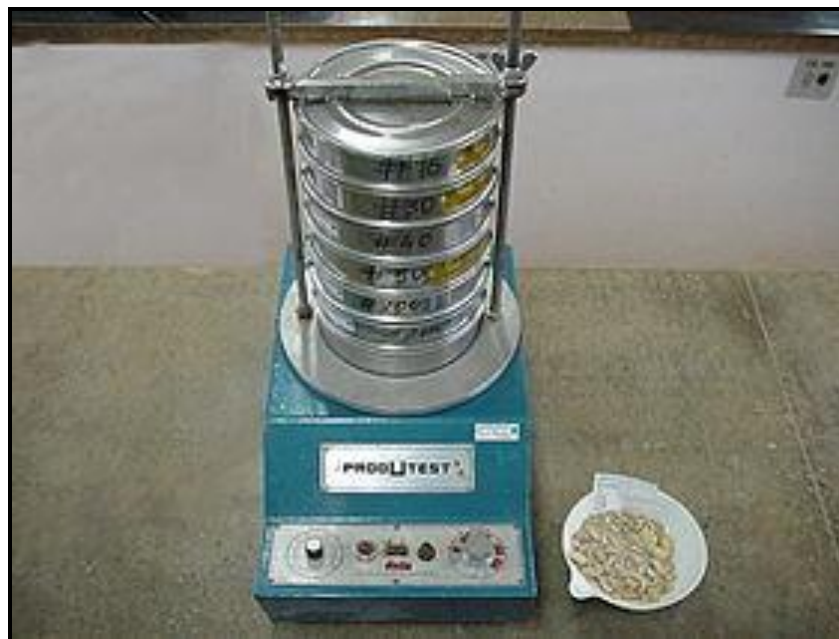
Figura 29. Análisis Granulométrico por Tamizado Fuente: T. William Lambe. Robert v. Whitman. Mecánica de Suelos.
