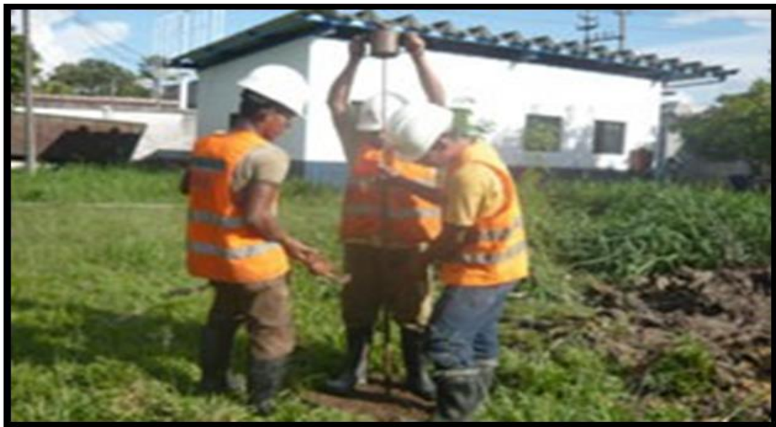
Figura 9. Ensayo Incito con PDC ligero
