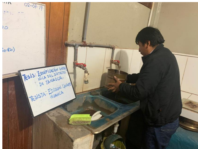
Figura 33. lavado de la muestra en el tamiz N° 200 Fuente: elaboración propia
