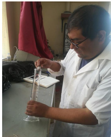
Figura 74. Determinación del volumen desplazado de la muestra de suelo con parafina
