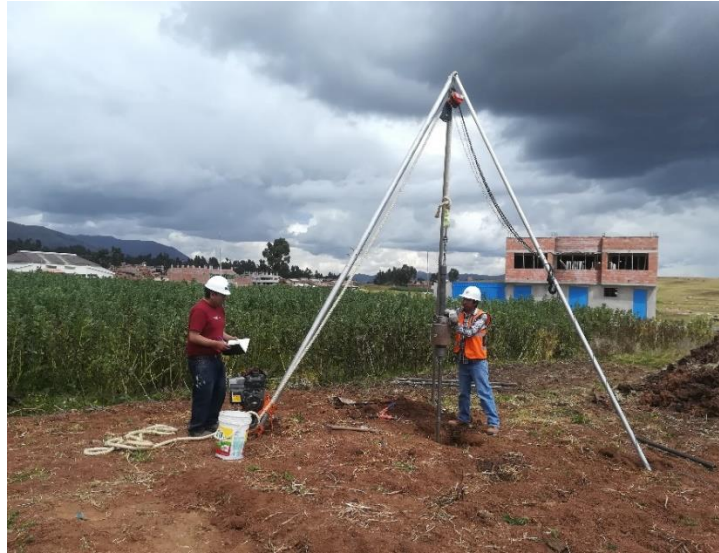
Figura 84. Inicio del ensayo de SPT
