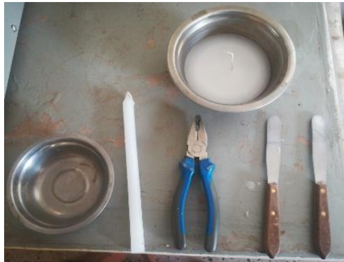
Figura 68. Materiales y herramientas para el ensayo del peso volumétrico del suelo
