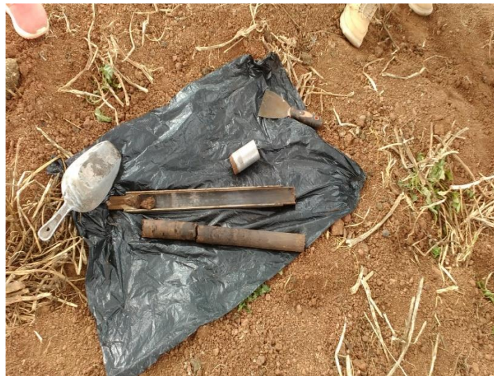
Figura 85. Muestra de suelo del ensayo SPT
