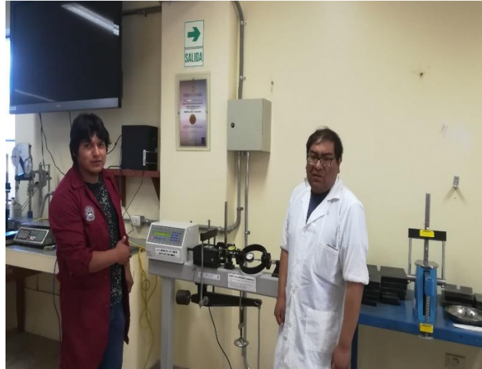
Figura 79. Procedimiento de ensayo de corte directo mediante el equipo de corte
