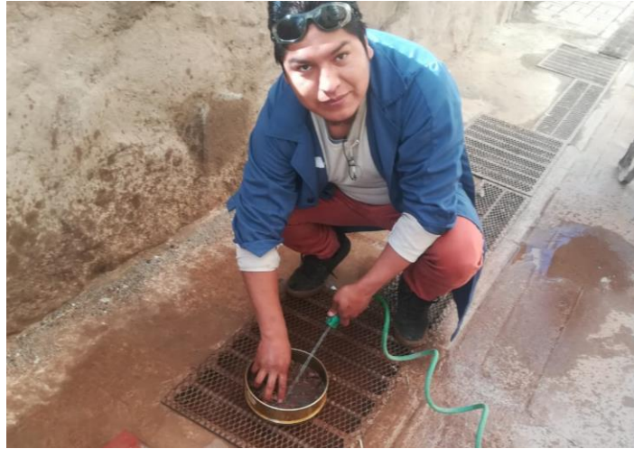
Figura 75. Lavado de material a través del tamiz N° 200
