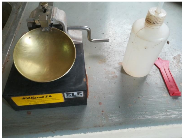
Figura 59. Cuchara de Casagrande para determinar el límite líquido
