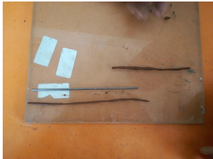
Figura 66. Rollos de muestra de suelo que alcanza un diámetro de 3.2 mm
