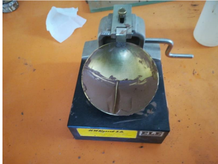
Figura 62. Cierre del surco en la cuchara de Casagrande para el ensayo de límite líquido
