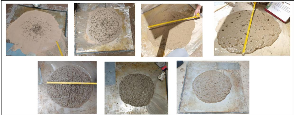
Figura 73: *Consistencia y cohesividad de las mezclas de prueba de menos estable a estable (izquierda a derecha)*
