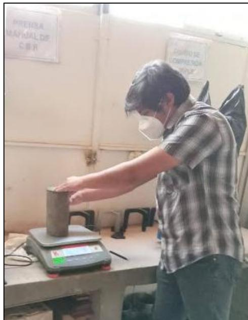
Figura 60: *Determinación del peso de las briquetas de CAC.*
