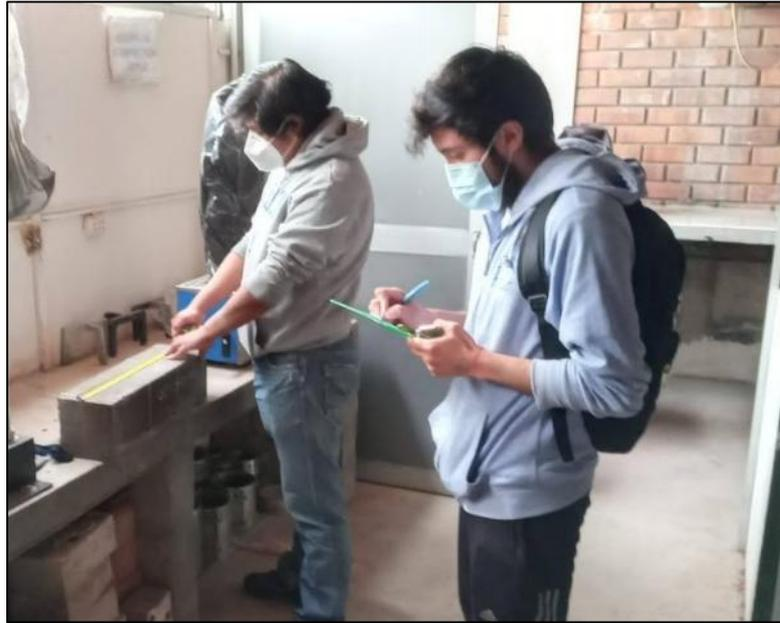
Figura 66: *Registro de las dimensiones de las viguetas.*
