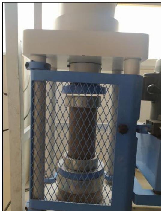
Figura 64: *Briqueta de CAC colocada dentro de la máquina de compresión axial ara ser ensayada.*
