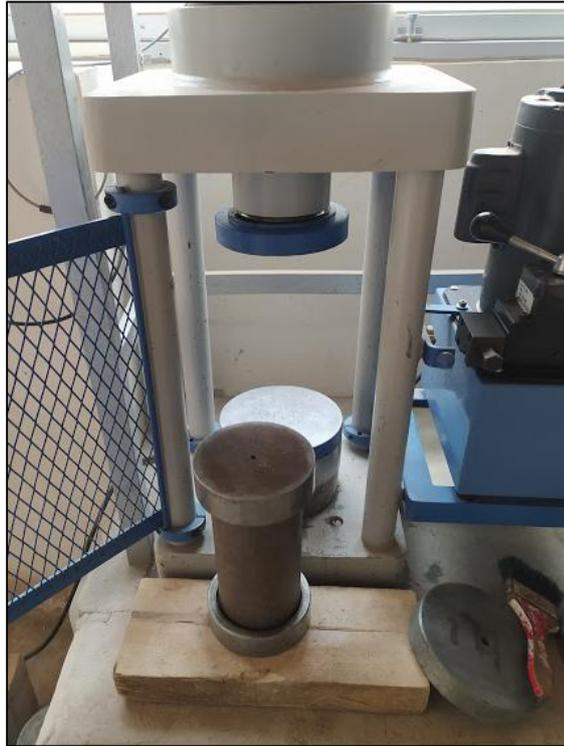
Figura 63: *Colocación de las almohadillas de neopreno a la briqueta de CAC para ser ensayada.*
