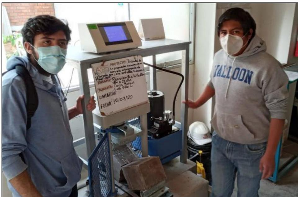
Figura 68: *Vigueta ensayada en la máquina de flexión.*
