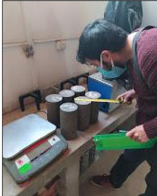
Figura 61: Determinación del diámetro de las briquetas de CAC.
