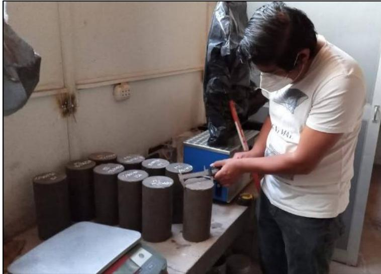
Figura 62: Registro de las medidas de las briquetas de CAC que serán ensayadas.
