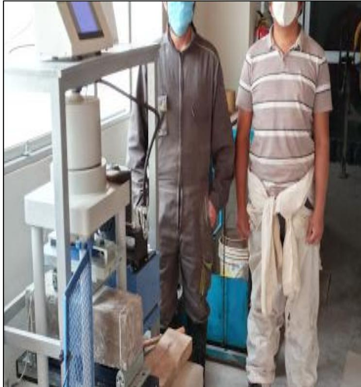
Figura 67: *Vigueta colocada en la máquina de flexión para ser ensayada.*
