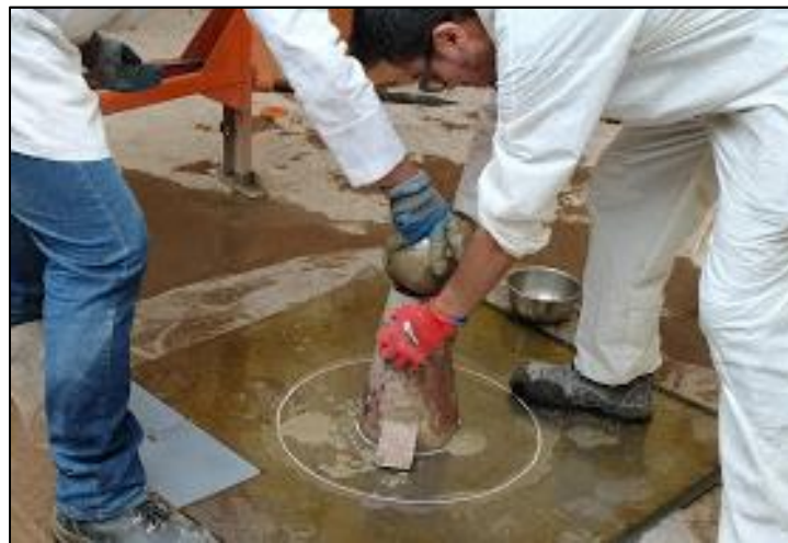
Figura 49: Colocación del concreto autocompactante en el cono de Abrams.
