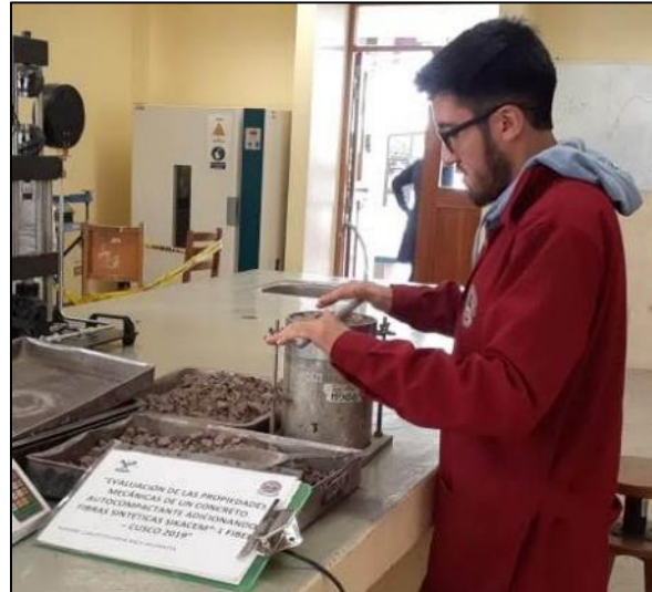
Figura 38: Enrazado del agregado grueso en el molde metálico con la varilla de 5/8”.
