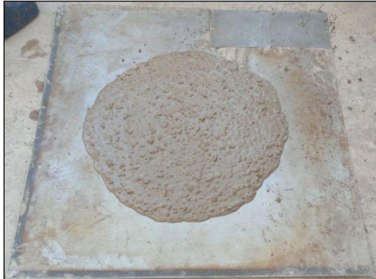
Figura 50: Asentamiento del autocompactante.
