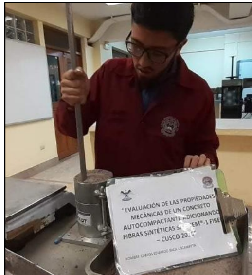
Figura 35: Compactación del agregado fino en el molde metálico con la varilla metálica de 5/8”.
