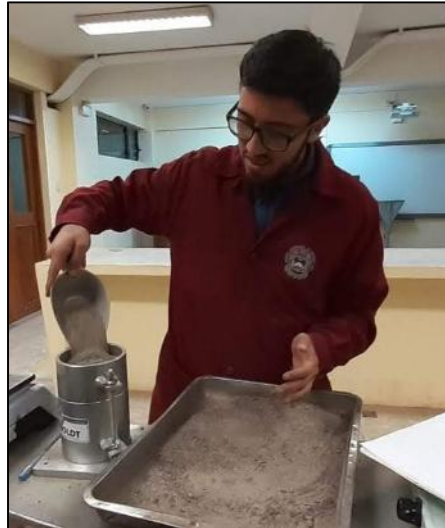
Figura 34: Colocación del agregado fino en el molde metálico.
