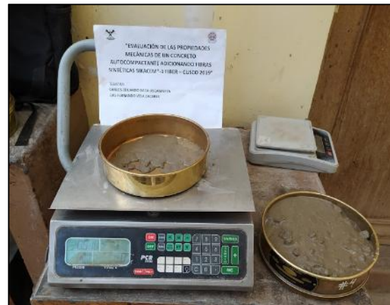
Figura 55: Determinación de la masa del fondo del tamiz con el CAC que cayó sobre él.
