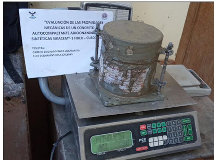
Figura 56: Toma del dato del Peso del Concreto Autocompactante en estado Fresco
