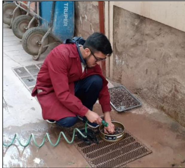
Figura 47: Lavado por la malla N° 10 del material extraído de la máquina de Los Ángeles
