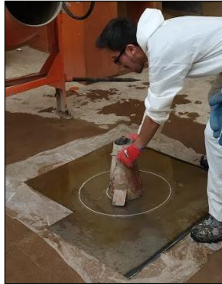
Figura 48: Colocación el cono de Abrams en el centro de la placa, marcada con un círculo concéntrico de 50cm de diámetro.
