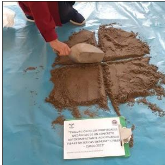
Figura 28: Muestreo de la arena fina de la cantera de Cunyac.
