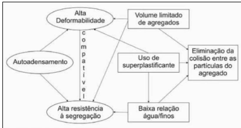
Figura 21: Método de obtención de Concreto Autocompactante
