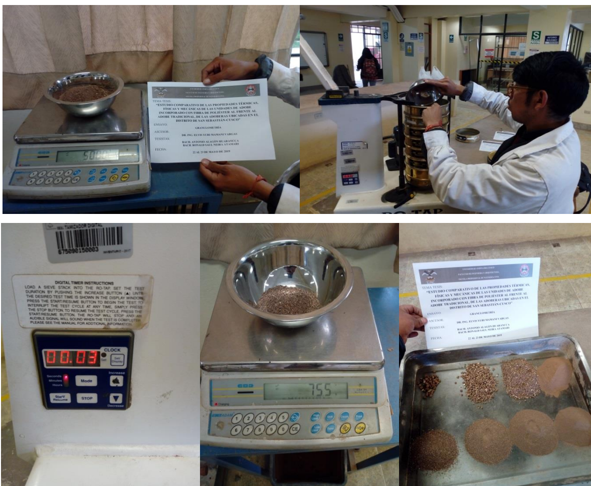
Figura 41: Procedimiento del ensayo granulométrico por tamizado
