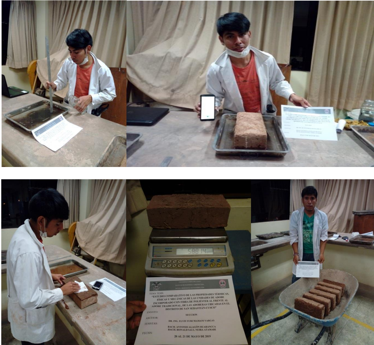
Figura 44: Procedimiento del ensayo de succión
