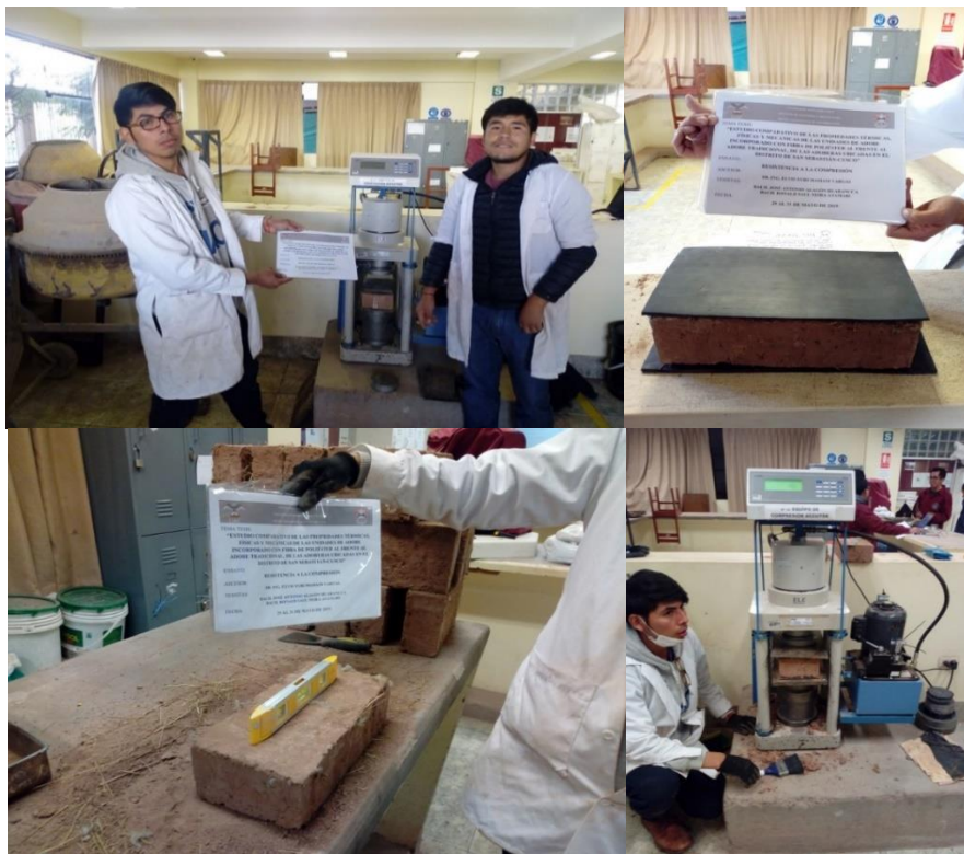
Figura 48: Procedimiento del ensayo de resistencia a la compresión
