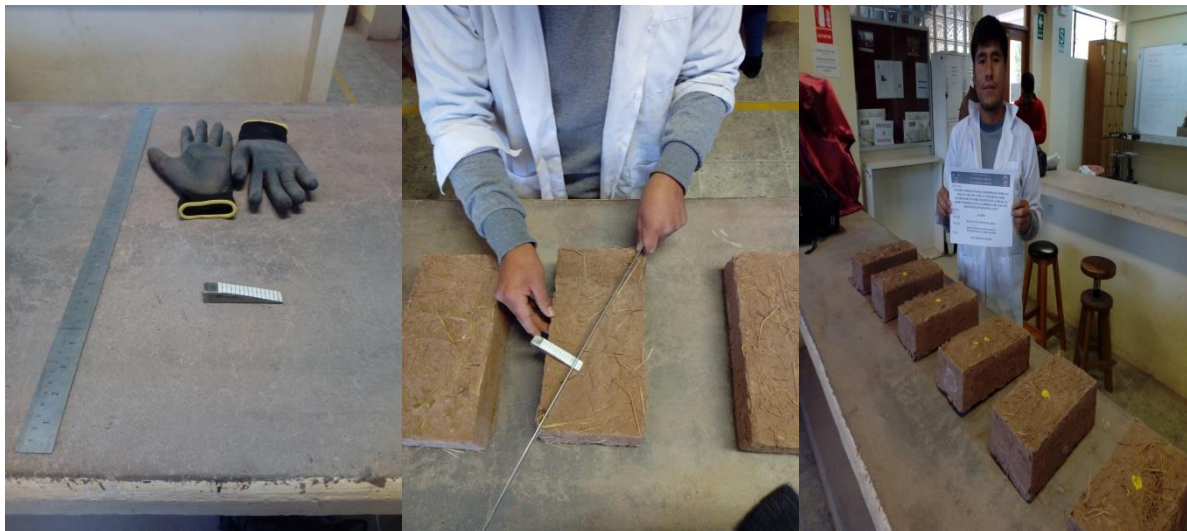
Figura 42: Procedimiento del ensayo de alabeo
