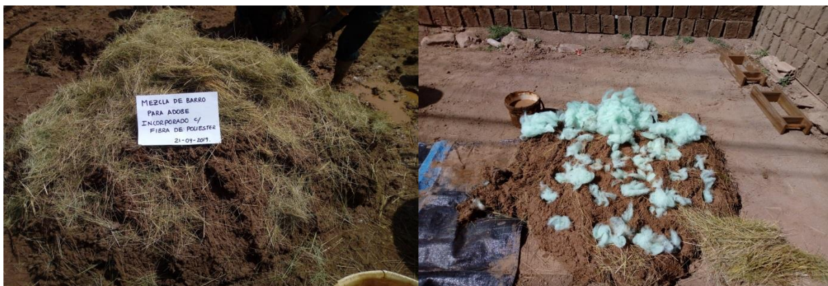
Figura 38: Incorporación de fibras de poliéster en la masa de barro
