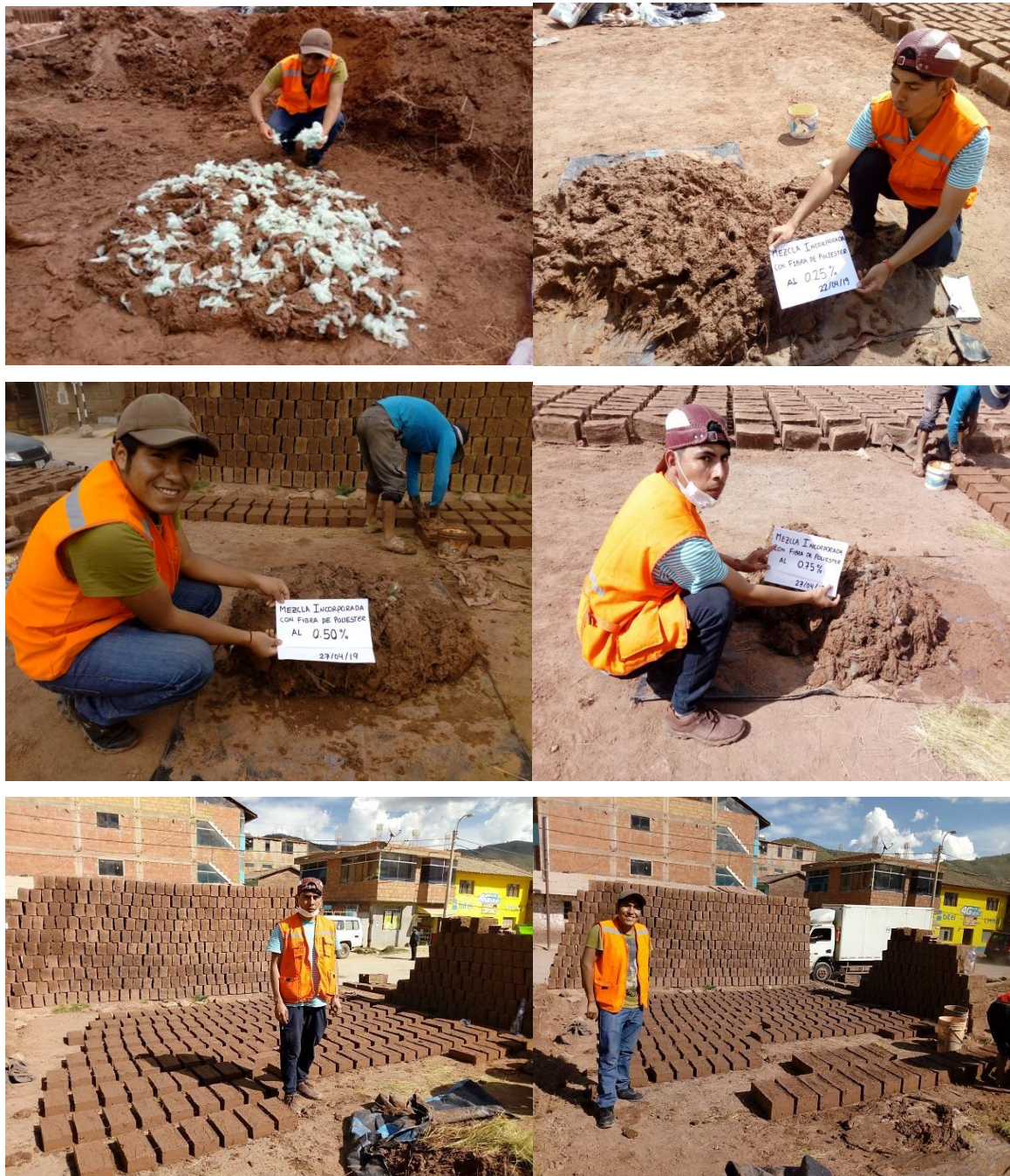
Figura 39: Procedimiento de la fabricación de los elementos de adobe estabilizado con fibras de poliéster
