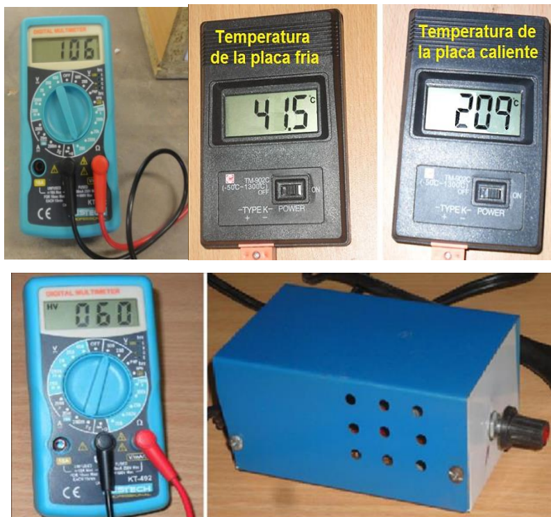
Figura 50: Procedimientos del ensayo de conductividad térmica
