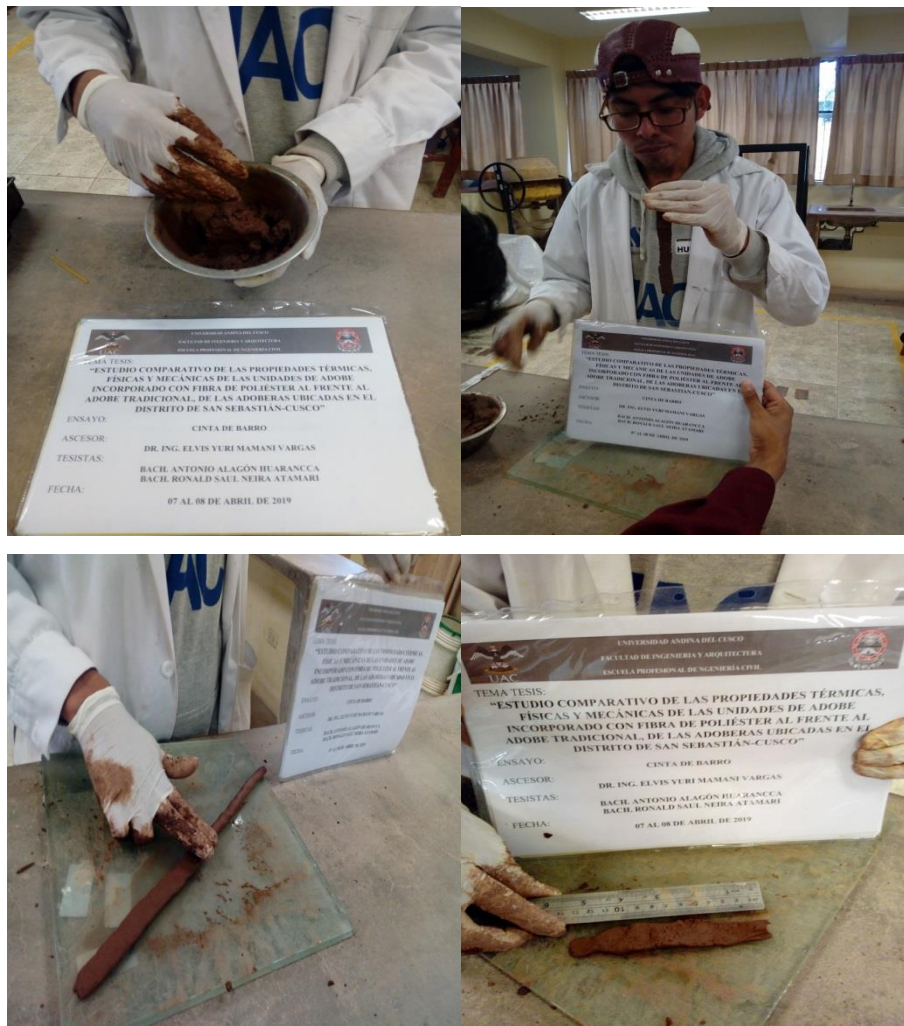
Figura 32: Procedimiento de la prueba de cinta de barro
