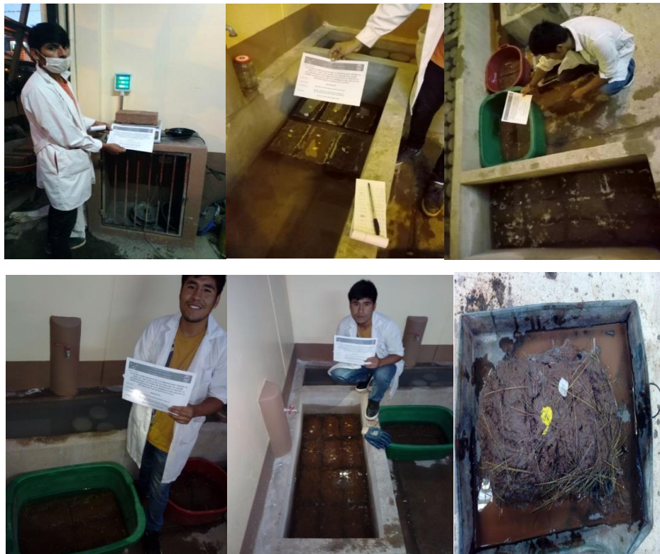
Figura 45: Procedimiento del ensayo de absorción
