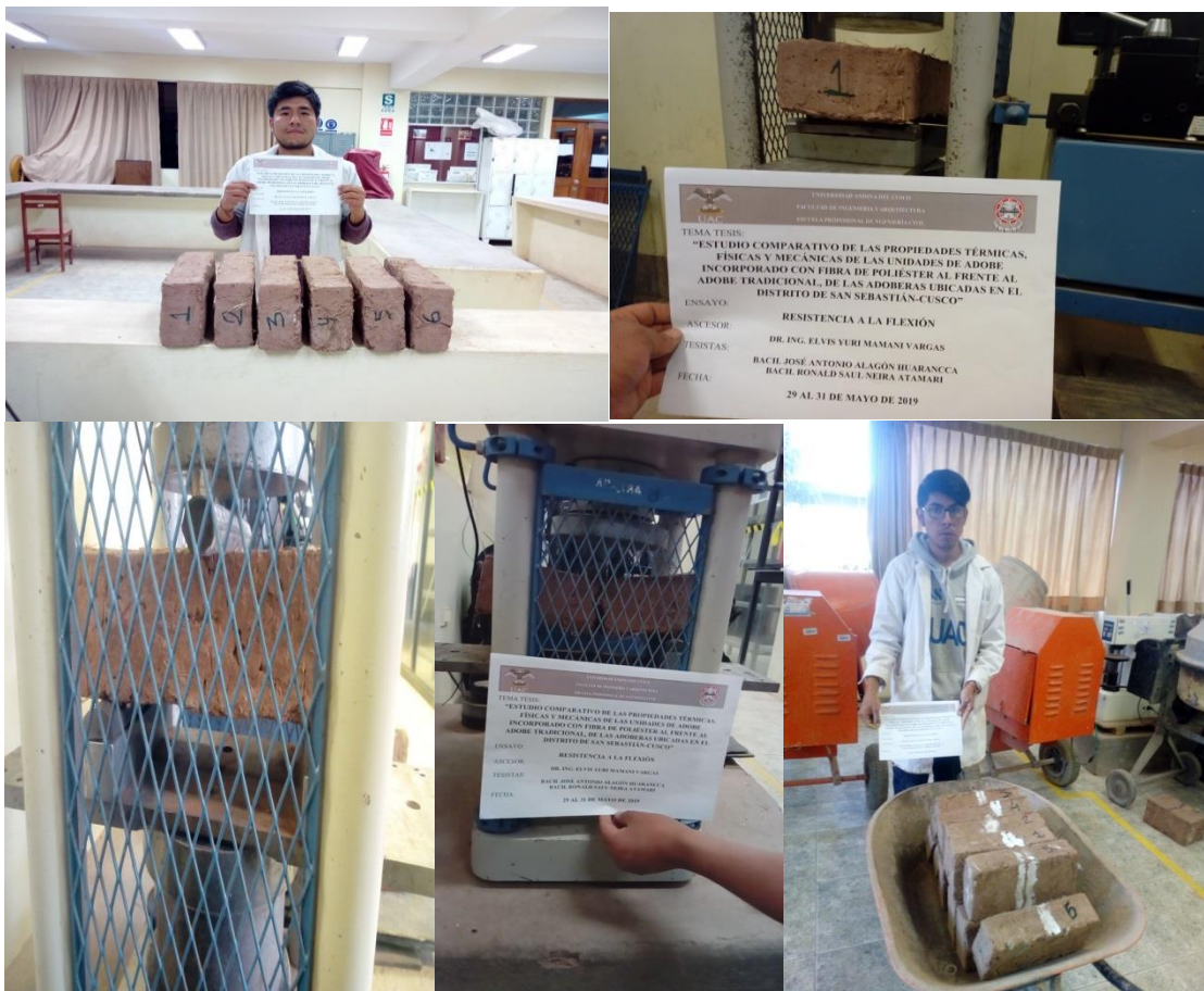
Figura 49: Procedimiento del ensayo de resistencia a la tracción por flexión
