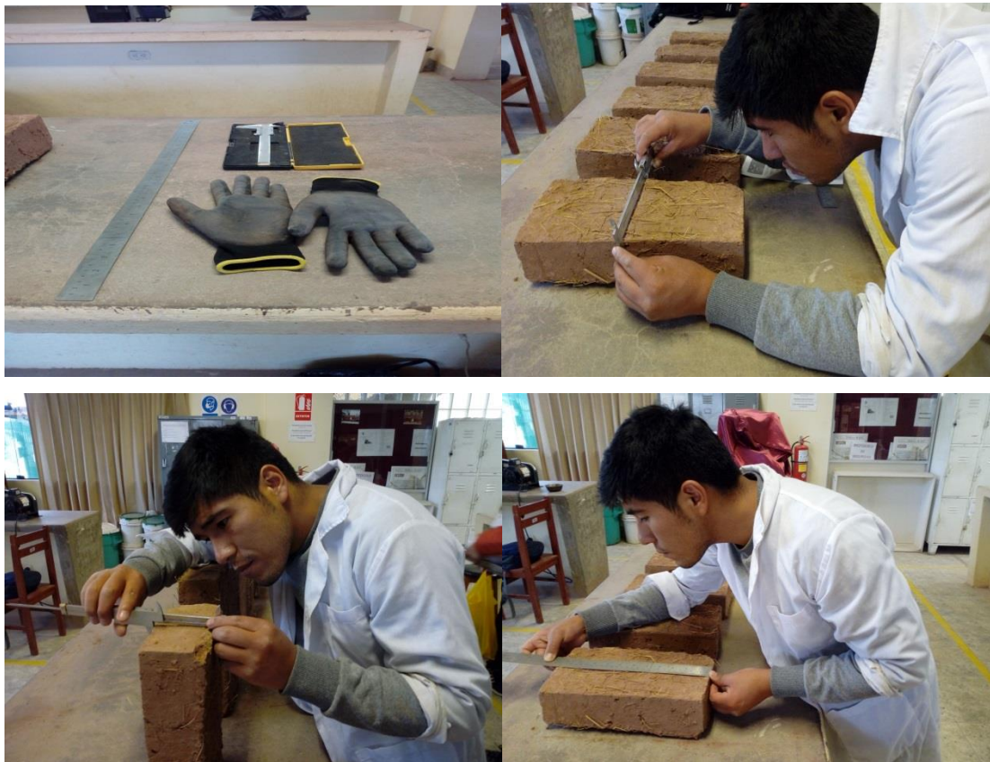
Figura 43: Procedimiento del ensayo de variabilidad dimensional
