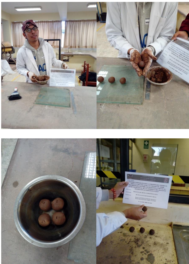
Figura 33: Procedimiento de la prueba resistencia seca de la bola
