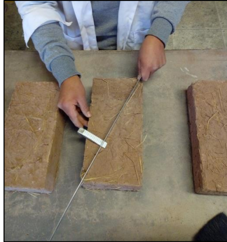
Figura 18: Medición de alabeo con cuña milimétrica
