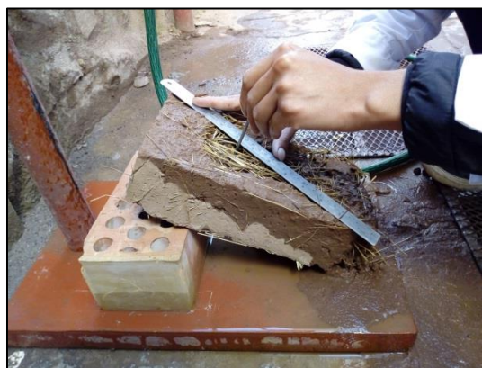
Figura 24: Medición de la oquedad
