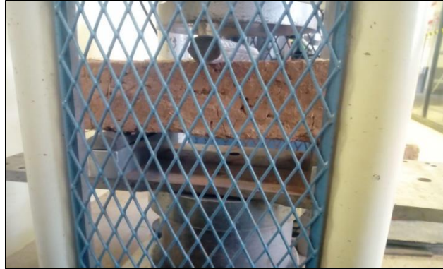
Figura 28: Ensayo de resistencia a la tracción por flexión del elemento de adobe
