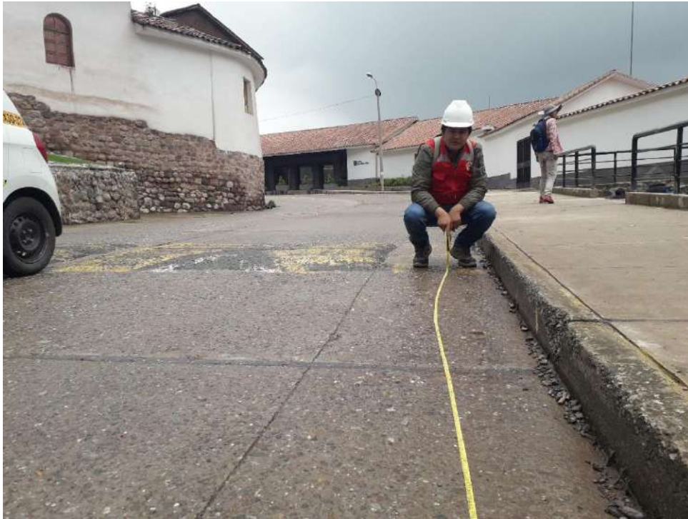
Figura N° 80 Midiendo la distancia que hay entre el reductor de velocidad y la señalización correspondiente
