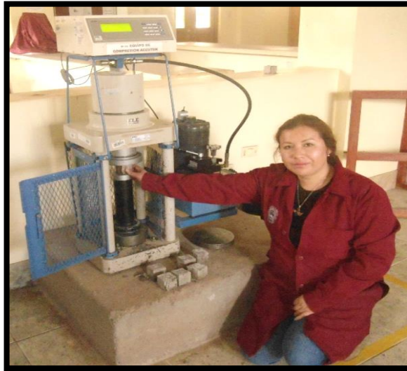
Fotografía 59. Ensayo de compresión de las muestras cúbicas
