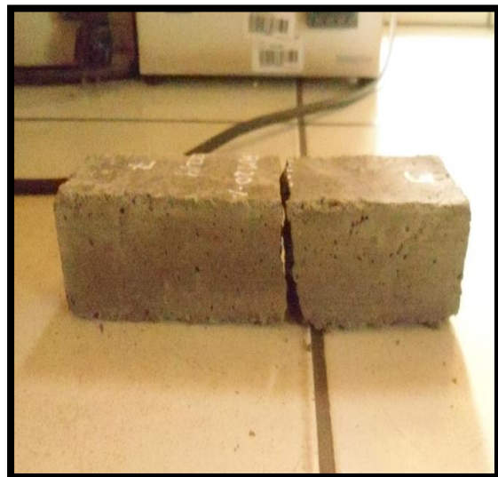
Fotografía 68. Falla de prismas después del ensayo
