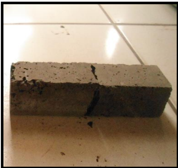
Fotografía 68. Falla de prismas después del ensayo
