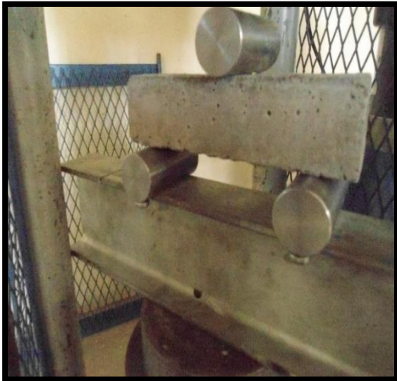
Fotografía 67. Ensayo de flexión del mortero
