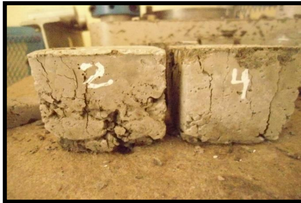
Fotografía 60. Muestras cúbicas después de la falla
