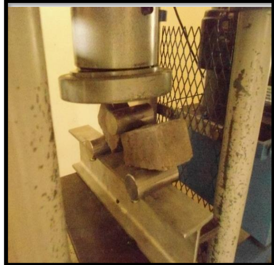
Fotografía 67. Ensayo de flexión del mortero
