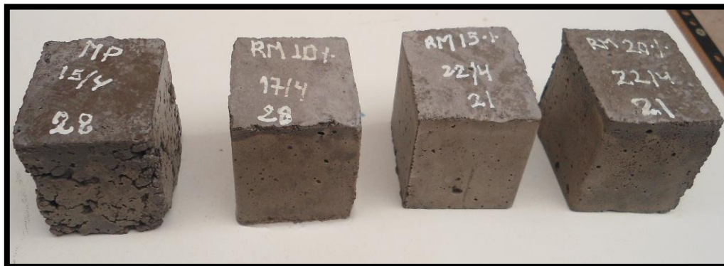
Fotografía 61. Diferencia de textura del mortero patrón con los morteros experimentales
