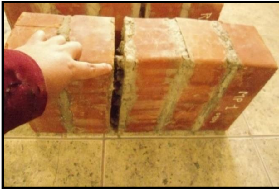
Fotografía 53. Falla de los especímenes prismáticos
