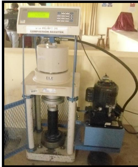
Fotografía 6. Equipo de compresión
