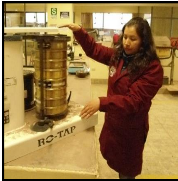
Fotografía 30. Tamizado de los agregados finos
