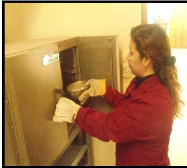
Fotografía 43. Extracción de agregado del horno
