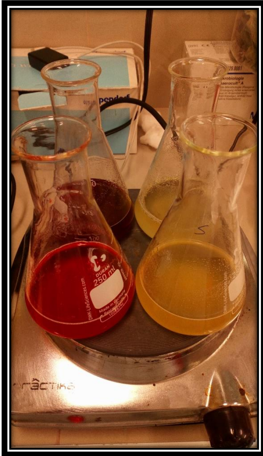
Figura N° 18: Preparación de gares, agua destilada con agar en su presentación seca y dilución a calor
