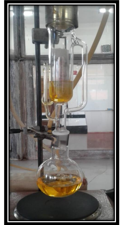
Figura N° 42: Proceso de extracción de la capsaicina por el método de agotamiento en el equipo de SOXHLET durante 24 horas
