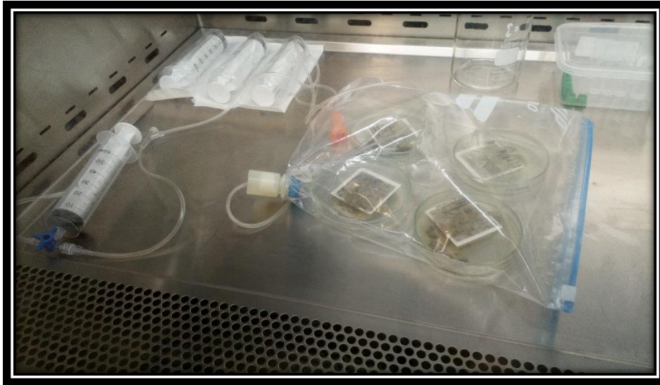
Figura N° 47: Colocación de capsulas de Anaerocult® A dentro de un medio hermético y sistema de succión de medio anaerobio
