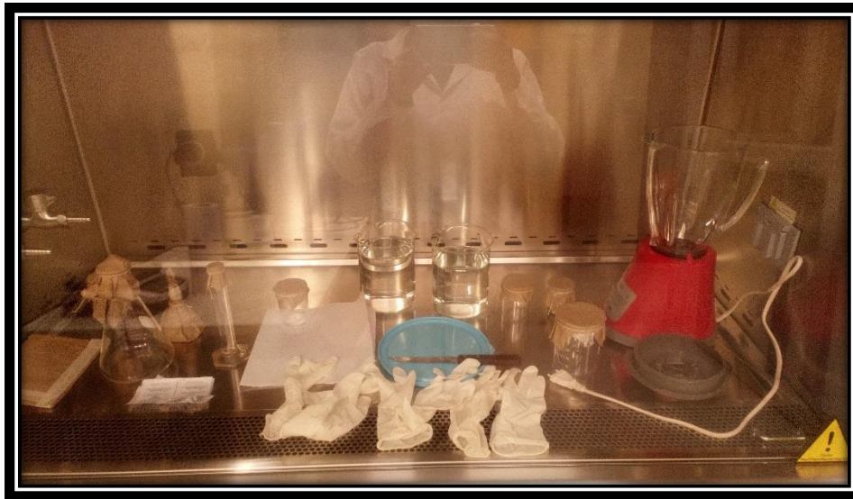
Figura N° 48: Preparación de los materiales dentro de la cámara de flujo laminar para ser esterilizados mediante rayos UV
