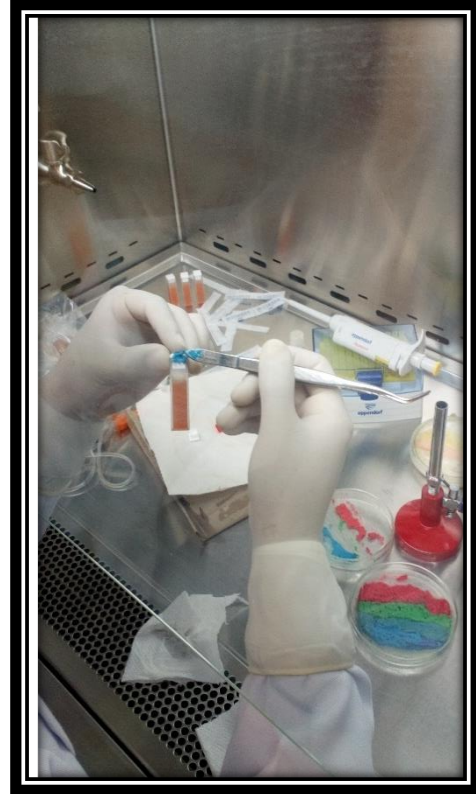
Figura N° 77: Sellado de las cubetas con tapas, plastilina y parafilm
