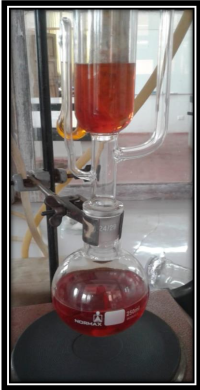
Figura N° 42: Proceso de extracción de la capsaicina por el método de agotamiento en el equipo de SOXHLET durante 24 horas
