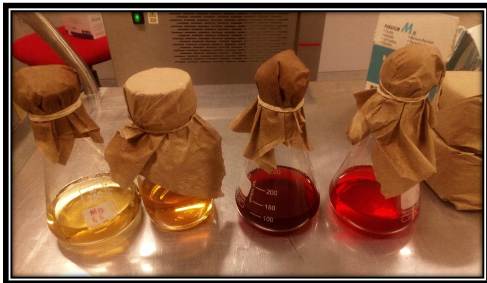
Figura N° 20: Empaquetamiento de matraz con agares diluidos
