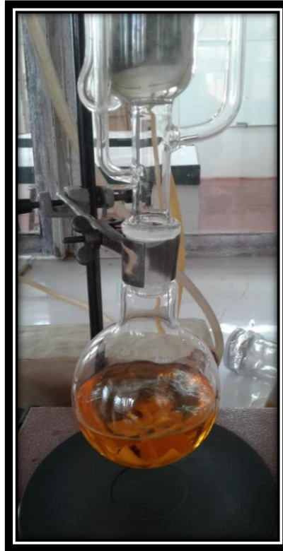
Figura N° 42: Proceso de extracción de la capsaicina por el método de agotamiento en el equipo de SOXHLET durante 24 horas
