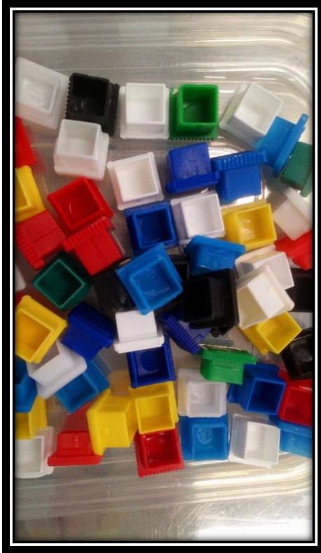
Figura N° 76: Tapas de conos de gutapercha para sellado de las cubetas de cuarzo
