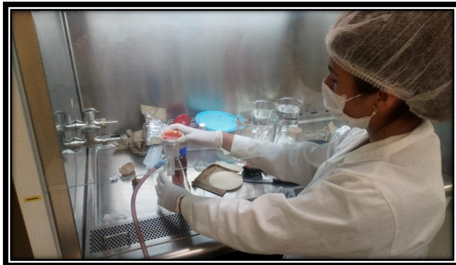
Figura N° 52: Conexión con Bomba al Vacío para la evacuación de gases y filtrado rápido
