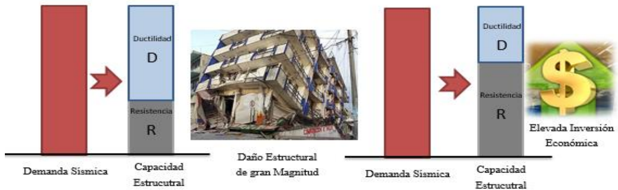
Figura 21: Enfoque estructural con disipadores de energía
