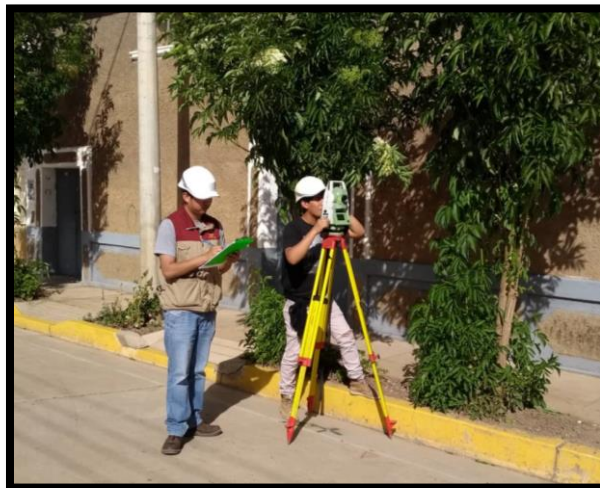
Figura 62: Levantamiento de los puntos de control.
