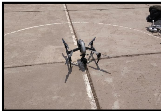
Figura 64: Colocación del dron en el punto de despegue.
