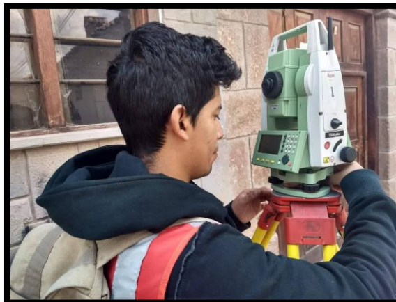
Figura 98: Estacionamiento y configuración de la estación total.
