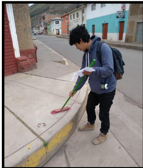
Figura 54: Limpieza del área de los puntos de control.
