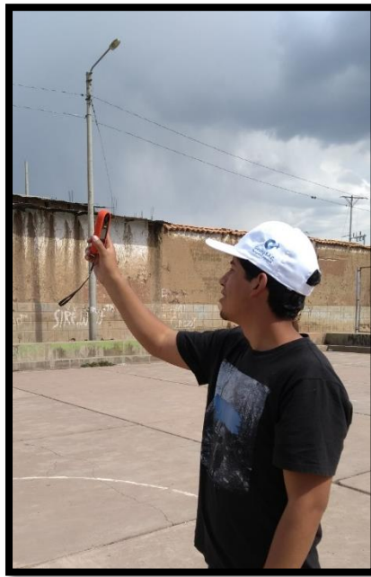
Figura 65: Determinación de la velocidad del viento y temperatura.
