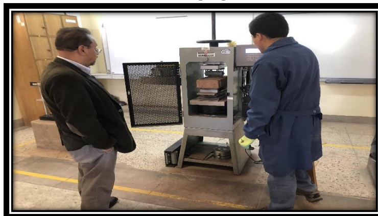
Figura 99: Tomamos nota de la carga que registra la máquina de compresión.
