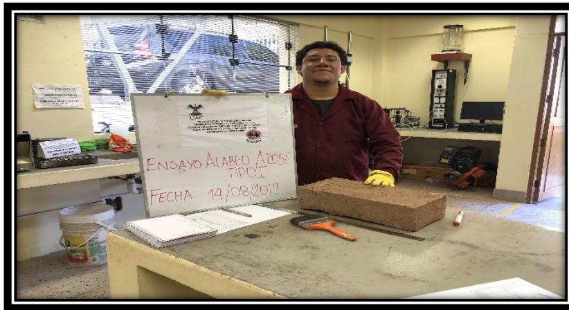
Figura 71: Ensayo de alabeo en la unidad de adobe tipo I. (Elaboración propia, 2019)
