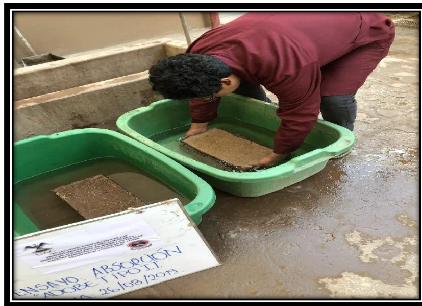
Figura 75: Inmersión de las unidades de adobe tipo I. (Elaboración propia, 2019)
