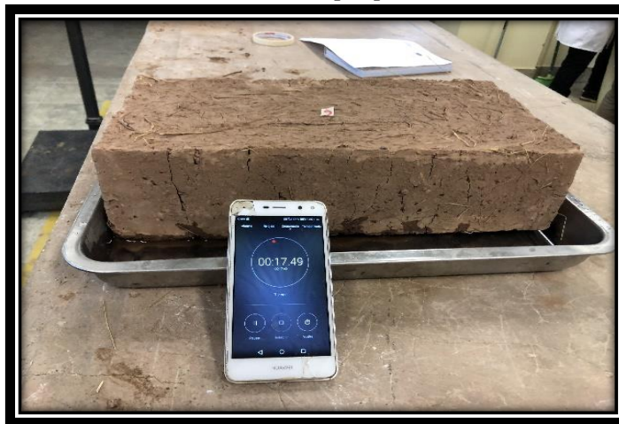
Figura 79: Colocamos la unidad en la bandeja durante 1 min.
