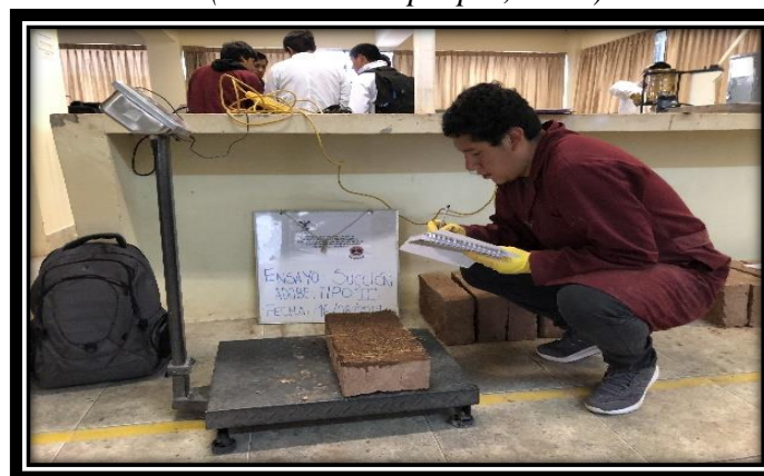
Figura 80: Registramos el peso de las unidades después del ensayo.
