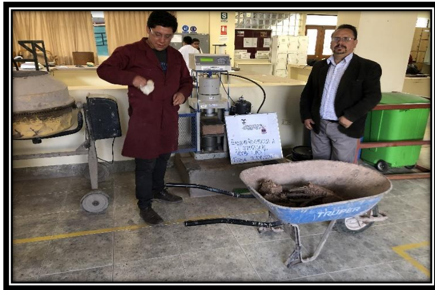
Figura 94: Verificamos la falla de la unidad de adobe tipo II (6 Tiras de caucho).
