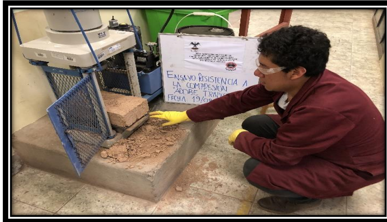
Figura 91: Colocamos la unidad de adobe con las láminas de neopreno.
