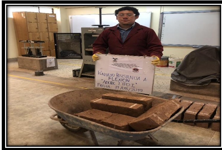
Figura 101: Verificación de la falla de la unidad de adobe tipo I.
