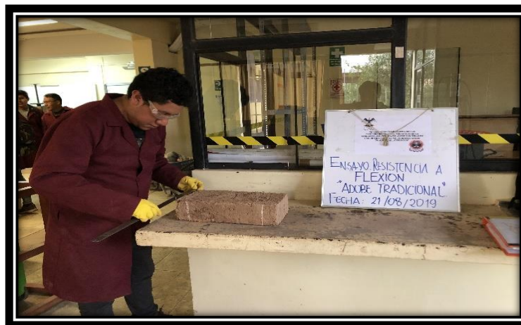
Figura 97: Medición del ancho y la altura de la unidad a ensayar.
