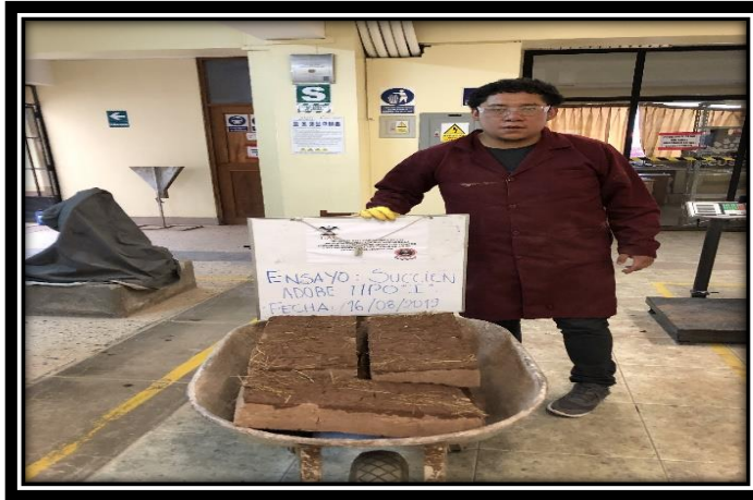
Figura 81: Unidades de adobe tipo i después de su ensayo.
