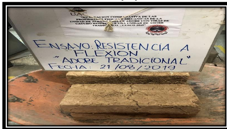
Figura 100: Verificación de la falla de la unidad de adobe tradicional.
