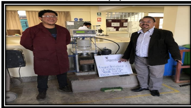
Figura 92: Sometemos la unidad de adobe a compresión hasta que falle.
