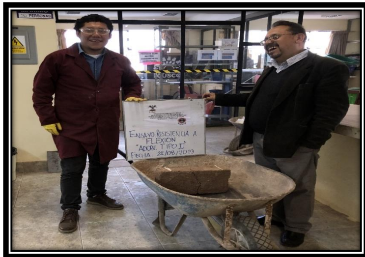
Figura 102: Verificación de la falla de la unidad de adobe tipo II.
