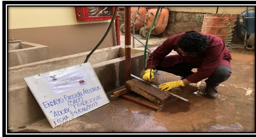
Figura 87: Procedemos a medir la oquedad.
