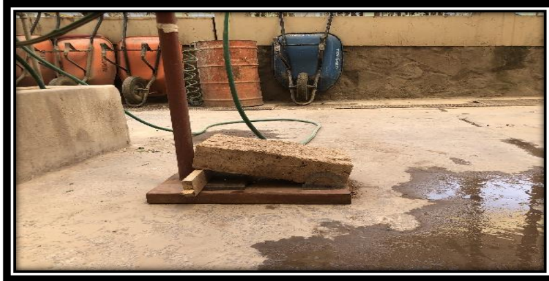
Figura 84: Se colocó la unidad de adobe a un ángulo de 27°. (Elaboración propia, 2019)
