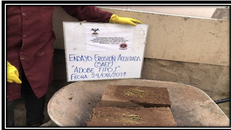
Figura 88: Unidades de adobe tipo I ensayadas.
