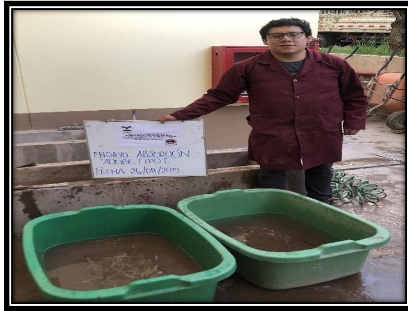
Figura 75: Inmersión de las unidades de adobe tipo I. (Elaboración propia, 2019)
