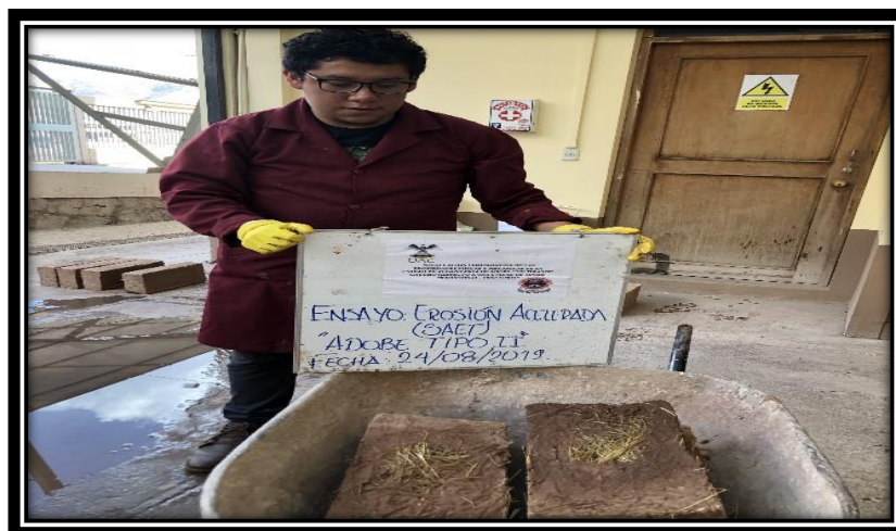
Figura 89: Unidades de adobe tipo II ensayadas.
