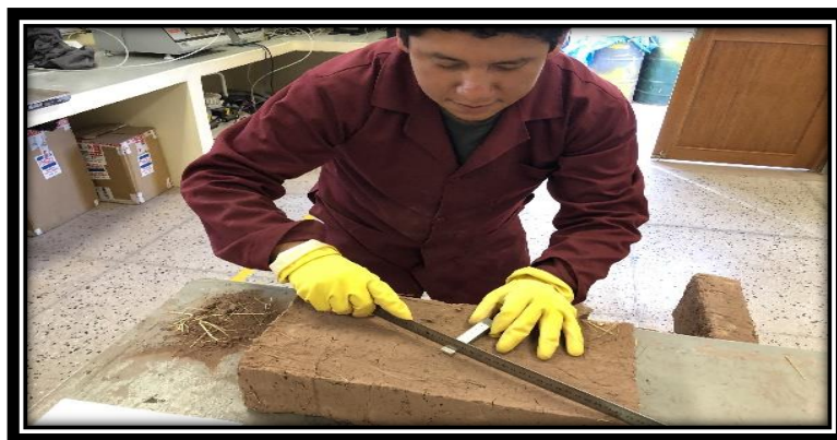
Figura 69: Medición del alabeo con la cuña metálica.
