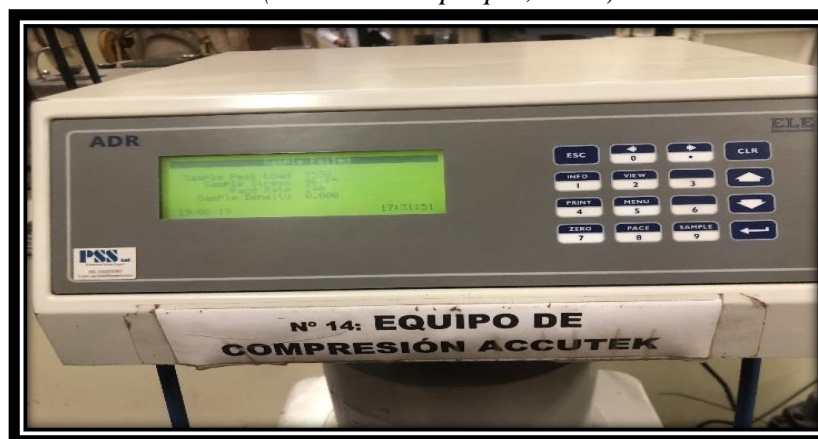
Figura 93: Registramos el valor de la carga registrada en la máquina de compresión.
