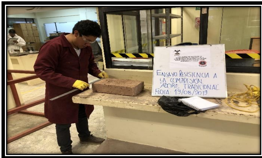
Figura 90: Medimos el área de la unidad de adobe a ensayar.
