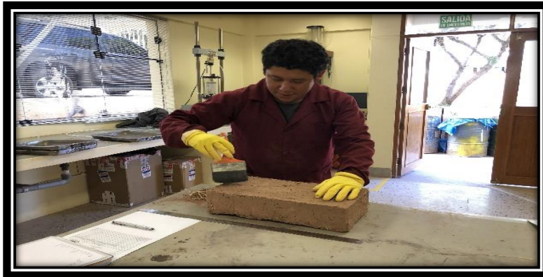
Figura 68: Limpieza de las unidades de adobe.
