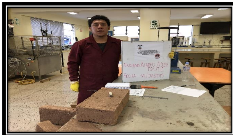
Figura 71: Ensayo de alabeo en la unidad de adobe tipo I. (Elaboración propia, 2019)
