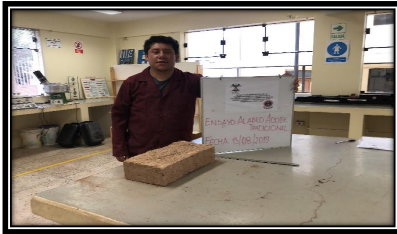
Figura 70: Ensayo de alabeo en la unidad de adobe tradicional. (Elaboración propia, 2019)
