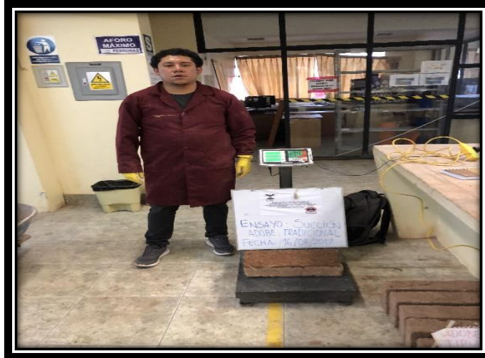
Figura 78: Pesamos las unidades de adobe antes del ensayo.
