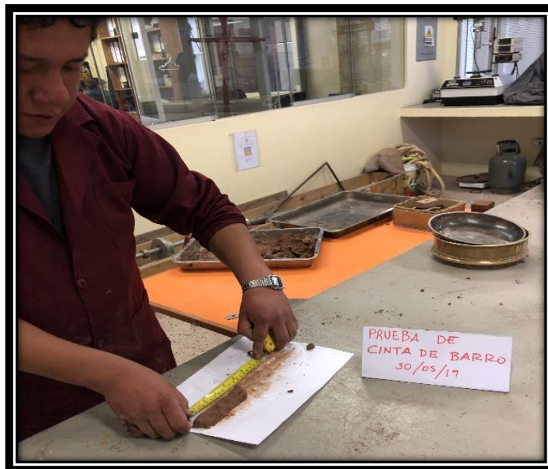
Figura 43: Cinta de barro rota en un extremo. (Elaboración propia, 2019)
