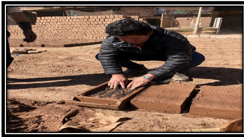
Figura 30: Colocación de la pasta de barro y las 03 (tres) tiras de caucho. (Elaboración propia, 2019)
