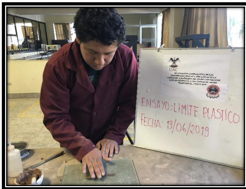
Figura 60: Formación de rollitos hasta su ruptura.
