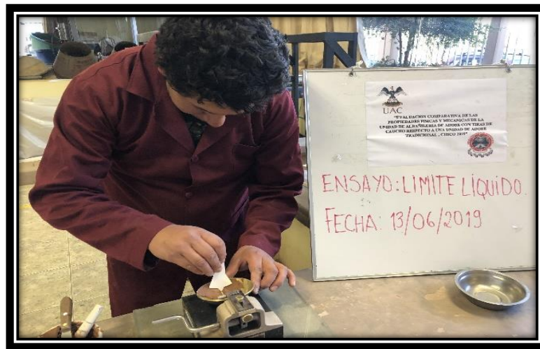
Figura 57: Colocamos la muestra húmeda en la cuchara de casa grande. (Elaboración propia, 2019)
