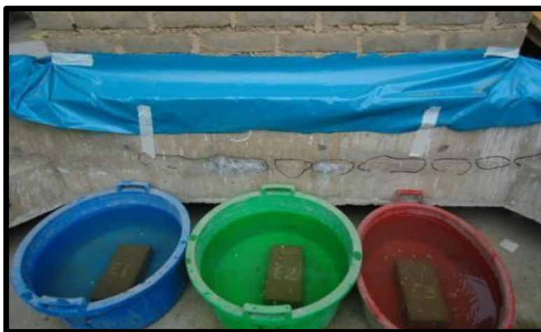
Figura 15: Ensayo de absorción (Cabrera Arias & Huaynate Granados , 2010)
