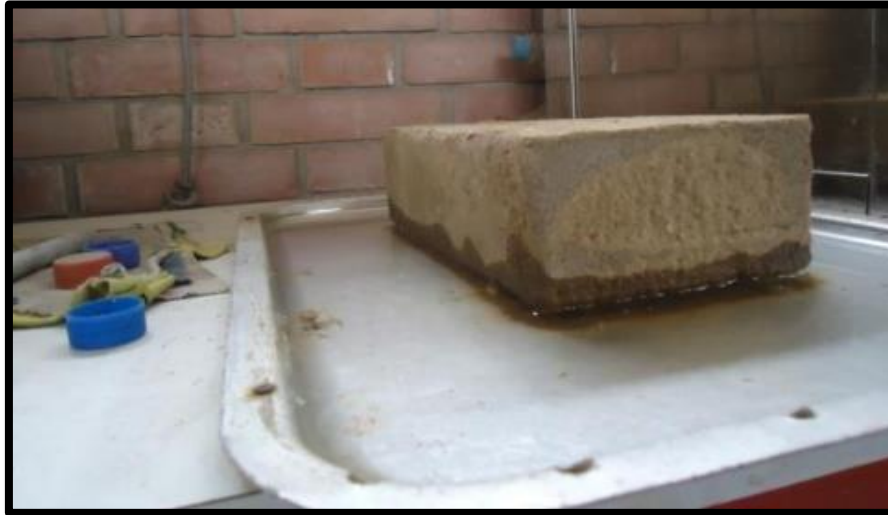
Figura 14: Ensayo de succión (Cabrera Arias & Huaynate Granados, 2010)
