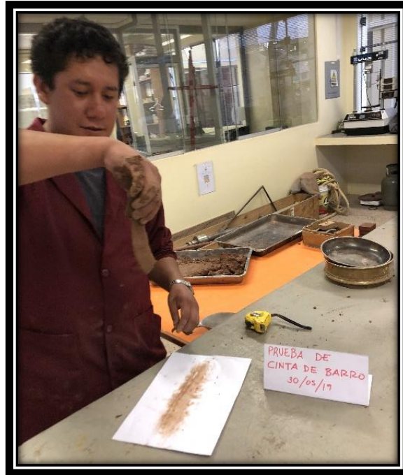
Figura 48: Cinta de barro suspendida de 4mm. de espesor. (Elaboración propia, 2019)
