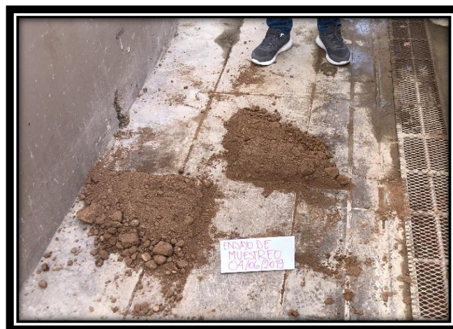
Figura 53: Seleccionamos la muestra representativa de suelo. (Elaboración propia, 2019)
