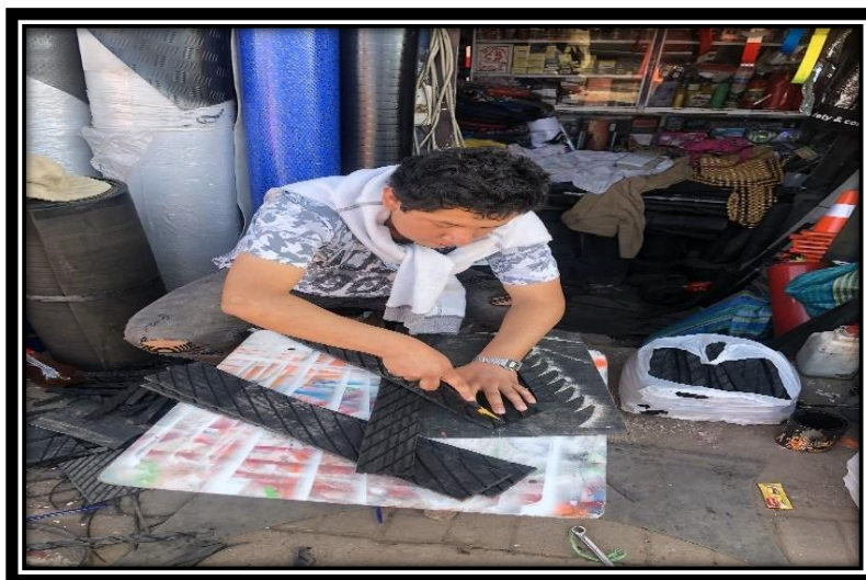
Figura 20: Marcado y corte de las llantas para la obtención de las tiras de caucho.
