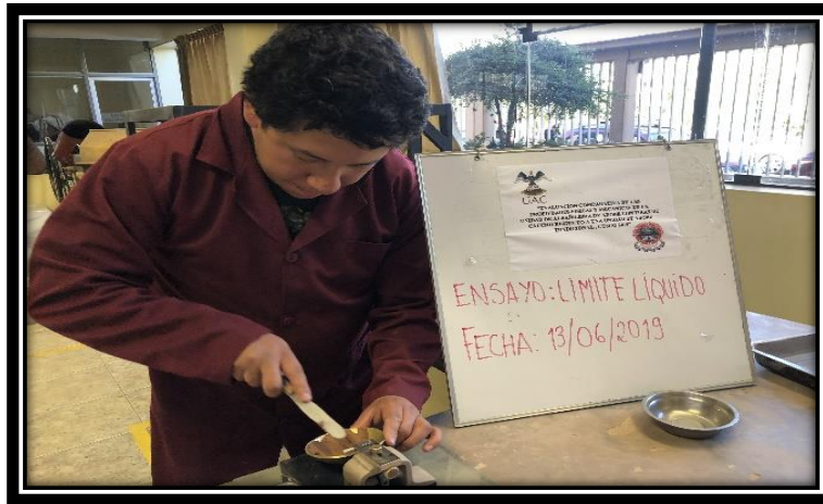
Figura 57: Colocamos la muestra húmeda en la cuchara de casa grande. (Elaboración propia, 2019)
