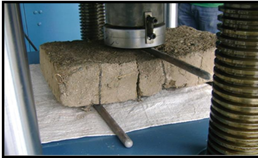
Figura 13: Ensayo de resistencia a la flexión (Ramírez Torres, 2012)
