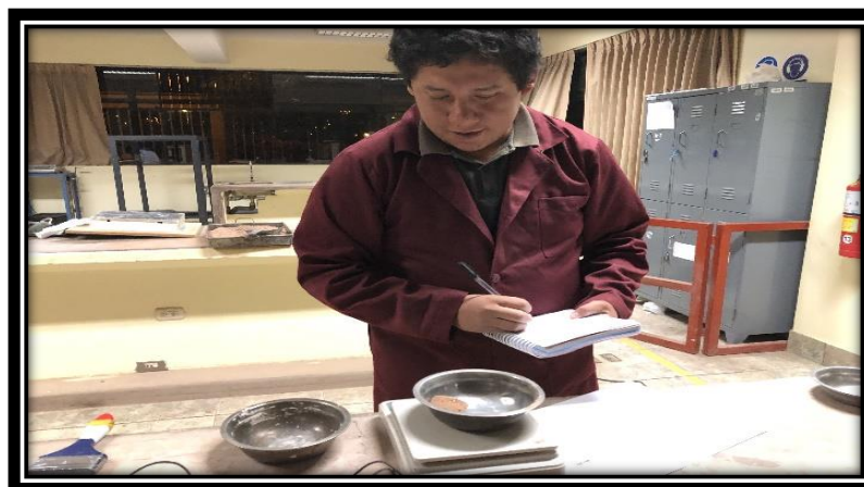
Figura 66: Registramos el peso del material retenido de cada malla
