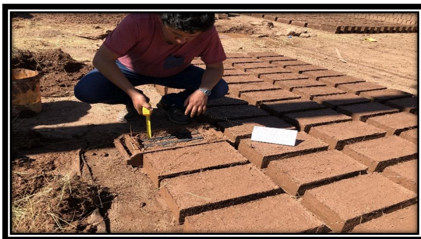
Figura 39: Colocación de las 03 tiras de caucho superiores a una altura de 7cm. (Elaboración propia, 2019)
