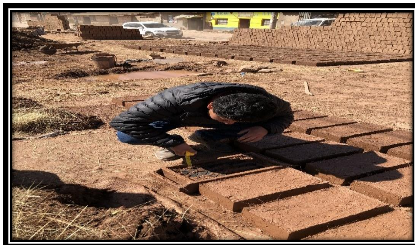
Figura 31: Verificación de las 03 tiras de caucho a la unidad de adobe a una altura de 5 cm. (Elaboración propia, 2019)
