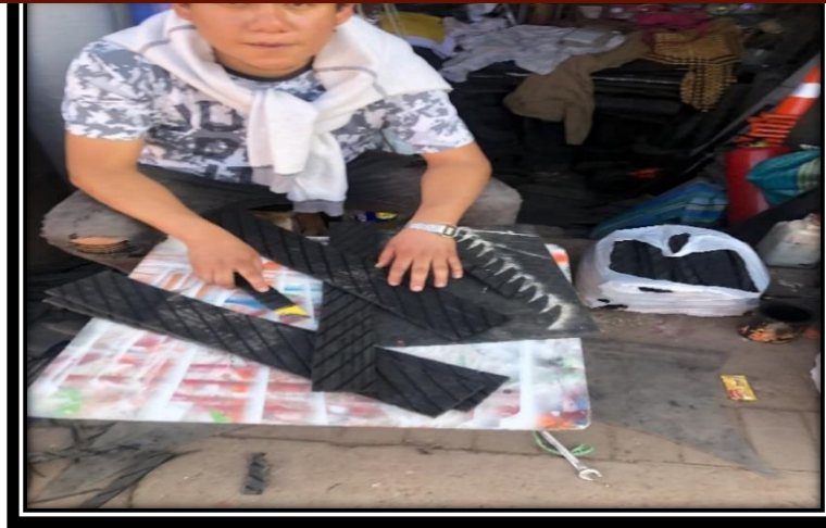
Figura 21: Marcado y corte de las llantas para la obtención de las tiras de caucho.
