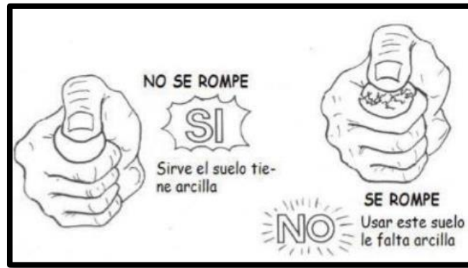
Figura 5: Prueba “Presencia de arcilla o resistencia seca”
