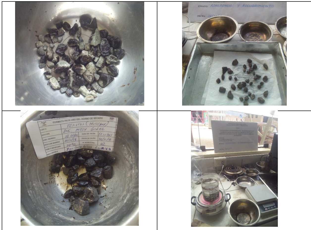
Figura 44. Se muestra el cubrimiento y adherencia de los agregados gruesos, así como el equipo y materiales utilizados, (Fuente: Elaboración propia).
