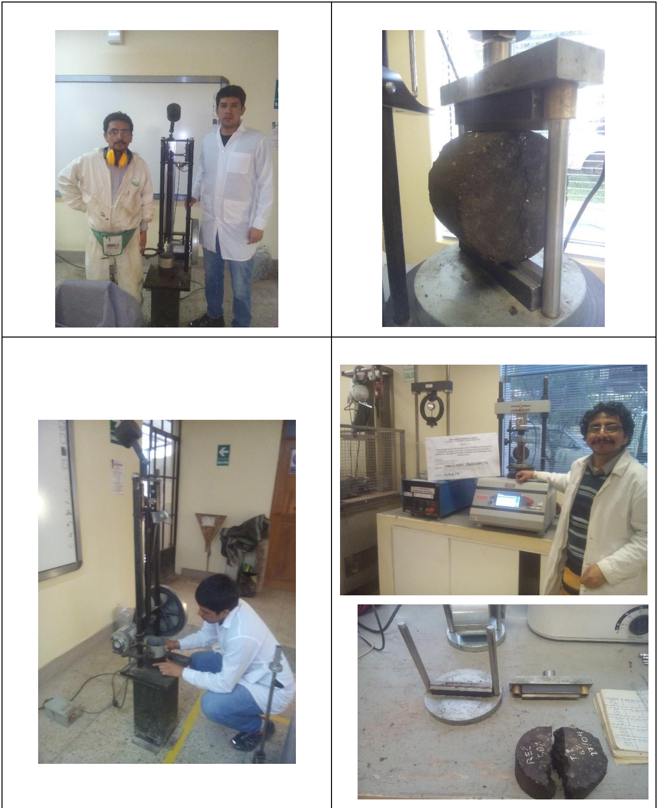
Figura 54. Se observa el equipo compactador Marshall y la operación de carga de la briqueta a compactar, también se observa la falla transversal de la briqueta sometida a tracción indirecta, así como las mordazas y el proceso de carga en el equipo Marshall para tracción indirecta.
