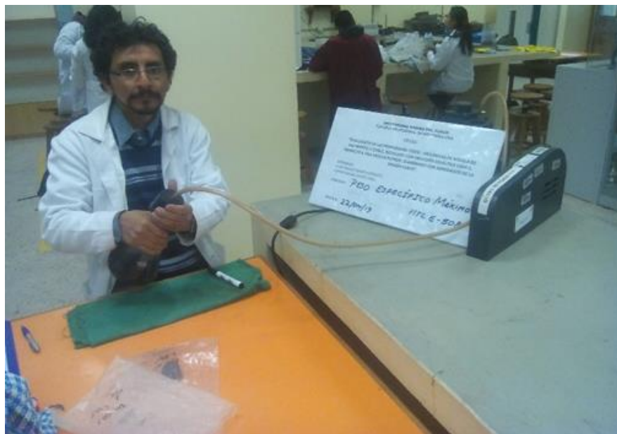
Figura 49. Muestras preparadas de mezclas asfálticas patrón, agregados reciclados al 25%, 33.33%, 50%; ensayo de peso específico máximo con bomba de vacío, (Fuente: Elaboración propia).
