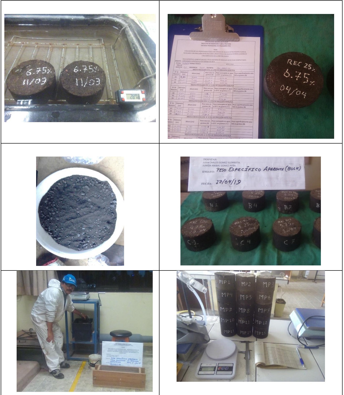
Figura 50. Se observa los elementos para determinar el % de vacíos, Ensayo de Peso Específico aparente con briquetas sumergidas y los de Peso Específico máximo en platos descartables.
