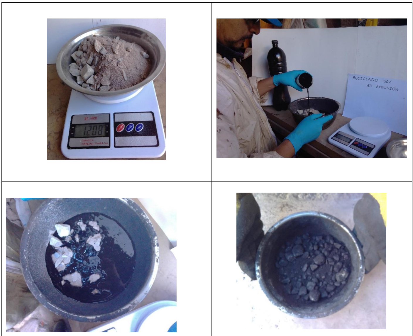
Figura 57. Se observa pesado de la mezcla de agregados con 50% de agregado reciclado, incorporación de emulsión asfáltica a la mezcla, proceso antes y después del mezclado, previo a la compactación.
