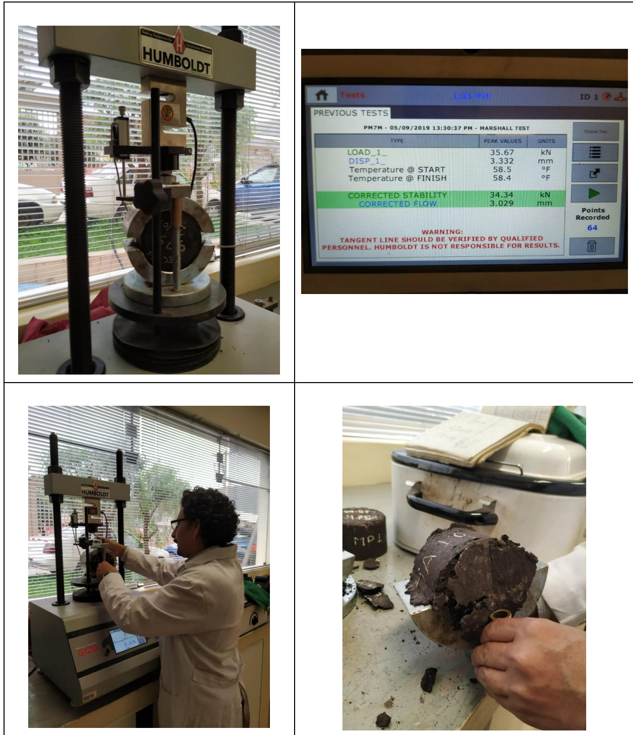
Figura 53. Se observa el equipo Marshall cargado con la briqueta de ensayo, al costado el resultado del ensayo, abajo el retiro de la briqueta ensayada y como queda esta después del ensayo.
