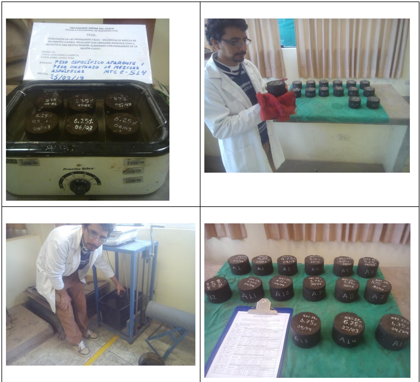
Figura 48. Se observa las briquetas sumergidas en baño maría, la inmersión en la balanza de flotabilidad, el secado superficial y el grupo de briquetas ensayadas en este caso las de contenido de agregado reciclado al 25%, (Fuente: Elaboración propia).
