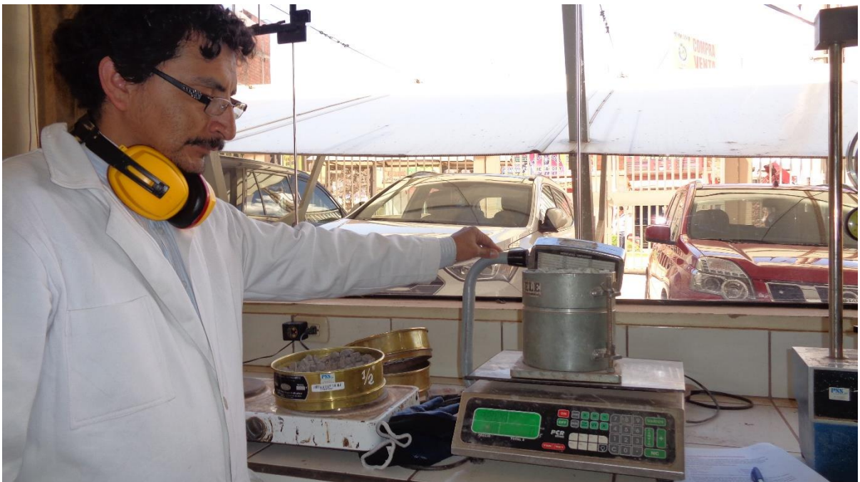
Figura 28. Pesado de agregado compactado en molde de 6" para hallar peso unitario.
