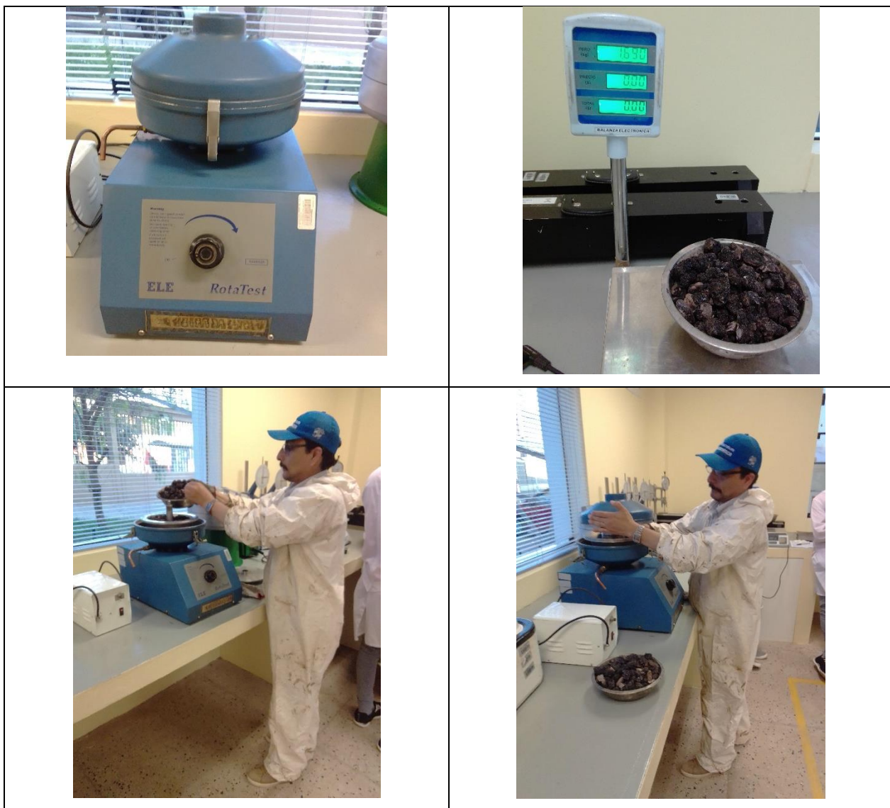
Figura 40. Se observa equipo de lavado centrífugo de asfalto, pesado de muestra de pavimento asfáltico reciclado preparado, carga del mismo en el equipo de centrifugado.
