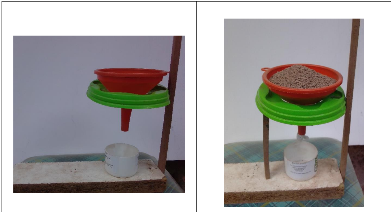
Figura 38. A la izquierda, equipo de ensayo de angularidad que consta de un recipiente cilíndrico de volumen y peso conocido y un embudo; derecha, equipo cargado antes de realizar el ensayo, (Fuente: elaboración propia).
