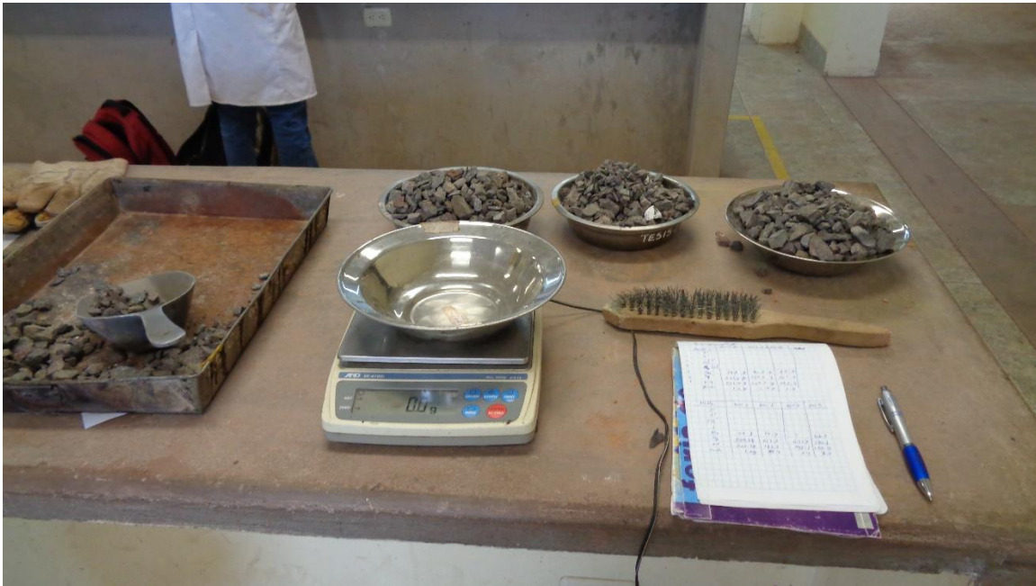
Figura 25. Trabajo de pesado y separación de agregados así como su registro.
