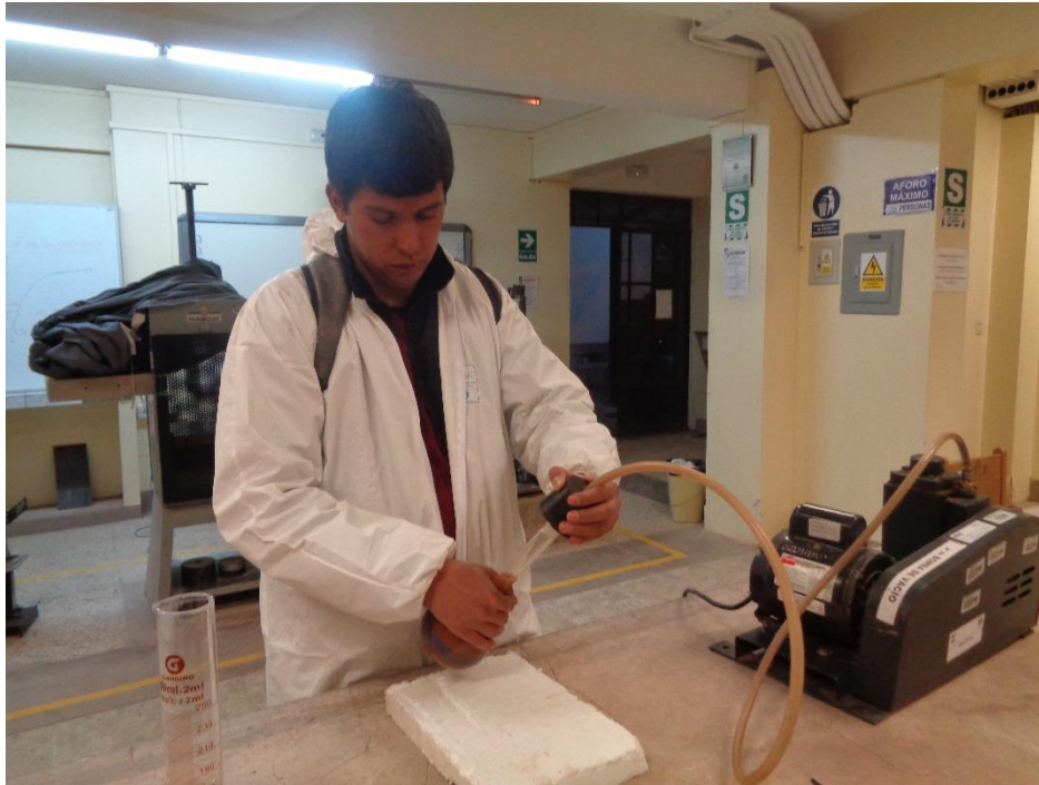
Figura 29. Ensayo peso específico de agregado fino, utilizando bomba de vacío, agregado fino 1 y 2.
