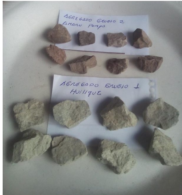
Figura 32. Agregado grueso de cantera mostrando caras fracturadas.
