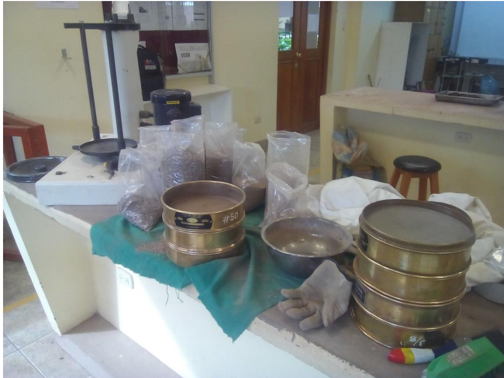
Figura 26. Se observa equipo de tamizado mecánico, juego de tamices y herramientas, así como agregado separado en bolsas
