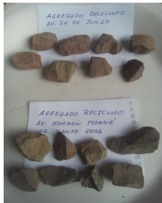
Figura 33. Agregado reciclado de pavimento mostrando caras fracturadas.
