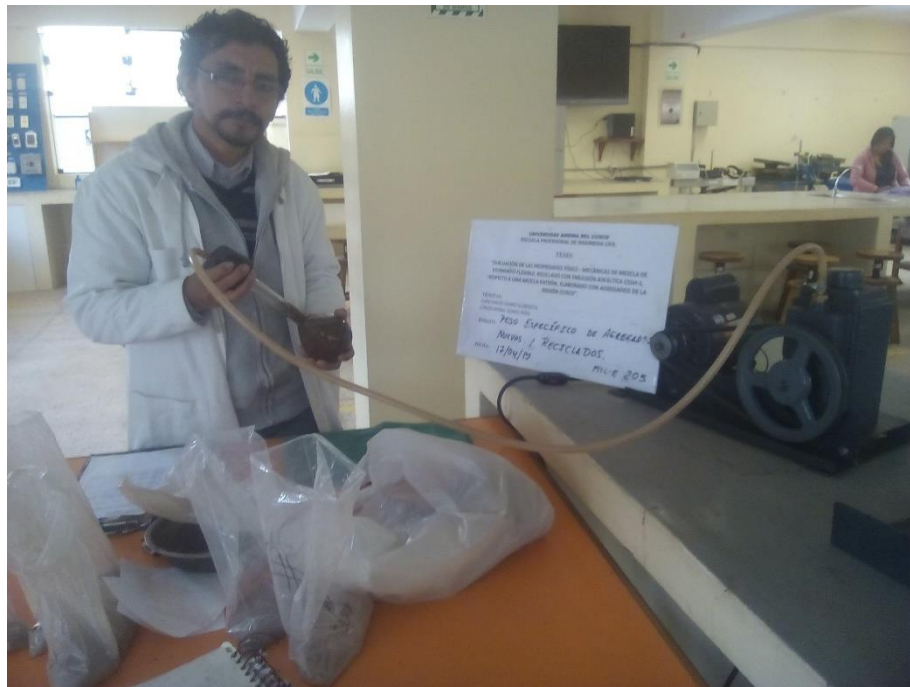
Figura 30. Ensayo peso específico de agregado fino, utilizando bomba de vacío, agregados reciclados de pavimento 1 y 2.
