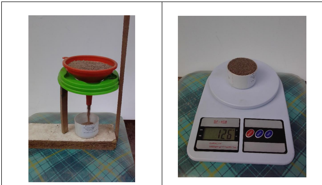
Figura 39. A la izquierda, Ensayo en ejecución, llenado de recipiente con el agregado seleccionado hasta el ras; derecha, pesado de la muestra enrasada en el recipiente de volumen y peso conocido, (Fuente: elaboración propia).
