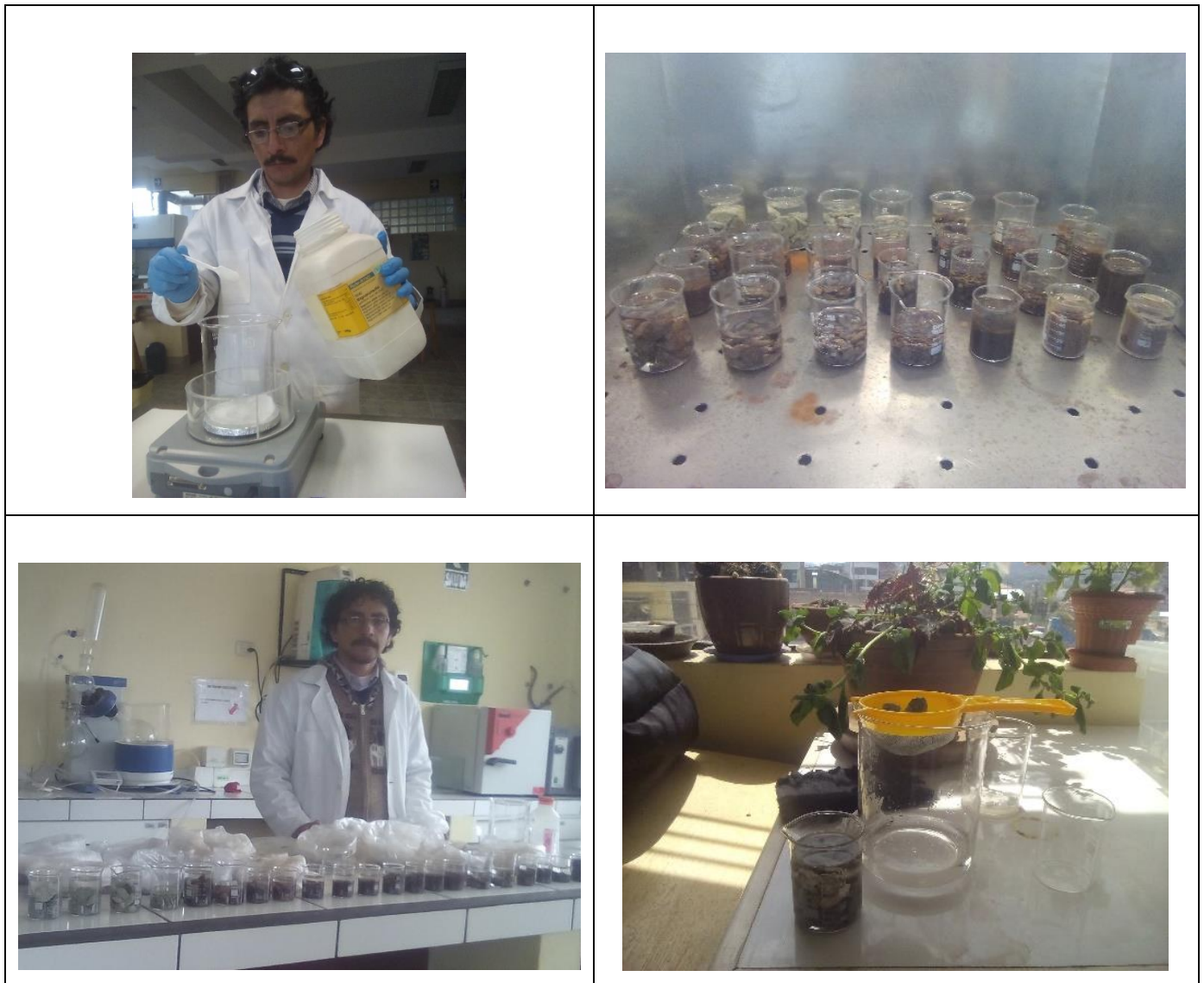
Figura 36. Preparación de solución de sulfato de magnesio, incubación y colado de 28 muestras.
