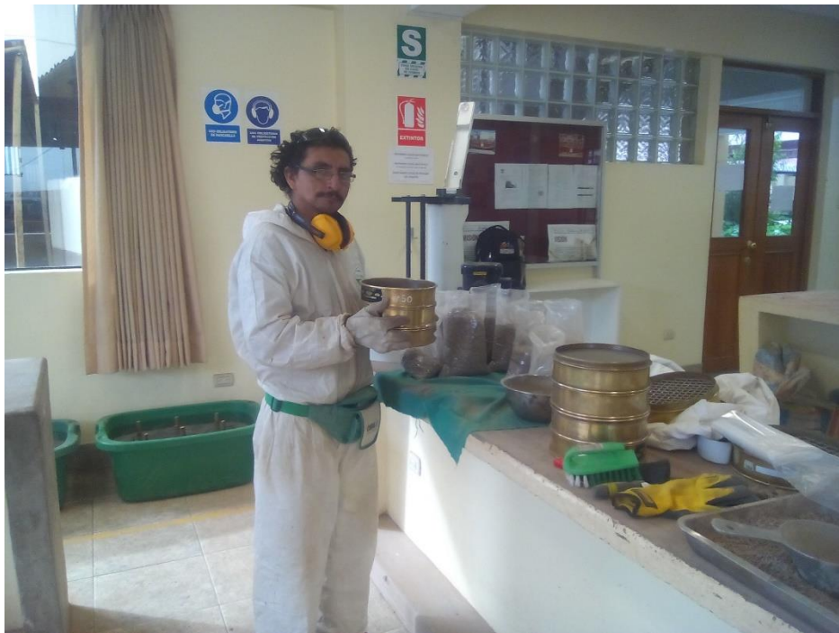
Figura 24. Trabajo de tamizado de agregados, se observa juego de tamices, herramientas, material tamizado en bolsas, al fondo equipo de tamizado mecánico.
