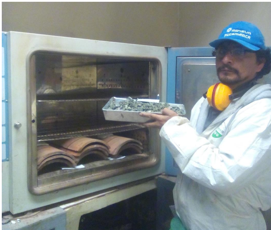
Figura 31. Secado de agregado grueso en horno para ser puesto a la intemperie (determinación de humedad).
