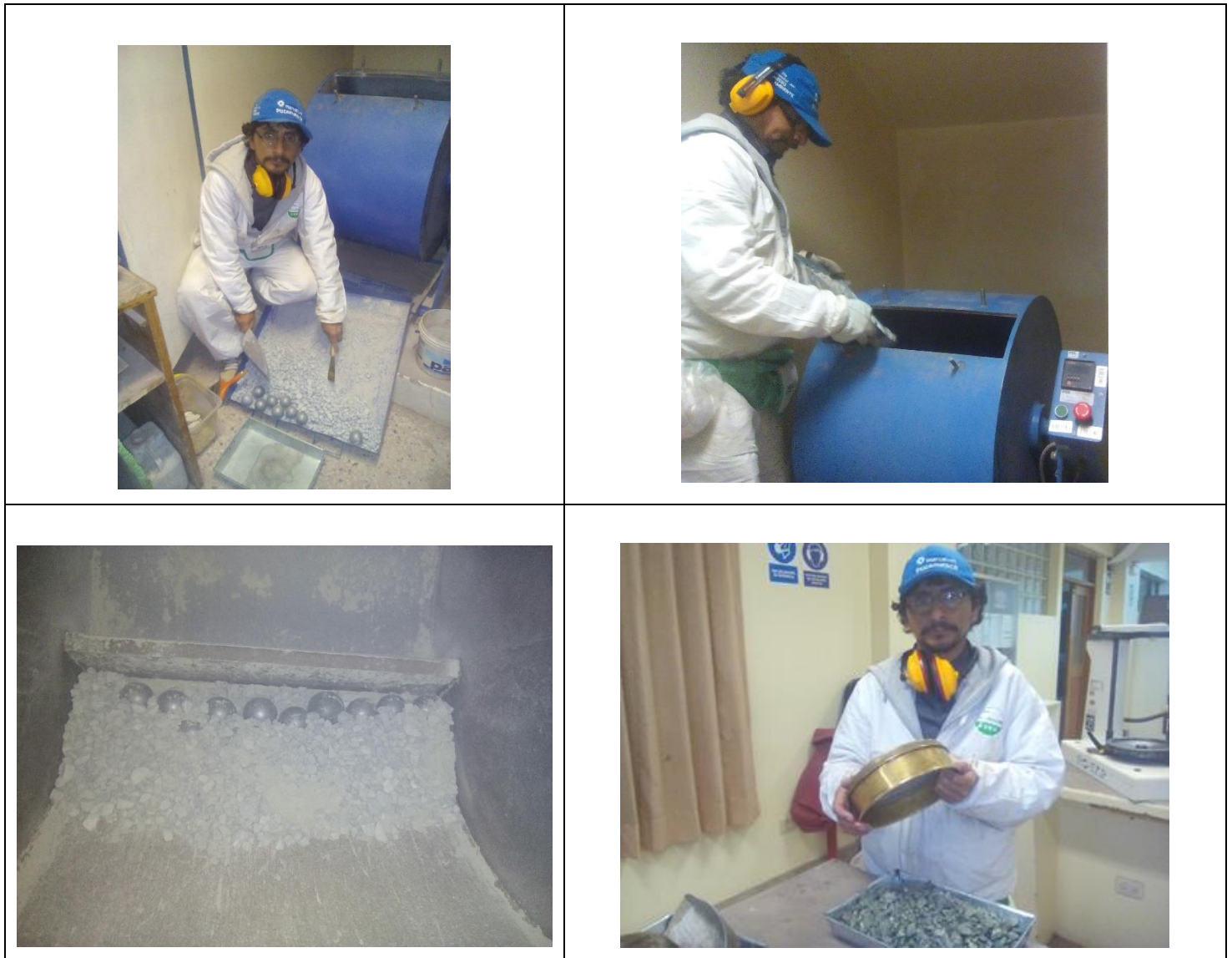
Figura 35. Operación de carga, descarga, lavado y tamizado en malla N°10 de agregado grueso, E. de los ángeles.
