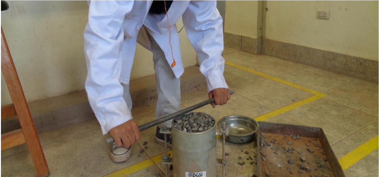
Figura 27. Enrasado compactado y sin compactar con varilla de 3/8" de agregado grueso.
