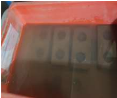
Figura 102: Colocación de 05 unidades de albañilería en agua
