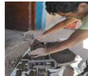
Figura 81: Colocación de la muestra húmeda en la máquina Cimva Ram modificada
