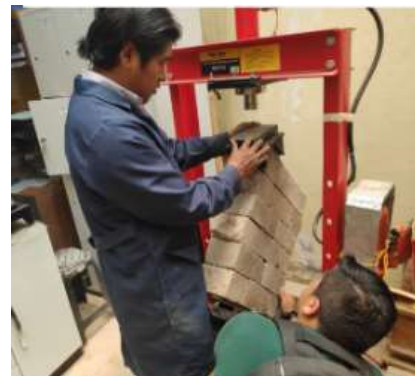
Figura 115: Colocación de murete en la máquina de compresión diagonal
