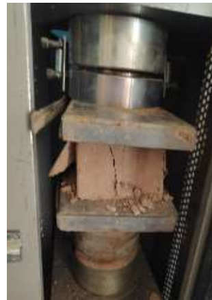
Figura 99: Fisura mienta de la unidad de albañilería
