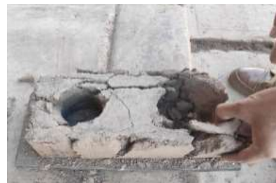
Figura 101: Unidad de albañilería post ensayo a la resistencia a compresión
