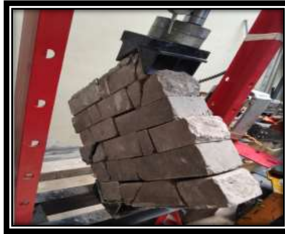
Figura 116: Falla mixta de los muretes
