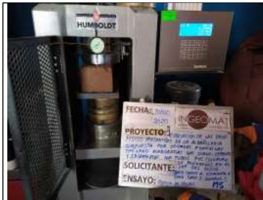
Figura 107: Ensayo de módulo de elasticidad
