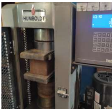
Figura 98: Ensayo de resistencia de compresión de la unidad de albañilería
