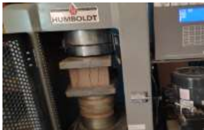
Figura 100: Unidad de albañilería previa a su resistencia a compresión final
