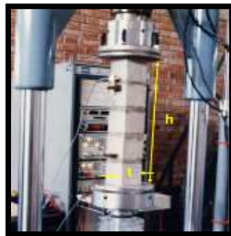
Figura 19: Ensayo de compresión axial en pilas
