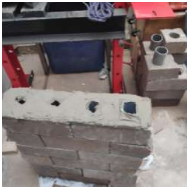
Figura 114: Colocación de capping en muretes
