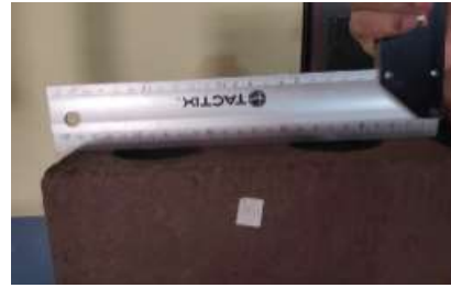
Figura 95: Medición del alabeo en la parte central de la cara superior de la unidad de albañilería
