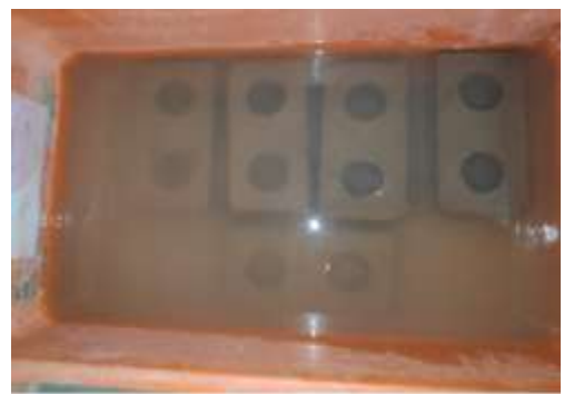
Figura 103: Unidades de albañilería durante el proceso de absorción
