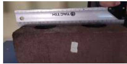
Figura 97: Medición del alabeo de la parte central de la cara inferior de la unidad de albañilería
