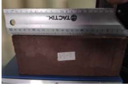
Figura 94: Medición del alabeo en la parte izquierda de la cara superior de la unidad de albañilería
