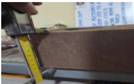
Figura 92: Medición de la altura de una cara lateral de la unidad de albañilería
