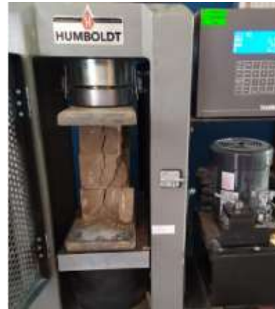
Figura 111: Fisuras durante el ensayo de resistencia a compresión de pilas
