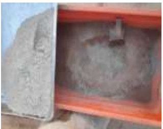
Figura 79: Mezcla del suelo más el cemento
