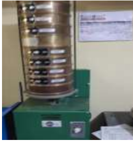
Figura 38: Tamizado de la muestra de suelo
