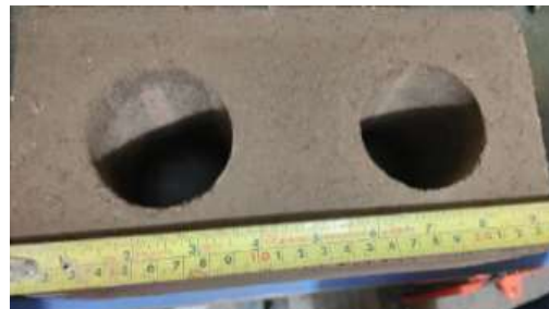
Figura 93: Medición de la cara inferior de la unidad de albañilería
