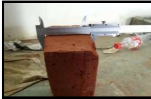
Figura 12: Medición de las dimensiones de la unidad de albañilería Fuente: (San Bartolomé Á. , 2006)
