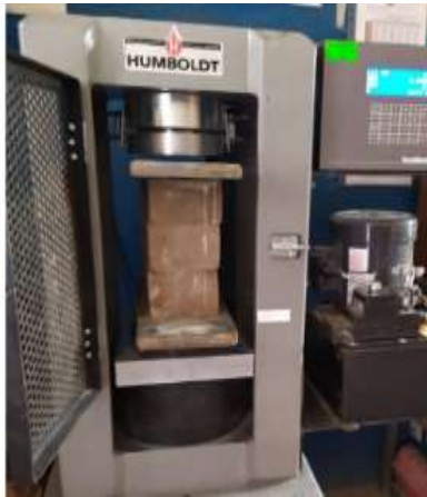
Figura 110: Colocación de pilas en la máquina de compresión
