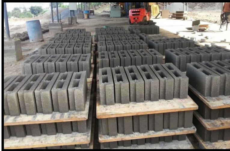
Imagen 7: Fraguado de unidades de albañilería. Fuente: (Elaboración propia 2020).
