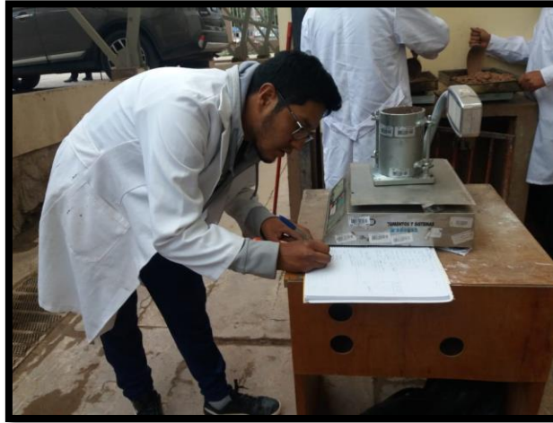
Imagen 23: Recolección de datos del ensayo de peso unitario del agregado. Fuente: (Elaboración propia 2020).
