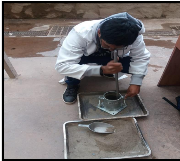
Imagen 24: Apisonado del agregado en el molde metálico. Fuente: (Elaboración propia 2020).
