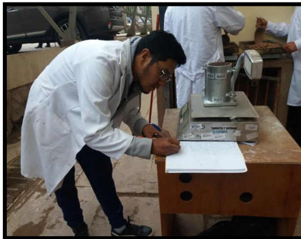
Imagen 26: Toma de datos en el ensayo de peso unitario compactado del agregado, Fuente: (Elaboración propia 2020).
