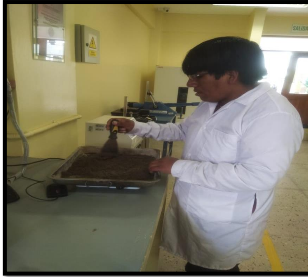
Imagen 27: Procedimiento del ensayo de densidad del agregado fino. Fuente: (Elaboración propia 2020).
