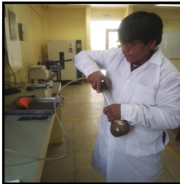
Imagen 30: Procedimiento para el ensayo de densidad del agregado fino. Fuente: (Elaboración propia 2020).
