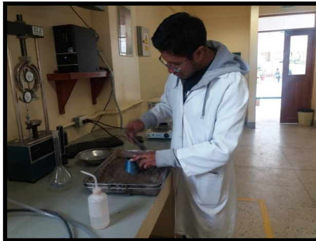
Imagen 28: Verificación de la consistencia del agregado fino con el cono de abrams. Fuente: (Elaboración propia 2020).
