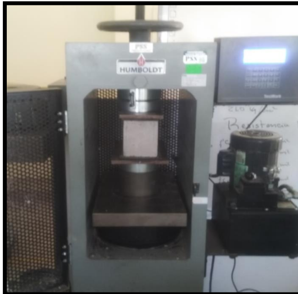
Imagen 15: Máquina de compresión para el ensayo de resistencia a la compresión. Fuente: (Elaboración propia).
