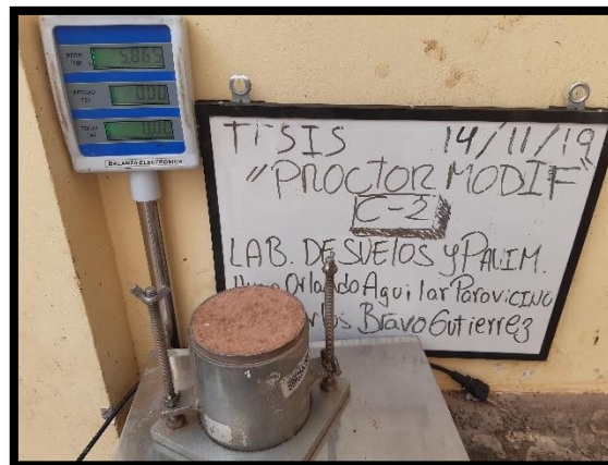
FIGURA 33 Procedimiento de Proctor Modificado 03. (Elaboración Propia).
