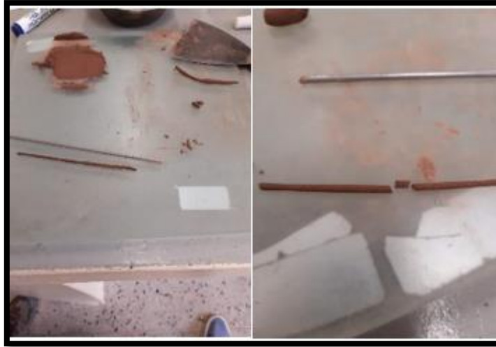
FIGURA 28 Procedimiento limite Plástico (LP) 02. (Elaboración Propia).
