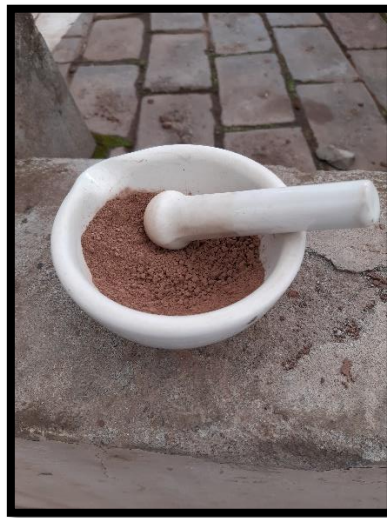
FIGURA 27 Procedimiento limite Plástico (LP) 01. (Elaboración Propia).
