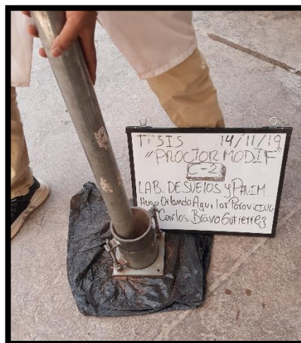
FIGURA 31 Procedimiento de Proctor Modificado 01. (Elaboración Propia).
