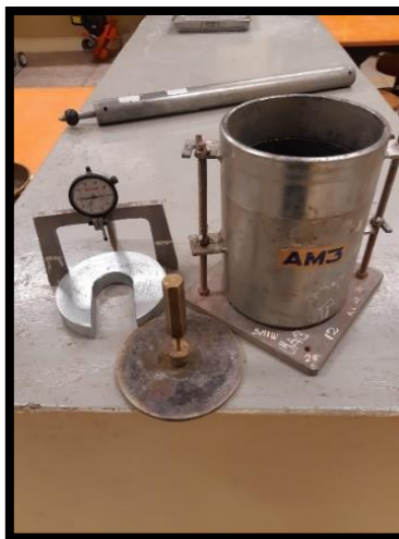
FIGURA 19 Instrumentos para ensayo de CBR de Laboratorio 01. (Elaboración Propia).
