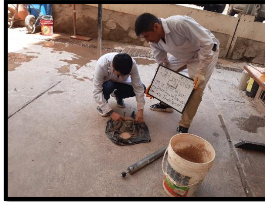
FIGURA 32 Procedimiento de Proctor Modificado 02. (Elaboración Propia).
