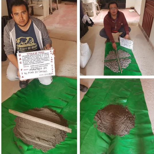
Figura 22: Muestreo por cuarteo de agregados
