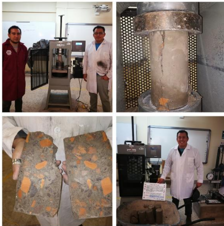
Figura 42: Resistencia a compresión de una briqueta con curado interno.
