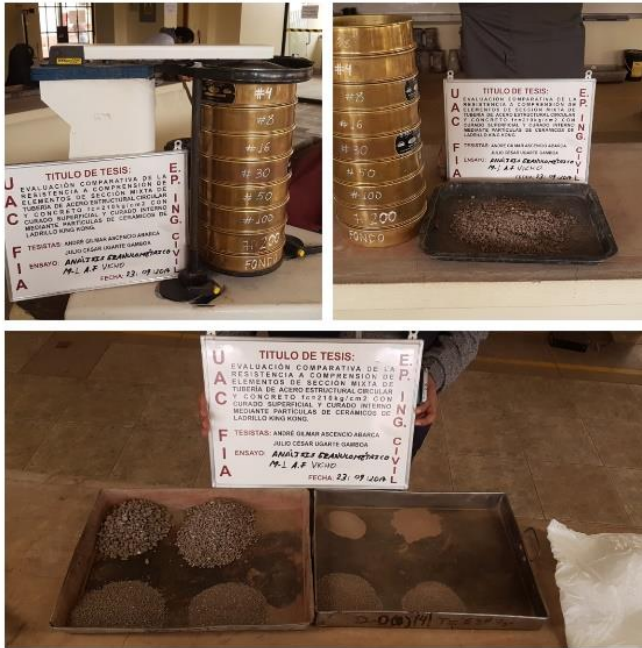
Figura 26: Proceso de tamizado del agregado fino
