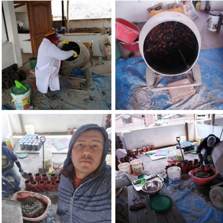
Figura 35: Preparación de mezcla según dosificación por cada diseño de mezcla de concreto y reemplazo de ladrillo King Kong.
