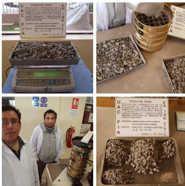
Figura 24: Proceso de tamizado del agregado grueso
