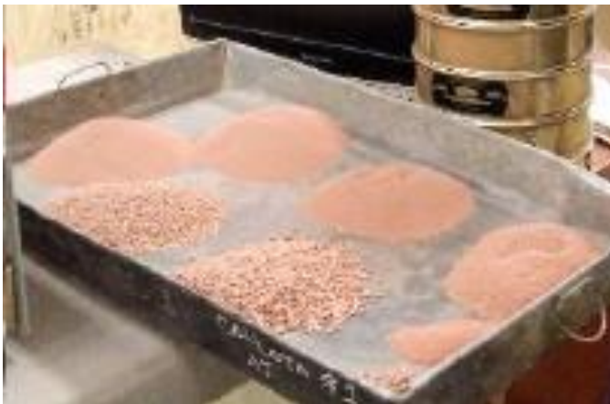
Figura 27: Tamizado del agregado fino del ladrillo King Kong.
