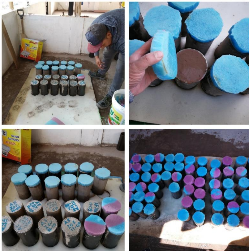
Figura 40: Curado de las probetas de concreto patrón.
