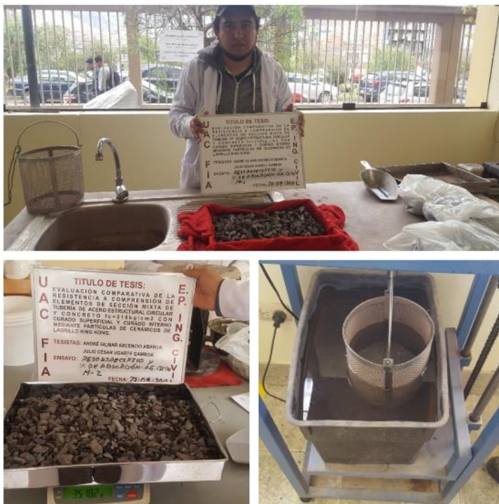
Figura 30: Ensayo de peso específico y porcentaje de absorción del agregado grueso
