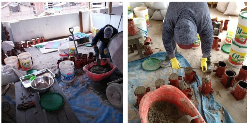
Figura 37: Vaciado y enrasado del concreto.
