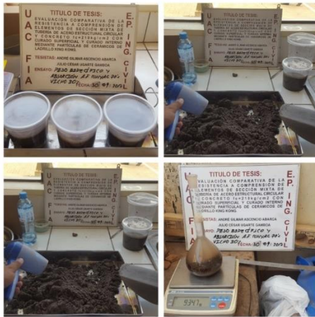
Figura 28: Ensayo de peso específico y porcentaje de absorción del agregado fino
