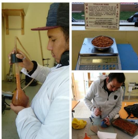
Figura 29: Ensayo de peso específico y porcentaje de absorción del ladrillo King Kong fino
