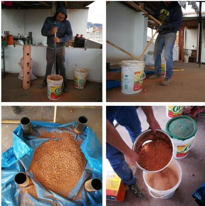
Figura 33: Procedimiento para el triturado y gradación del ladrillo King Kong
