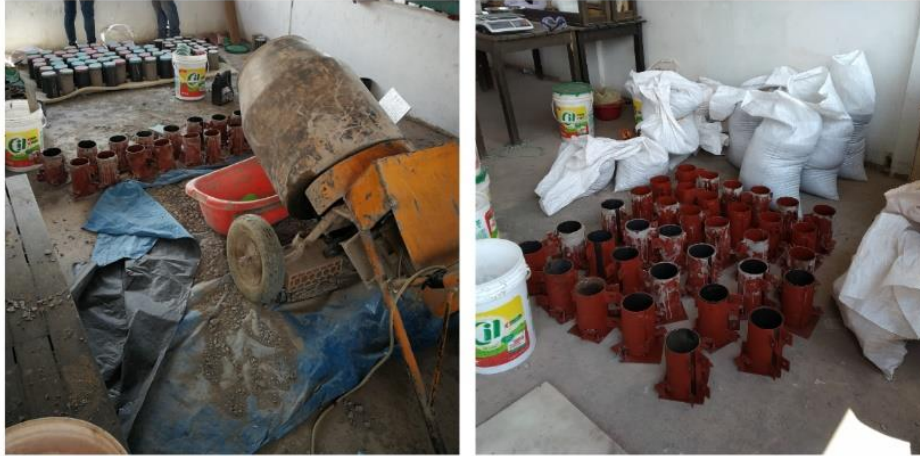
Figura 38: Secciones de acero para el vaciado.
