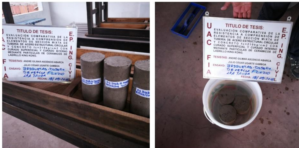
Figura 39: Curado de las probetas de concreto patrón.
