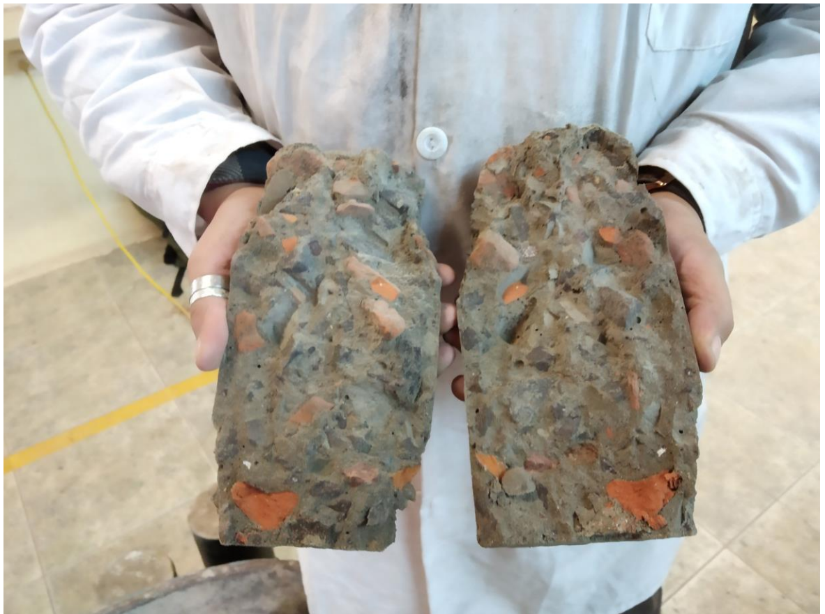
Figura 3: Concreto con reemplazo de agregado pétreo por partículas de cerámico de ladrillo king kong.
