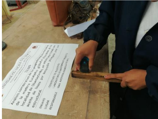
Figura 29: Contenido de humedad usando el higrómetro Fuente: Elaboración propia
