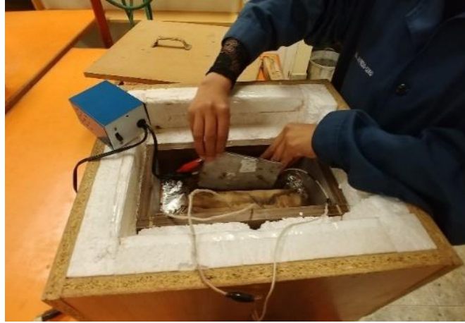
Figura 37: Colocado de la placa caliente con la resistencia eléctrica Fuente: Elaboración propia
