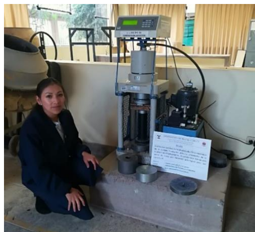
Figura 44: Aplicación de carga sobre la muestra hasta su falla por compresión perpendicular al grano.
