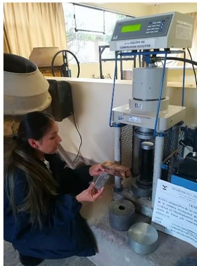
Figura 43: Colocado de la muestra en posición horizontal dentro del equipo
