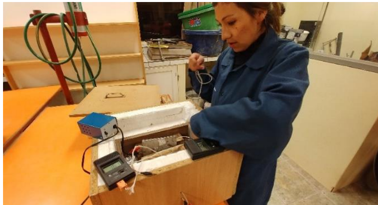
Figura 38: Colocado de la placa caliente con la resistencia eléctrica Fuente: Elaboración propia
