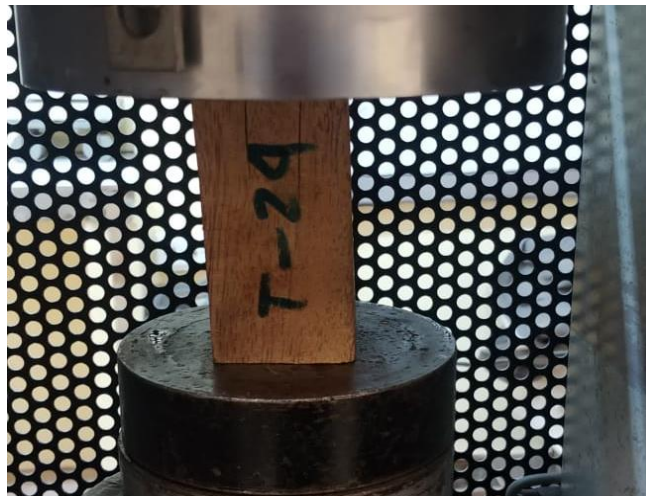
Figura 423: Verificación de la falla a compresión paralela de la probeta luego del ensayo. Fuente: Elaboración propia
