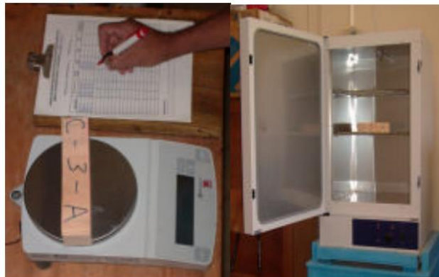
Figura 11. Ensayo de contenido de humedad por diferencia de peso. Fuente: Kuru – Revista forestal.
