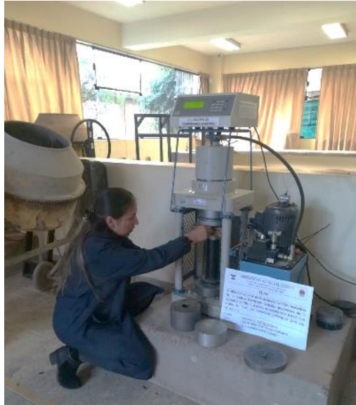
Figura 40: Colocación del deformímetro en el cuerpo del equipo a compresión.
