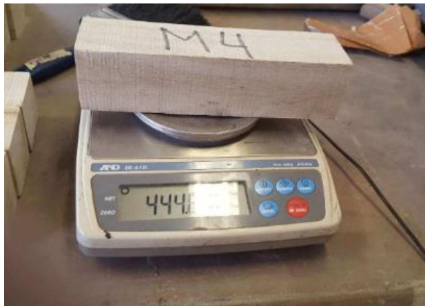
Figura 28: Pesado de muestras luego del horno Fuente: Elaboración propia
