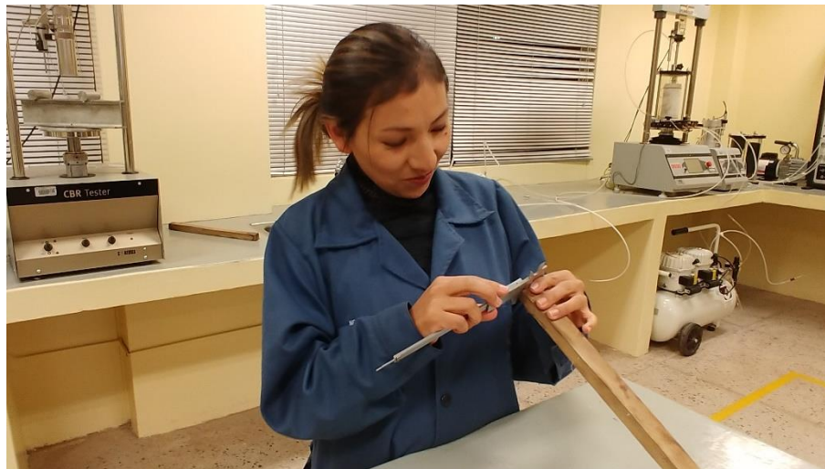
Figura 50: Registro de las medidas de probetas sometidas a ensayo a flexión
