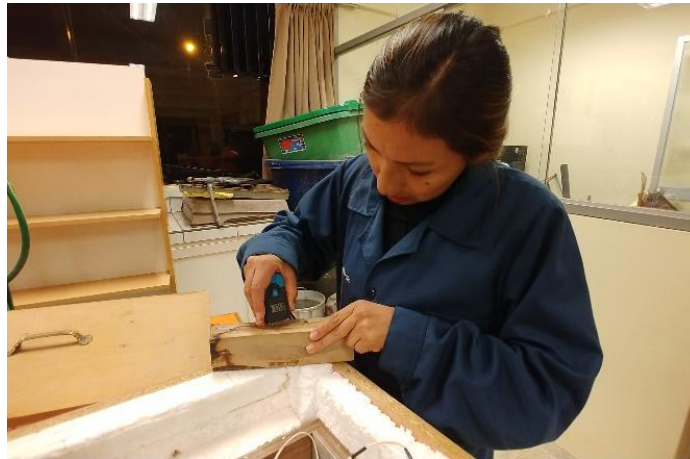
Figura 35: Medida de las dimensiones de la muestra
