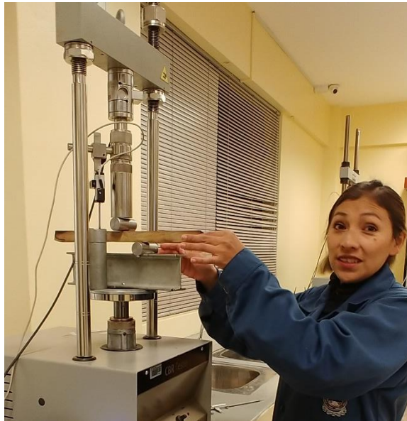
Figura 52: Toma de datos de las lecturas de la deformación y de la carga Fuente: Elaboración propia
