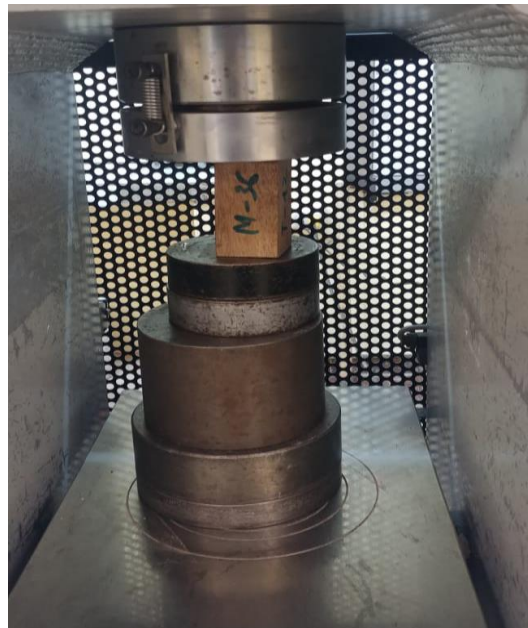
Figura 401: Colocación del deformímetro en el cuerpo del equipo a compresión.
