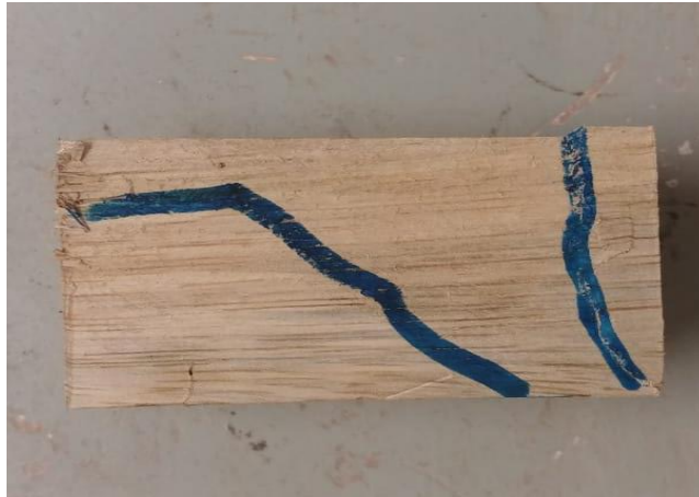
Figura 45: Muestra de la falla compresión perpendicular al grano. Fuente: Elaboración propia.
