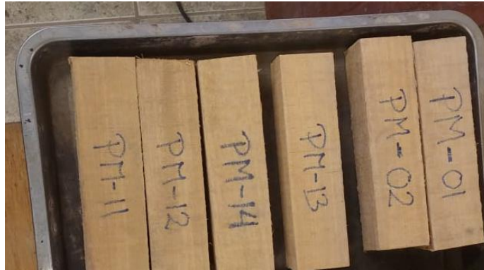
Figura 25: Muestras sumergidas en aceite de linaza por 48 horas Fuente: Elaboración propia
