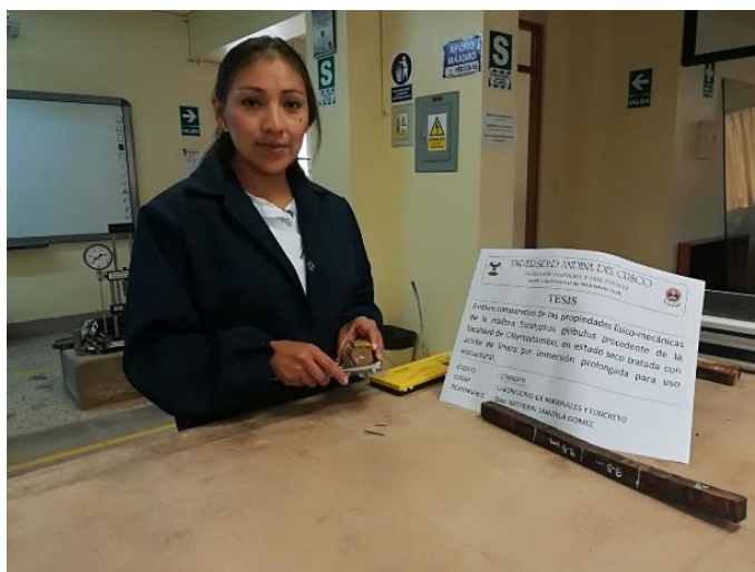
Figura 31: Medida de las dimensiones de la probeta con Vernier Fuente: Elaboración propia
