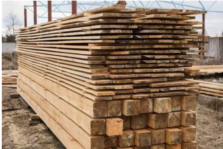
Figura 5. Secado de madera al aire
