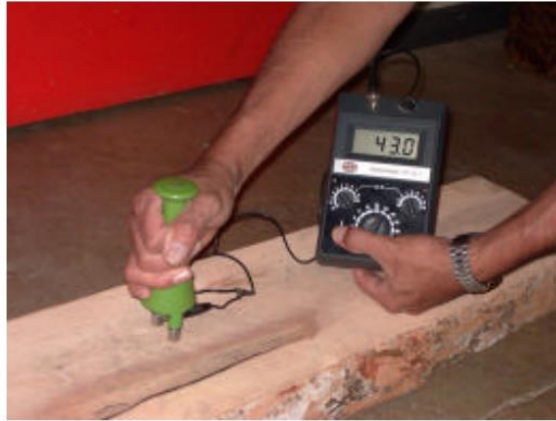
Figura 12. Ensayo de contenido de humedad por el método del higrómetro. Fuente: Kuru – Revista forestal.
