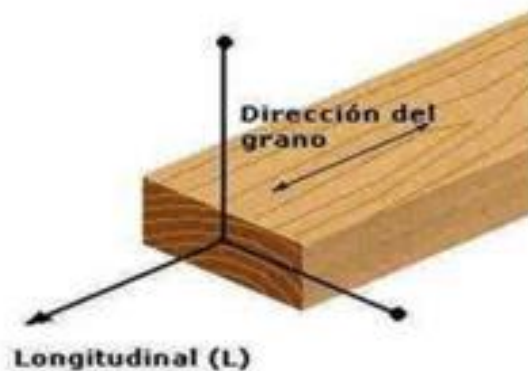
Figura 9. Eje longitudinal en una pieza de madera Fuentes: Manual de construcción viviendas en madera - Corma.
