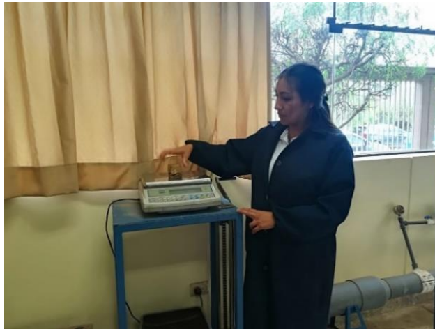
Figura 30: Pesado de las probetas con ayuda de la balanza de precisión Fuente: Elaboración propia
