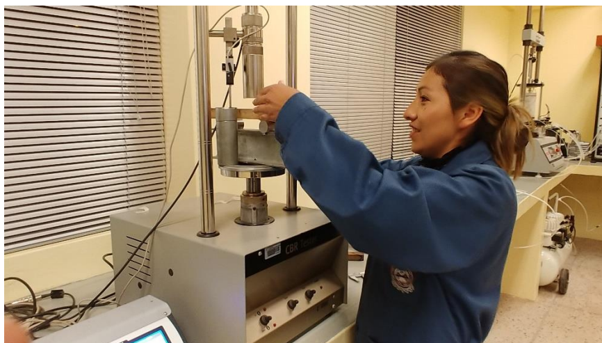
Figura 51: Colocado de la muestra en el equipo de CBR considerando la distancia de apoyos según norma.
