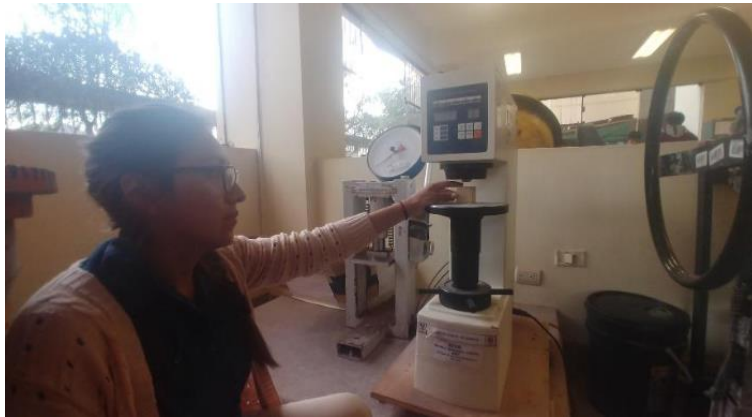
Figura 32: Colocado de la muestra dentro del equipo de dureza Brinell
