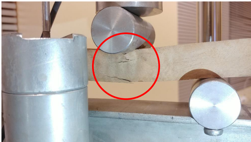
Figura 53: Verificación de la falla por flexión estática de las muestras Fuente: Elaboración propia
