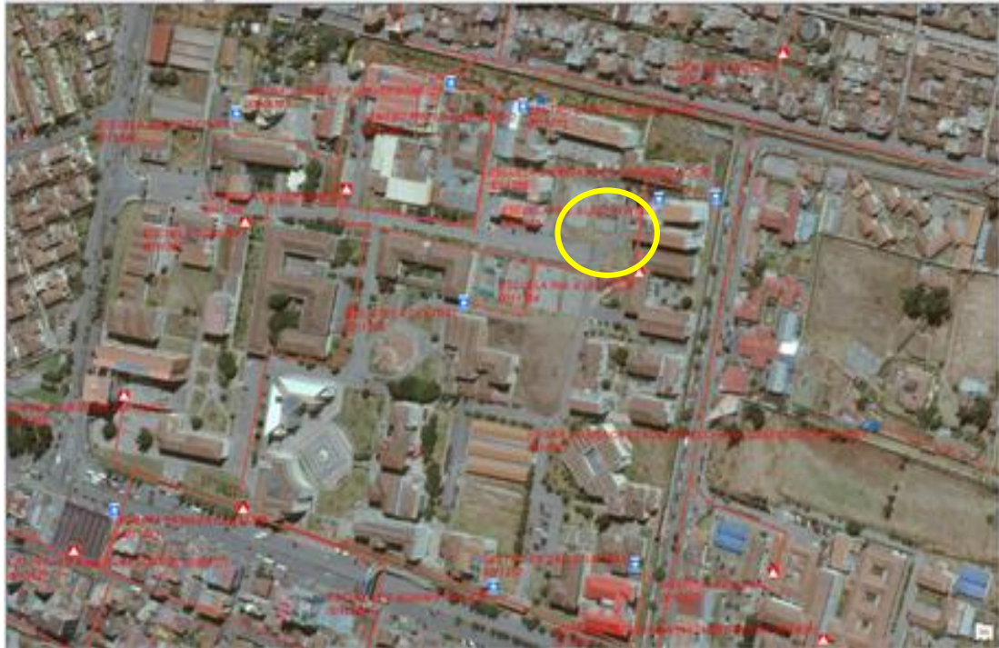
Figura 26. Vista aérea de la red de media tensión UNSAAC Fuente: GIS (2019)
